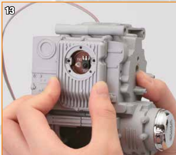
Assemblez les saillants du carter d'huile dans les orifices sous le carter.
