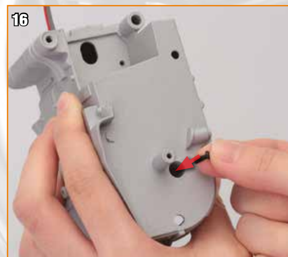
Insérez une vis dans l'orifice plus large sur le côté de la moitié gauche du carter.
