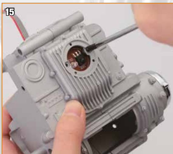
Serrez la vis une fois en place, mais arrêtez-vous lorsque vous ressentez une résistance. Si vous serriez trop vous pourriez endommager la vis ou bien l'orifice. Recommencez l'opération pour l'orifice du côté opposé de la fenêtre.
