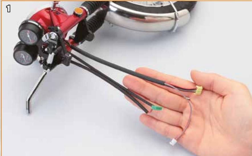
Placez la fourche avant sur le côté et tenez les câbles par derrière, comme sur l'image. Le connecteur blanc est à deux goupilles, alors que les connecteurs vert et jaune sont à quatre goupilles.
