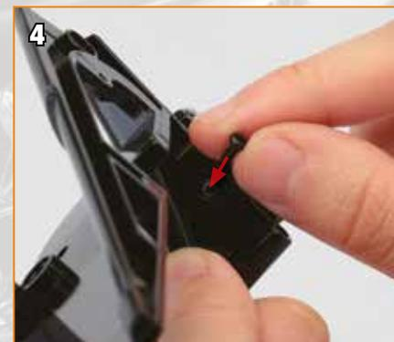
Passez une vis G à travers les orifices alignés du cadre et du klaxon.
