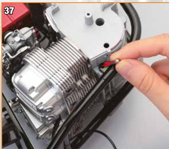
Passez la vis Q à travers les orifices à l'avant du carter.
