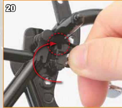
Faites tourner l'extrémité en U du boîtier de connexion afin qu'elle corresponde à l'orifice du cadre.
