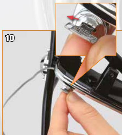
10 Introduisez la clé de démarrage dans l'interrupteur de démarrage en disposant l'orifice vers l'avant, comme sur l'agrandissement ci-dessus.
