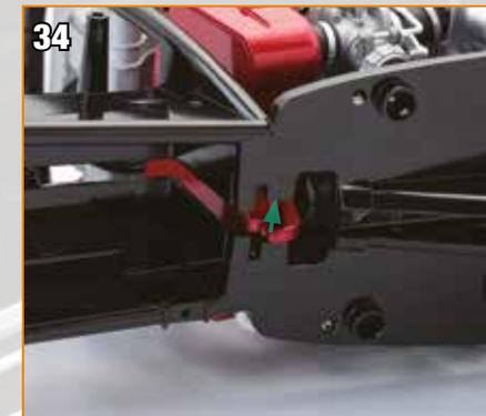
34 Disposez l'orifice sur la partie supérieure du cadre gauche, au-dessus du saillant du filtre à air, comme sur l'image. Alignez ensuite les deux orifices du cadre et ceux du carter, à l'avant et à l'arrière.
