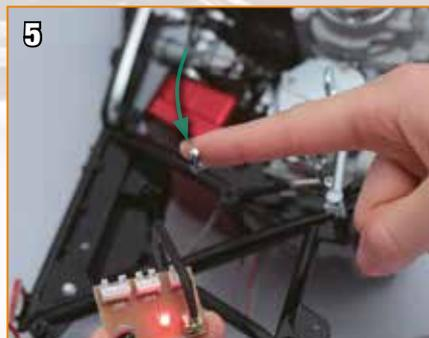
Modifiez le contact en appuyant vers l'extérieur. Le voyant LED devrait alors s'allumer. Si ce n'est pas le cas, vérifiez que la goupille entre correctement en contact avec l'interrupteur. Si le contact a lieu mais que le voyant ne s'allume pas, il se peut que le câble soit endommagé.
