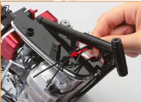
Prenez les extrémités des câbles A et B, ainsi que celles des deux câbles de l'étape 47, et passez-les dans le creux du cadre.
