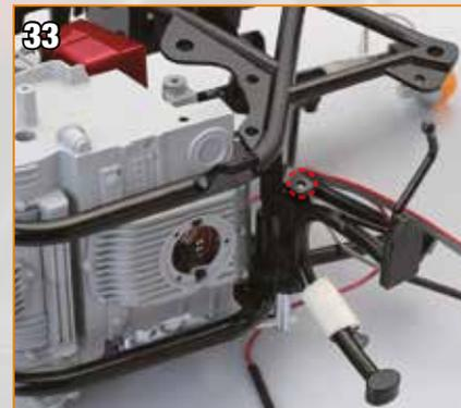
33 Disposez l'orifice circulaire du cadre gauche sur le saillant sur le côté du support central.
