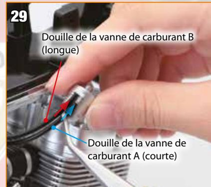
29 Appuyez sur les extrémités des vannes afin de les faire passer par les saillants des vannes à carburant.
