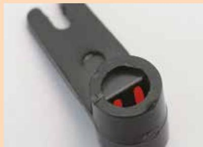
À l'intérieur de l'orifice de l'arbre du frein arrière, deux pièces rendent l'assemblage plus aisé. Évitez de les déformer.
