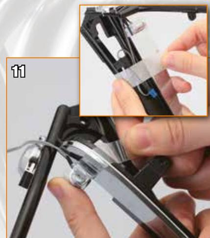
11 Afin d'éviter d'égarer la clé, fixez-la temporairement une fois en place avec du ruban cache. Collez de la même manière les câbles de l'interrupteur de démarrage sur le cadre, avec un morceau de ruban cache.
