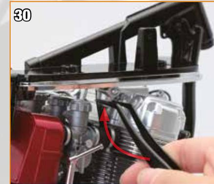
30 Réinstallez la vanne dans son emplacement, sous le réservoir.
