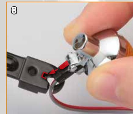
Alignez le saillant carré du bord avant du clignotant et l'encoche correspondante sur le cadre.
