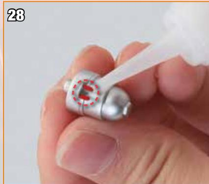
28 Déposez un peu de colle instantanée sur les saillants cerclés sur la vanne à carburant.
