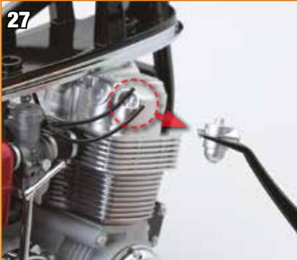
27 Avec la pince retirez la vanne de carburant du réservoir et tirez les deux douilles de la vanne vers la droite du moteur.
