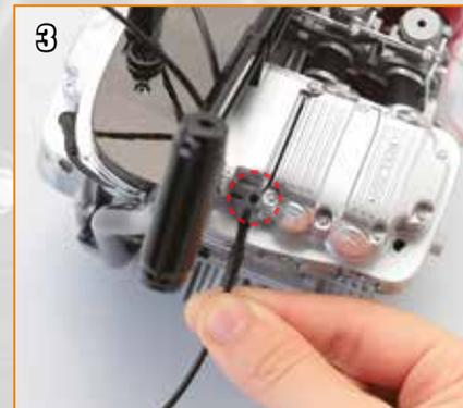
Prenez la moitié droite du cadre et repérez l'orifice sous la ventilation (cerclé) du moteur. Alignez devant cet orifice l'extrémité du câble B.
