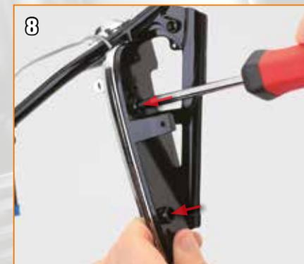
8 Serrez la vis une fois en place. Recommencez afin de serrer la deuxième vis G dans l'orifice proche de l'arrière du cadre. Cela fixera le réservoir.
