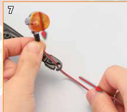
Gardez le câble dans l'orifice et tirez afin de rapprocher le clignotant de la structure du cadre.
