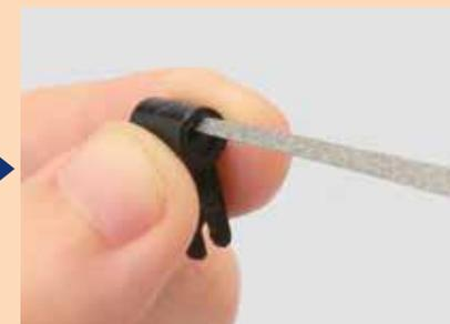
Réduisez l'épaisseur de la surface de l'autre côté de l'orifice, avec votre lime.
