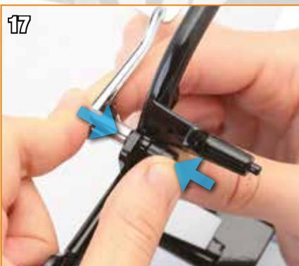
17 Appuyez sur le frein arrière à travers l'arbre afin d'assembler définitivement les deux pièces.
