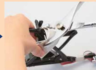
Lorsque vous assemblerez l'arbre et la pédale, enveloppez les deux pièces dans du buvard et serrez bien avec une pince. Si l'opération est encore difficile, réduisez davantage l'épaisseur de l'orifice.
