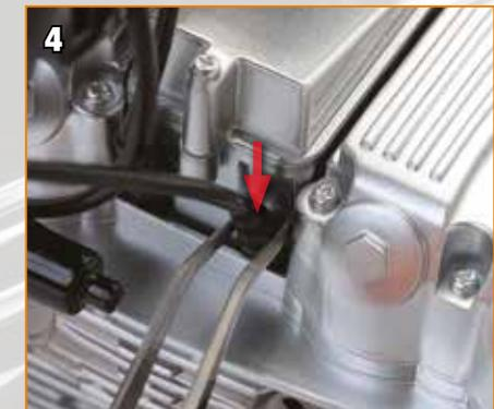
Passez le bout du câble B dans l'orifice.
