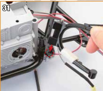
31 Faites tourner le cadre et disposez le saillant sur le côté du support central à l'intérieur de l'orifice circulaire.
