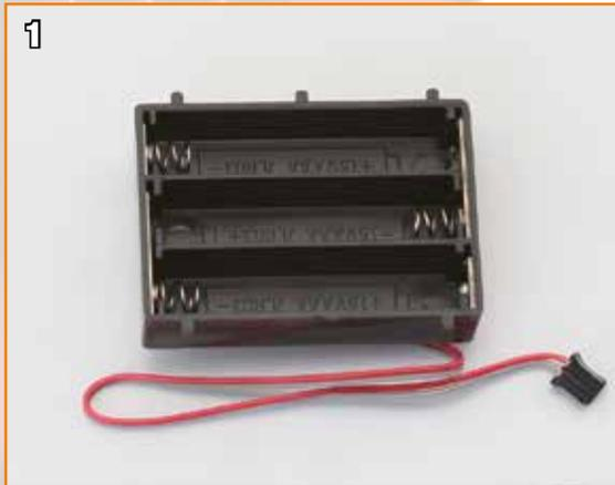
1 À l'intérieur du boîtier d'alimentation (étape 52) vous trouverez des indications pour disposer correctement les piles.
