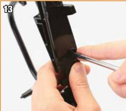
13 Serrez la deuxième vis G dans l'orifice proche de l'arrière du cadre.
