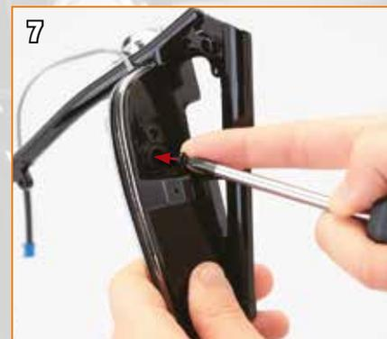
7 Introduisez la première vis G dans l'orifice le plus large, à l'avant du cadre.
