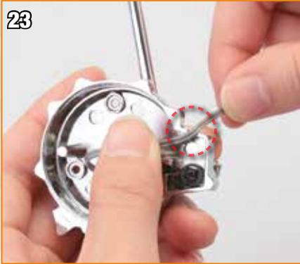
Posez le câble du couvercle d'embrayage au-dessus de la fente dans l'orifice du côté du boîtier.
