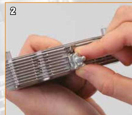
Insérez le support du tenseur dans les cylindres.
