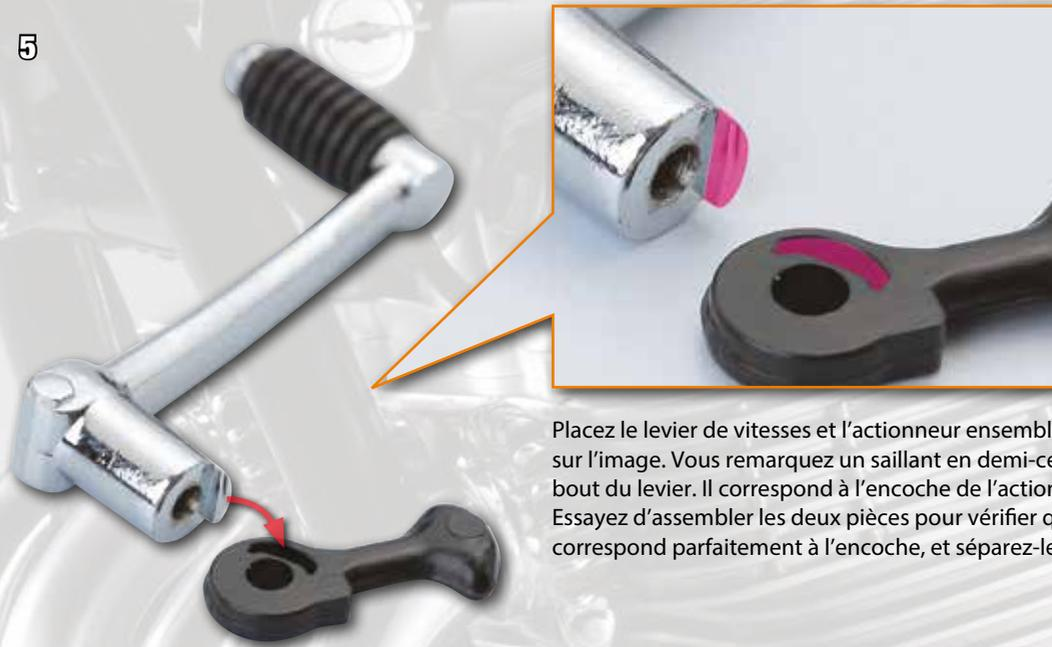
Placez le levier de vitesses et l'actionneur ensemble, comme sur l'image. Vous remarquerez un saillant en demi-cercle au bout du levier. Il correspond à l'encoche de l'actionneur. Essayez d'assembler les deux pièces pour vérifier que le saillant correspond parfaitement à l'encoche, et séparez-les à nouveau.
