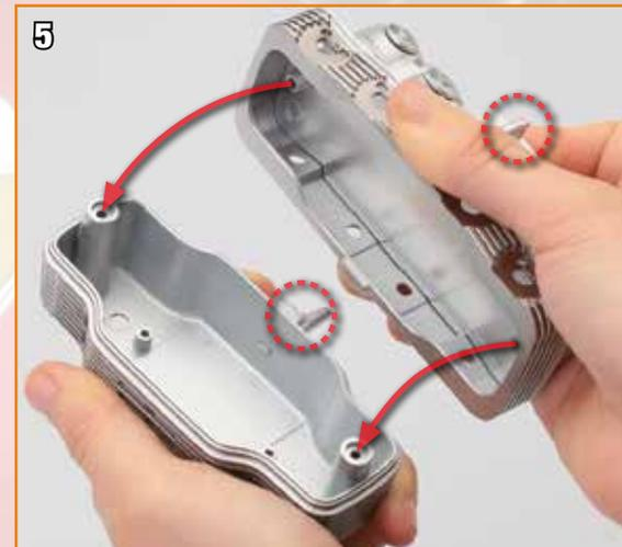
Tenez l'assemblage de la culasse en tournant vers vous le renifleur (cercle à droite). Les cylindres et le support du tenseur (cercle au centre) sont tournés vers le bas. Alignez les orifices de part et d'autre des flèches.
