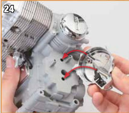
Alignez les deux saillants à l'intérieur du boîtier d'embrayage et les deux orifices correspondants sur le côté du moteur.
