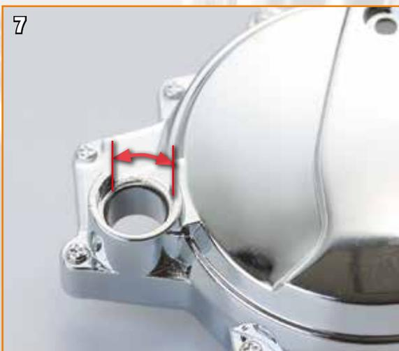
7 Repérez l'orifice sur le côté du boîtier d'embrayage et le rebord autour de l'orifice.
