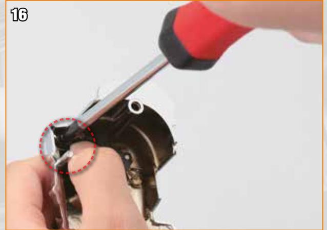
Tenez l'actionneur et le levier en place et serrez la vis.
