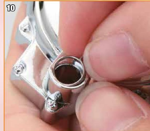
10 Actionnez le ressort jusqu'à ce que le saillant le plus petit soit dans l'orifice, contre l'extrémité de la paroi de la pièce.
