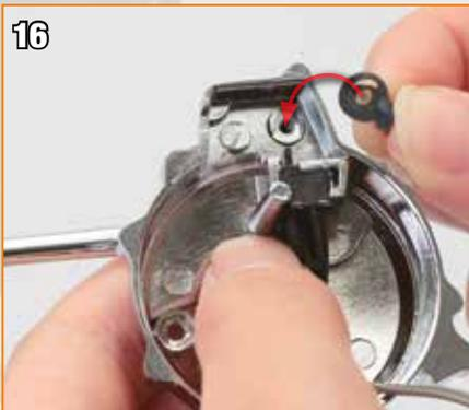
Faites tourner le boîtier d'embrayage tout en tenant la pédale de démarrage en place. Prenez le levier d'embrayage et alignez son orifice et celui de l'extrémité de la pédale de démarrage.
