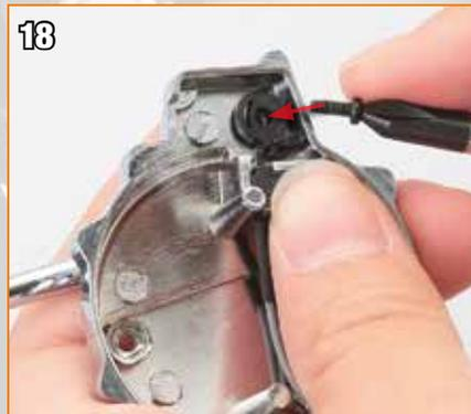
Passez une vis de type B à travers le levier et dans l'orifice de la pédale de démarrage.
