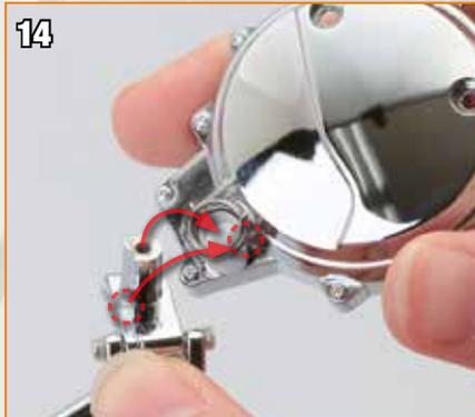
Alignez l'assemblage de la pédale de démarrage et l'orifice du boîtier d'embrayage, comme sur l'image. Le saillant identifié dans le pas précédent doit se trouver derrière l'extrémité supérieure du ressort de la pédale de démarrage.
