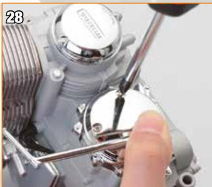
Serrez une deuxième vis de type M dans l'orifice sur le côté du couvercle d'embrayage.
