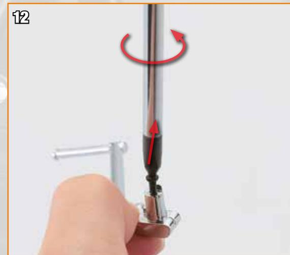
12 Retirez la vis utilisée pour creuser un orifice dans la pédale de démarrage, si cela n'a pas été fait auparavant.
