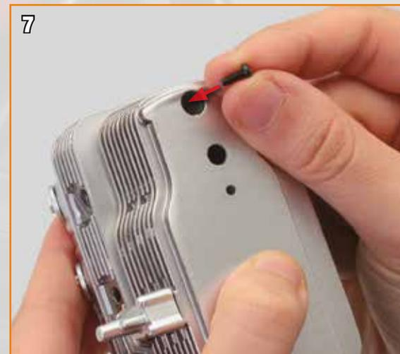
Tenez l'assemblage et insérez une vis de type E dans l'orifice sous les cylindres.
