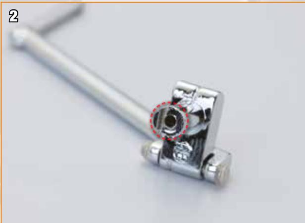
Repérez l'orifice à l'arrière du joint de la pédale de démarrage (cerclé).
