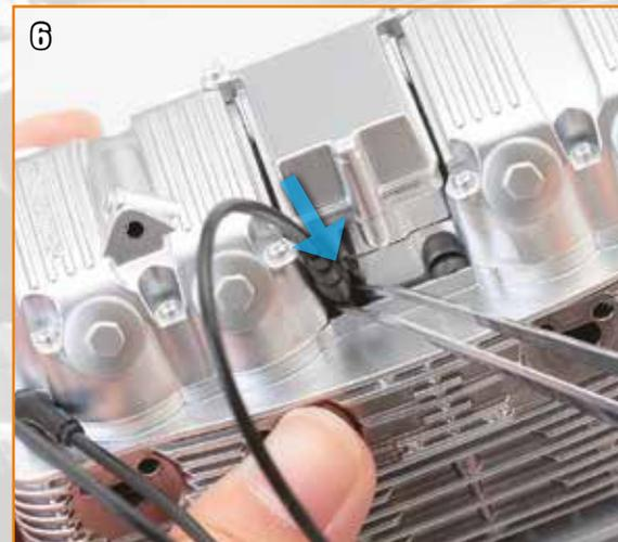
6 Insérez l'extrémité du câble B dans l'orifice. Avec une pince cela peut être plus facile. Vous pouvez ajouter une goutte de colle si le câble ne tient pas fermement.
