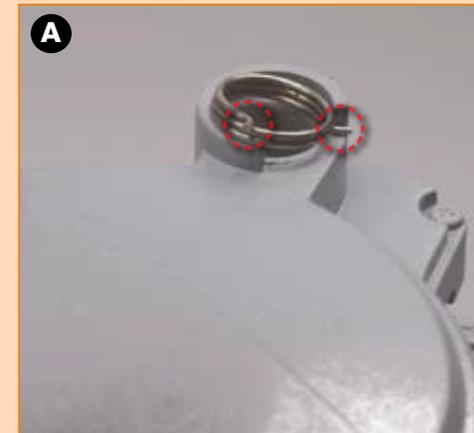
Vérifiez que le ressort est placé dans l'orifice sur le côté du boîtier d'embrayage, comme sur l'image. L'extrémité inférieure du ressort doit être contre l'extrémité de la paroi de l'orifice, et l'extrémité supérieure doit être sur la partie supérieure de la paroi.
