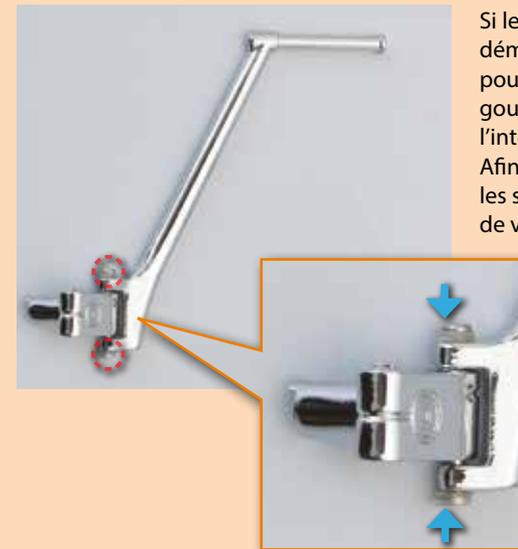
Si le bras de la pédale de démarrage bouge trop vous pouvez alors tourner les deux goupilles (flèches bleues) vers l'intérieur avec une pince. Afin d'éviter d'endommager les saillants, recouvrez le bout de votre pince dans du ruban cache avant de serrer les boulons.
