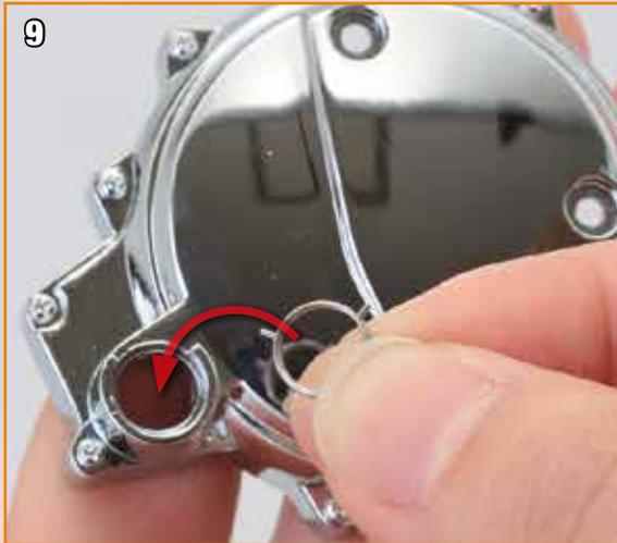
9 Placez le ressort dans l'orifice sur le côté du boîtier d'embrayage.
