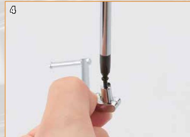
Serrez à moitié la vis de type B afin d'ouvrir l'orifice dans le joint.
