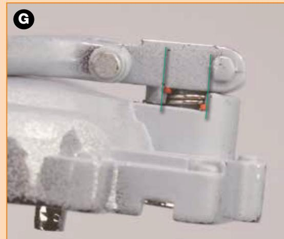
Enfoncez la partie saillante du joint de la pédale de démarrage dans la partie haute du boîtier d'embrayage. Les deux extrémités du ressort doivent se trouver des deux côtés de l'orifice.
