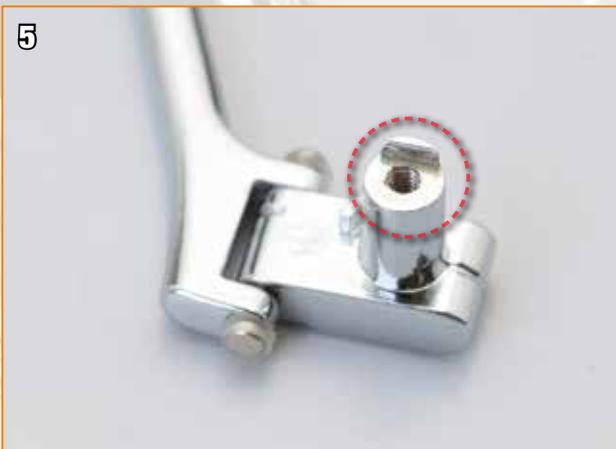
L'orifice du joint de la pédale de démarrage est prêt.
