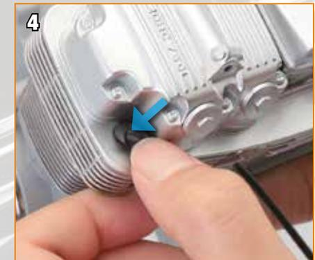
Insérez l'extrémité du câble A dans l'orifice du couvre culasse. Vous pouvez ajouter une goutte de colle si le câble ne tient pas fermement.
