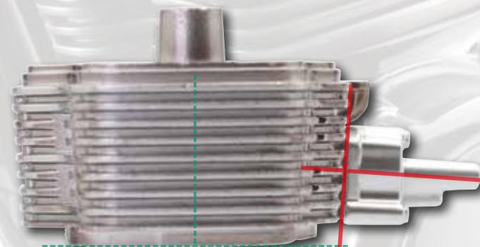
Le support du tenseur doit être légèrement en biais sur les supports. Cela est visible en vue latérale.
