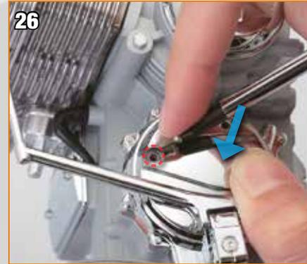
Insérez une vis de type B dans l'orifice sur le couvercle d'embrayage, comme sur l'image.
