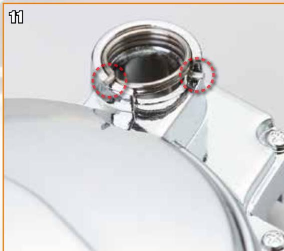
11 Le ressort devrait alors présenter cet aspect. L'extrémité inférieure est dans l'orifice et contre l'extrémité de la paroi. L'extrémité supérieure repose sur la partie supérieure de la paroi de la pièce.
