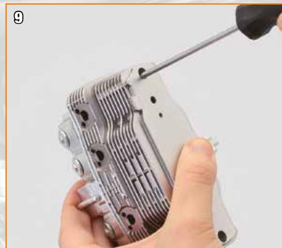
9 Serrez une deuxième vis de type E une fois en place à l'autre extrémité des cylindres.
