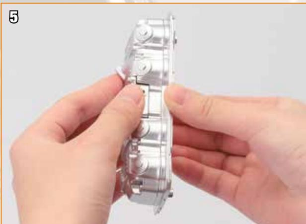
Assemblez les deux parties en insérant les saillants du couvre culasse dans les orifices de la partie supérieure (voir flèches de l'étape 4).
