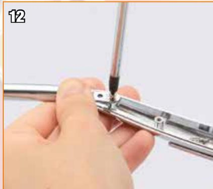
Serrez la vis de type P à cet endroit afin de fixer le pot d'échappement à l'extérieur du silencieux.
