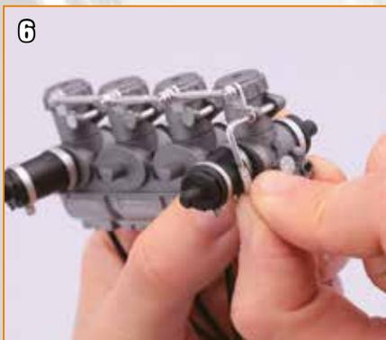
Lorsque l'isolant B est installé, remettez en place le levier.
