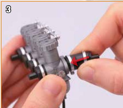
Placez l'isolant A dans le saillant.
