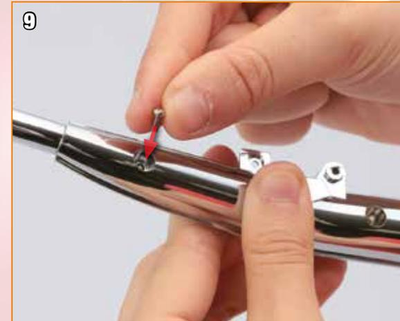
Tenez les deux moitiés du silencieux et insérez une vis P dans le trou le plus proche du pot d'échappement.
