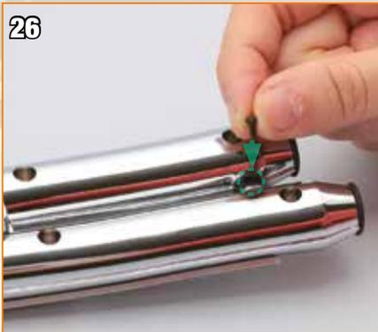
Placez une vis B dans l'alignement des trous au bout des silencieux.
