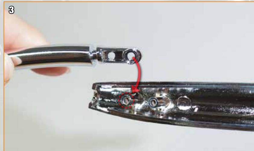
Alignez le trou au bout du pot d'échappement et celui indiqué par un cercle sur l'extérieur du silencieux inférieur droit.
