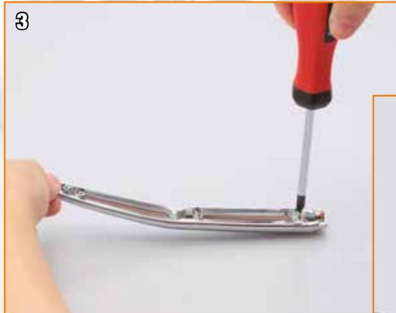
Utilisez un foret de 2,3 mm ou une vis de type P (2,3 x 5 mm) pour tailler le pas de vis dans les quatre saillants à l'intérieur du silencieux.
