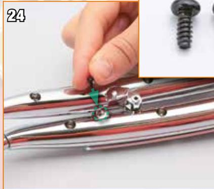
Placez une vis de type G dans le trou cerclé en vert. Attention : les types B et G se ressemblent beaucoup mais la vis G est autoforeuse, tandis que la vis B est faite pour les métaux (voir encadrement).
