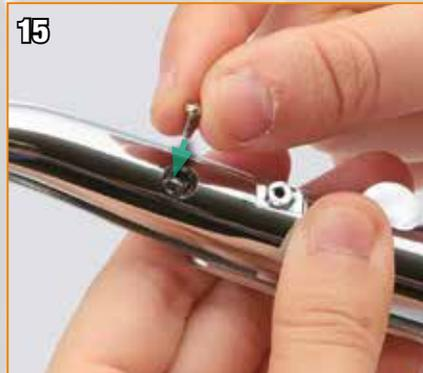
Tenez unies les deux moitiés du silencieux et insérez une vis de type P dans le trou le plus proche du pot d'échappement.
