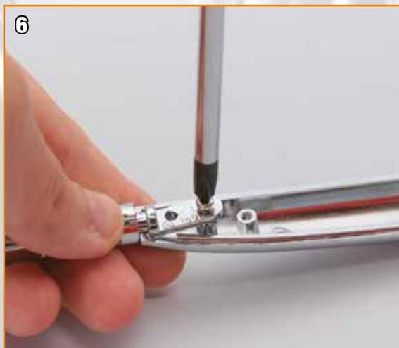
Serrez la vis P à cet endroit afin de fixer le pot d'échappement et le silencieux extérieur.
