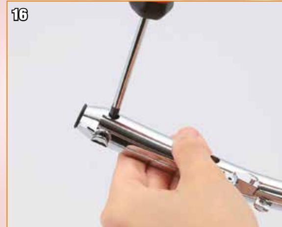
Serrez la vis de l'extrémité du silencieux. Si vous avez desserré la vis du milieu, resserrez-la.
