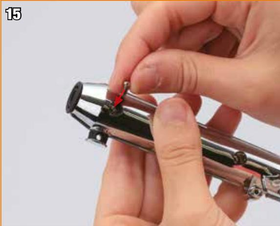
Insérez une vis P dans le trou au bout du silencieux.
