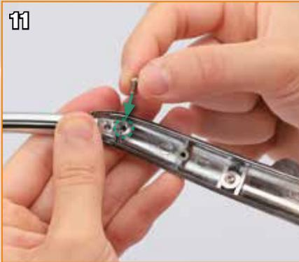
Insérez une vis de type P dans les trous alignés.
