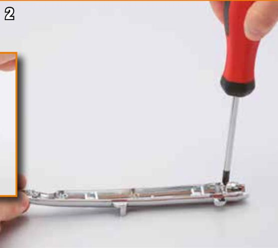
À l'aide d'une vis P taillez le pas de vis dans les quatre trous à l'intérieur du silencieux extérieur. Cela vous sera plus facile avec un foret de 2,3 mm (image ci-dessus).
