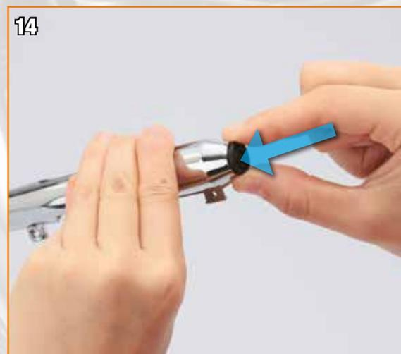
14 Alignez le saillant et la rainure et placez le diffuseur à l'extrémité du silencieux. Desserrez un peu la vis du milieu si elle vous gêne.
