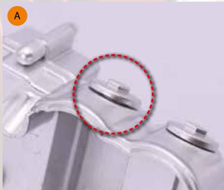
Si l'une des douilles du poussoir installées maintenant ou lors de l'étape 7 n'est pas complètement entrée dans la tête du cylindre (voir ci-dessus), essayez les méthodes suivantes.
