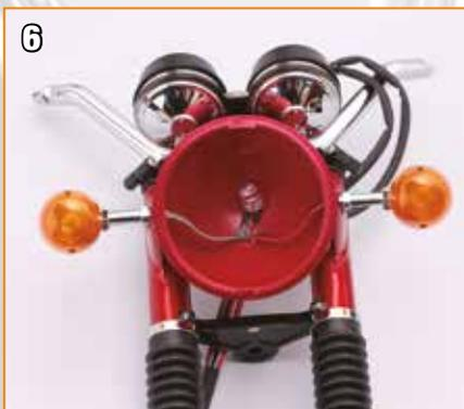
6 Le câblage dans le couvercle du phare devrait ressembler à ceci. Le LED doit être à peu près 5 mm au dessus du trou, et il doit rester un peu de marge sur les câbles des indicateurs.
