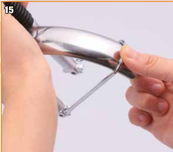
15 Insérez les saillants du support dans les trous du garde-boue. Faites-en autant pour l'autre support du garde-boue.
