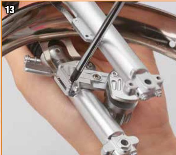
13 Serrez une vis de type U dans son trou de l'arrière de la pince pour le fixer sur la fourche.
