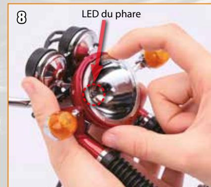
8 Tenez le réflecteur du phare en plaçant la fente la plus large vers le haut et assemblez-le dans le couvercle en vérifiant que le LED ressort par le trou central (cercle).
