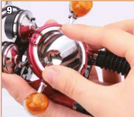
Placez délicatement le réflecteur sur le couvercle en alignant l'encoche du réflecteur et le saillant qui correspond sur le caisson du phare.
