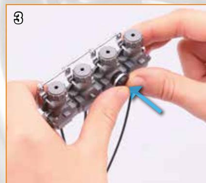
Assemblez un des tuyaux de connexion sur l'un des deux saillants du corps de l'accélérateur.
