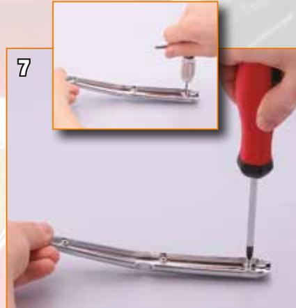
Aidez-vous des vis de type P (2,3 x 5 mm) pour tailler les pas de vis dans les quatre saillants à l'intérieur du silencieux.
