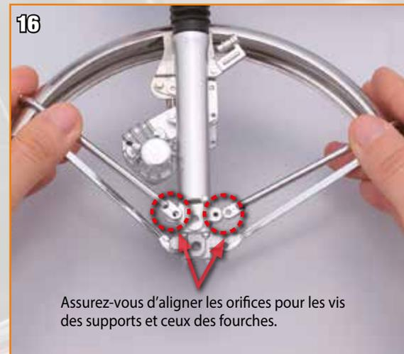
16 Assurez-vous d'aligner les orifices pour les vis des supports et ceux des fourches.
