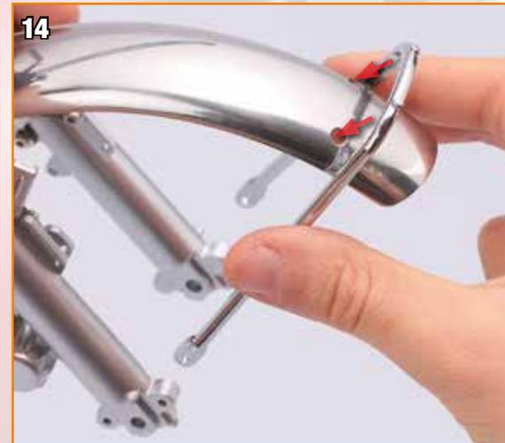
14 Placez l'un des supports du garde-boue sur l'arrière du garde-boue et alignez les deux saillants et les deux orifices (flèche).
