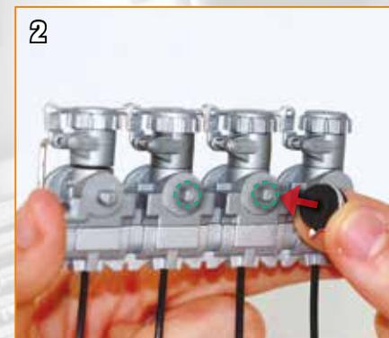
Repérez des saillants en demi cercle sur les deux corps de l'accélérateur, cerclés de vert ci-dessus. Les trous au milieu des tuyaux de connexion viennent s'ajuster sur ces saillants.
