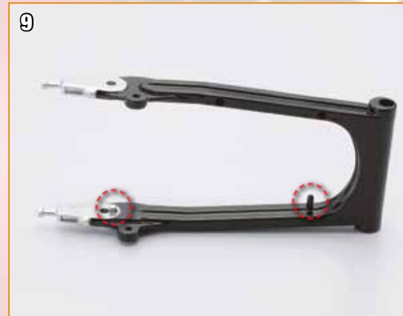
Placez le bras basculant comme sur l'image. Cherchez les deux saillants cerclés sur le côté droit du basculant.
