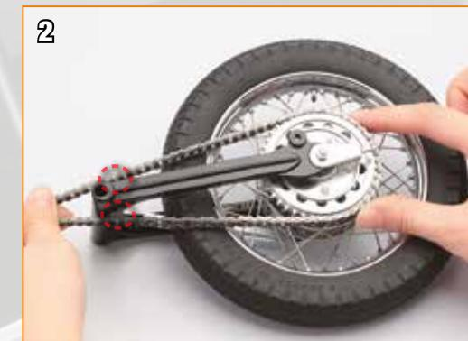
Afin d'éviter que la chaîne de transmission ne déraille, tenez-la sur le pignon et tirez sur l'autre côté de la chaîne jusqu'à l'extrémité avant de la fourche arrière (cerclée).
