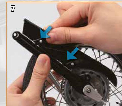
Insérez les saillants de la fourche arrière dans les orifices de la protection de la chaîne.
