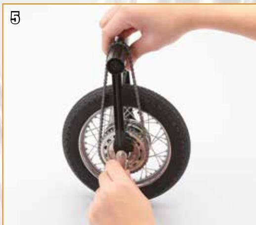
Tenez fermement le cylindre et l'avant du bras basculant. Faites tourner la roue arrière afin de vérifier qu'elle tourne correctement sur le pignon.
