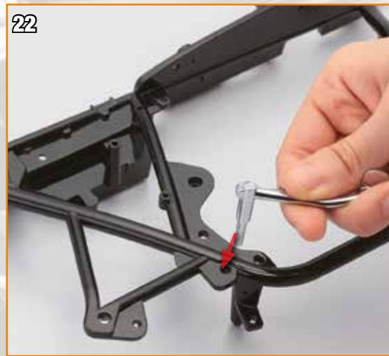
Placez la moitié droite du cadre (fournie dans l'étape 32) sur le plan de travail, comme sur l'image. Introduisez le bras de la pédale du frein arrière dans l'orifice indiqué.
