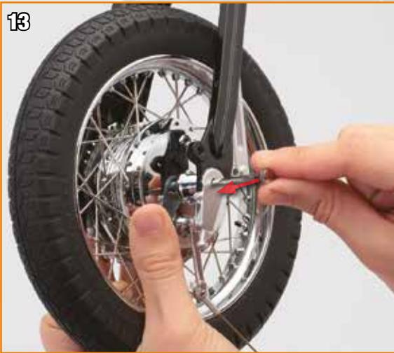
Insérez le moyeu arrière à travers le bras basculant et la roue arrière.
