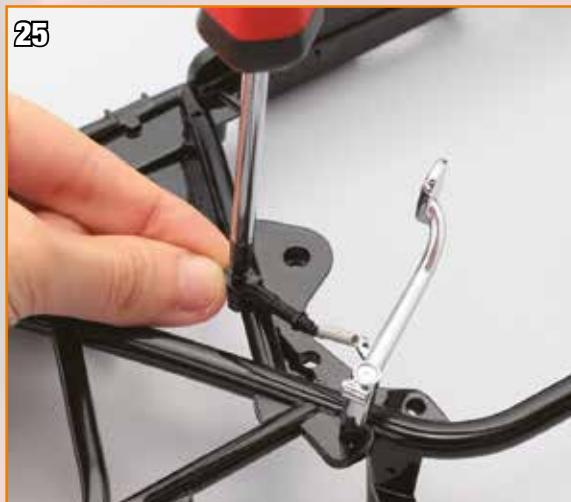
Insérez une vis de type B entre le support du ressort et le cadre. Le ressort doit être assez resserré pour éviter que le support tourne.
