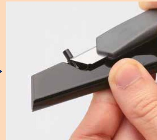
Coupez très soigneusement les bavures des saillants et tentez d'assembler à nouveau la protection. Répétez autant de fois que nécessaire jusqu'à ce que les pièces soient parfaitement en contact.
