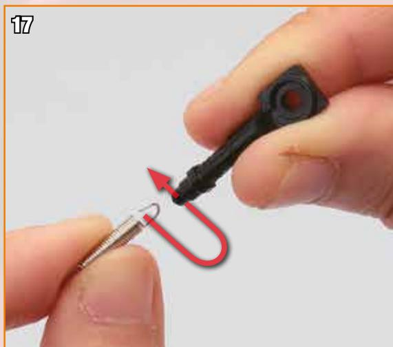
Alignez une extrémité du ressort de la pédale du frein et l'orifice sur l'extrémité la plus étroite du support du ressort.
