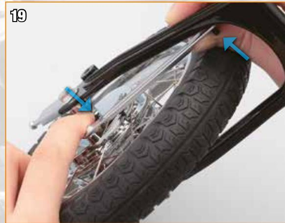
Insérez le saillant de l'autre extrémité du bras de butée du frein arrière dans l'orifice du disque du frein.
