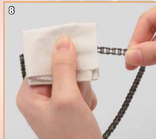
Pliez le mouchoir et tirez soigneusement sur la chaîne à l'intérieur du mouchoir afin de nettoyer l'excès de graisse.
