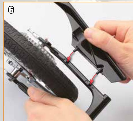
Repérez les deux orifices sur le haut de la fourche arrière et alignez les deux saillants sous la protection de la chaîne devant eux.
