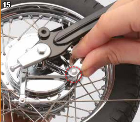
Insérez l'extrémité du bras de butée arrière à nouveau dans l'orifice du disque du frein.
