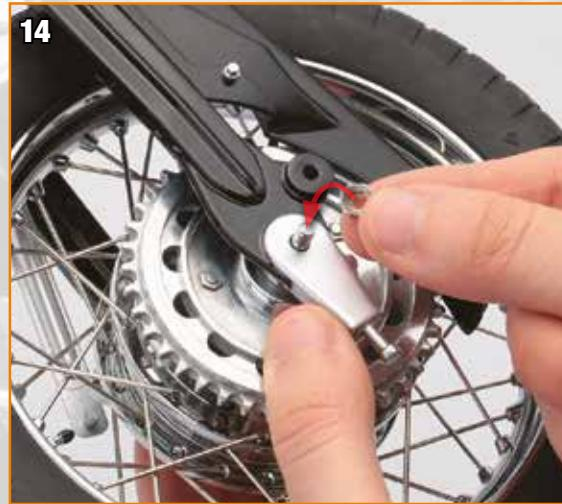
Vissez à nouveau l'écrou à l'extrémité du moyeu arrière avec vos doigts.
