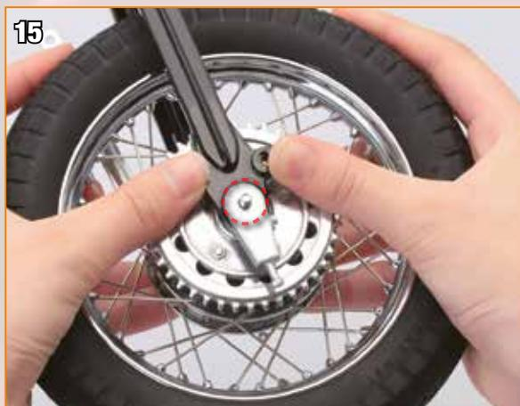
Insérez le moyeu à travers tout l'assemblage.
