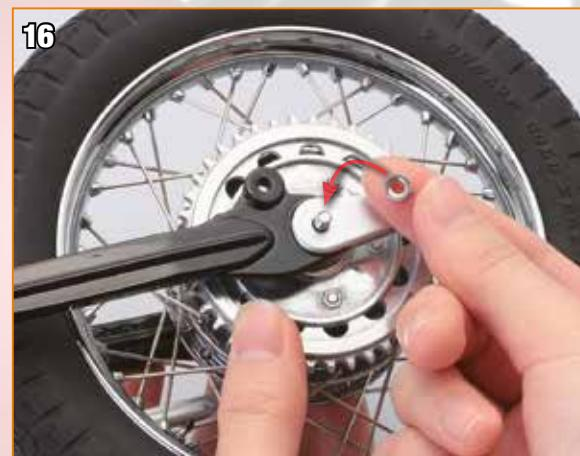
Placez l'écrou sur l'extrémité filetée du moyeu.
