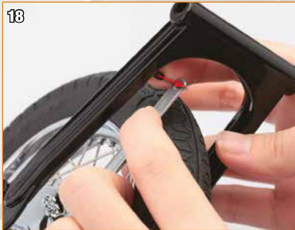
Faites tourner la roue à nouveau. Disposez l'orifice à l'extrémité du bras de butée du frein au dessus du saillant à l'intérieur du bras basculant.
