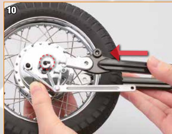
Prenez la roue et tenez assemblés le disque du pignon et le frein. Placez la partie argentée du bras basculant sur l'orifice central du disque (cerclé).
