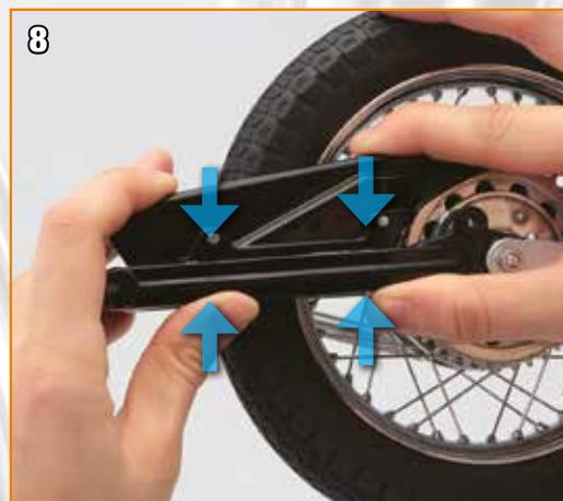
Assemblez le bras basculant et la protection de la chaîne.
