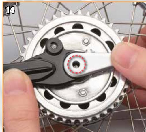
Retournez la roue arrière et vérifiez que l'orifice de la fourche arrière est aligné à celui au centre du pignon.
