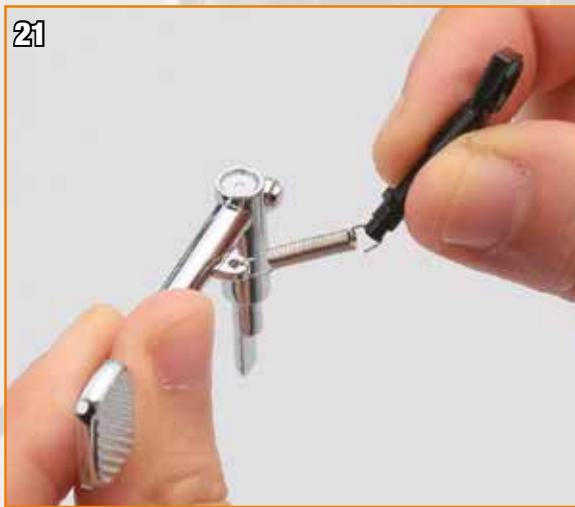
Passez l'extrémité du ressort à l'intérieur de l'orifice de la pédale du frein.
