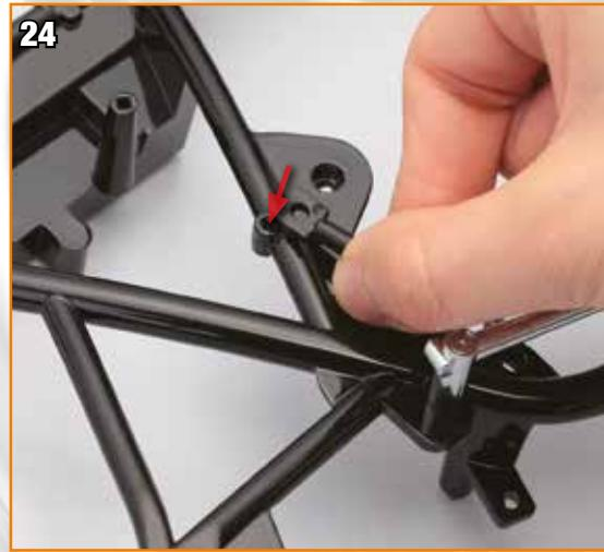
Alignez l'orifice de la partie supérieure du support du ressort et celui indiqué sur le cadre.
