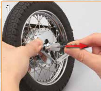
Retirez l'écrou et le moyeu de la route arrière et l'assemblage du bras basculant (étape 31).
