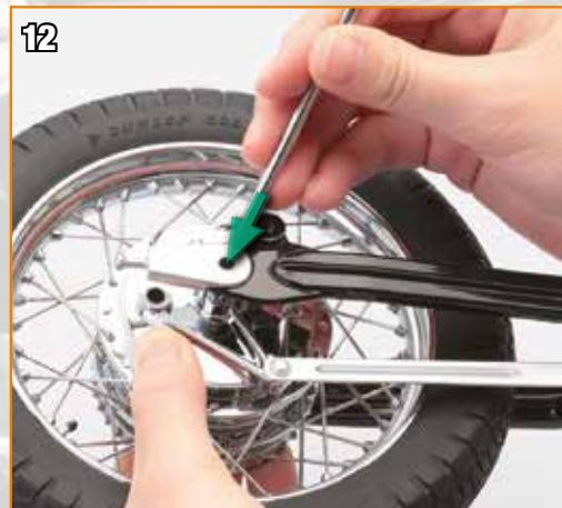
Alignez l'orifice du bras basculant et celui du disque de frein et de la roue.
