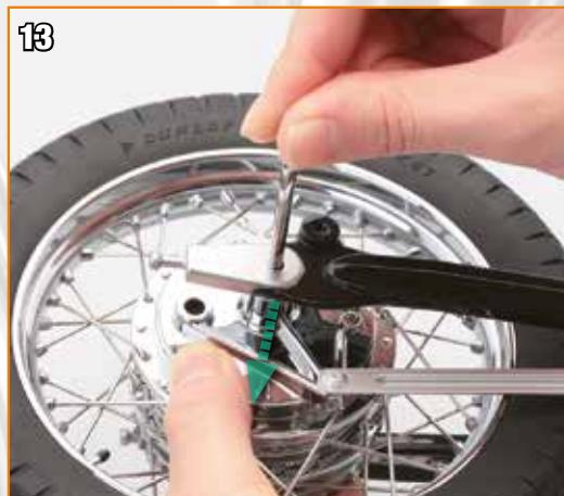
Passez le moyeu à travers le bras basculant, le disque de frein, la roue et le pignon.
