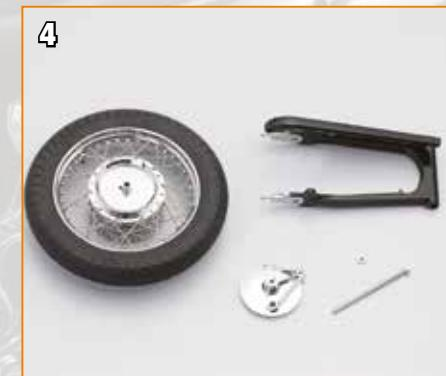
Placez la roue arrière à plat, le pignon tourné vers le plan de travail. Ensuite retirez le disque du frein et posez-le à côté de la roue, avec le bras basculant, le moyeu arrière et son écrou, comme sur l'image.
