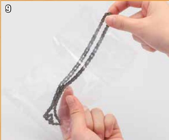
Placez à nouveau la chaîne dans son sac. Comme elle est en acier, des marques d'oxydation pourraient apparaître si elle n'était pas complètement graissée. Appliquez un peu plus de graisse sur ces points le cas échéant.
