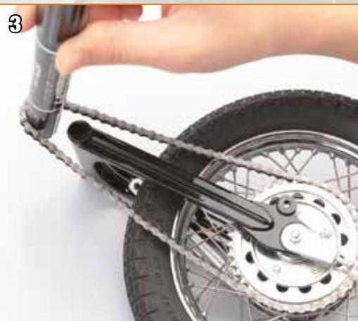
Insérez un cylindre ayant un diamètre d'environ 15 mm entre l'extrémité de la chaîne et celle du bras basculant.
