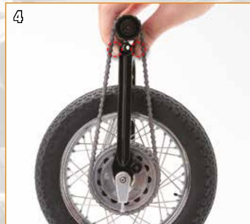
Tenez le cylindre, la roue et le bras basculant comme sur l'image. Tout devrait être en tension. Vérifiez que la chaîne n'est pas en contact avec le bras, comme indiqué dans l'espace cerclé de l'image.
