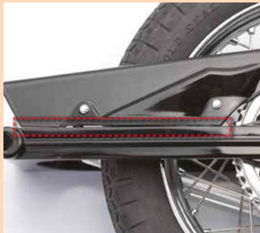
Voilà un exemple d'espace pouvant exister entre la protection et le bras basculant.
