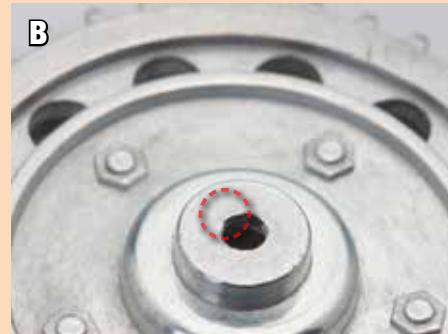
Il est possible que l'ouverture sur l'orifice de l'autre côté du pignon ne soit pas parfaitement circulaire, ce qui pourrait obstruer le moyeu.
