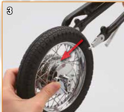
Tenez le pignon et le disque du frein en place sur la roue arrière et retirez le bras basculant.
