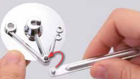
Sur une extrémité du bras de butée du frein arrière se trouve un saillant ; il s'encoche dans l'orifice du disque le plus éloigné du centre.
