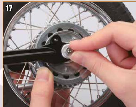
Faites tourner l'écrou sur l'extrémité filetée du moyeu.
