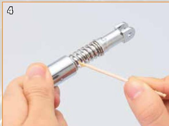
4 Insérez le cure-dent entre les deux tours de vis juste au dessus de la jonction et déposez la graisse sur la jonction indiquée en 3.
