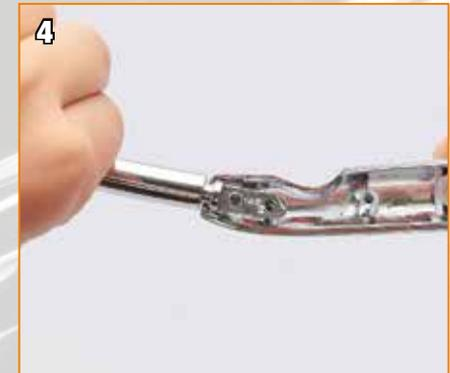
Vérifiez que les deux pièces s'assemblent correctement et que les trous sont bien alignés.
