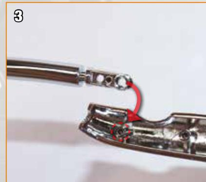
Alignez le trou sur l'extrémité du pot d'échappement et celui qui est cerclé sur le silencieux inférieur droit extérieur.
