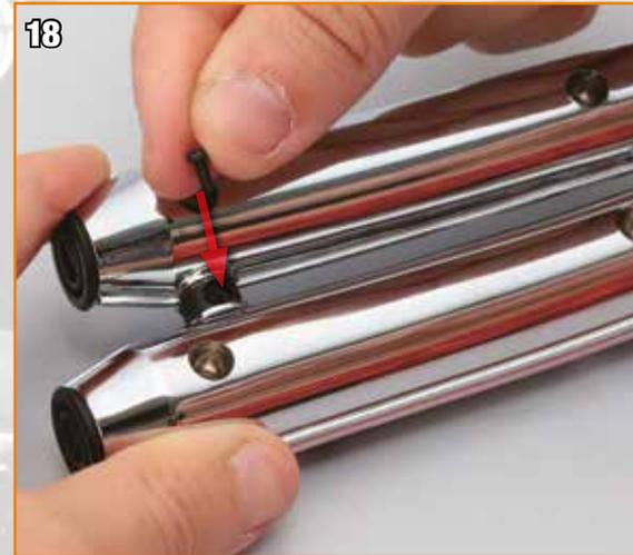
Insérez une vis de type B dans les trous alignés des extrémités des silencieux.
