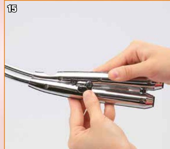
Alignez les deux séries d'orifices des silencieux supérieur et inférieur.
