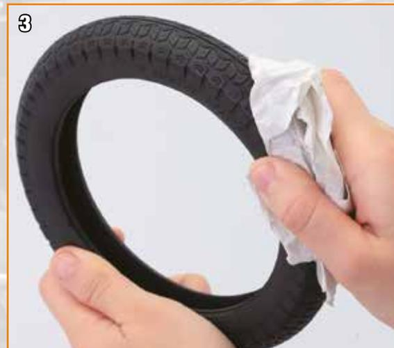
Séchez l'eau et le détergent sur la surface extérieure du pneu en vérifiant que vous retirez aussi toute trace des rainures de la bande de roulement.
