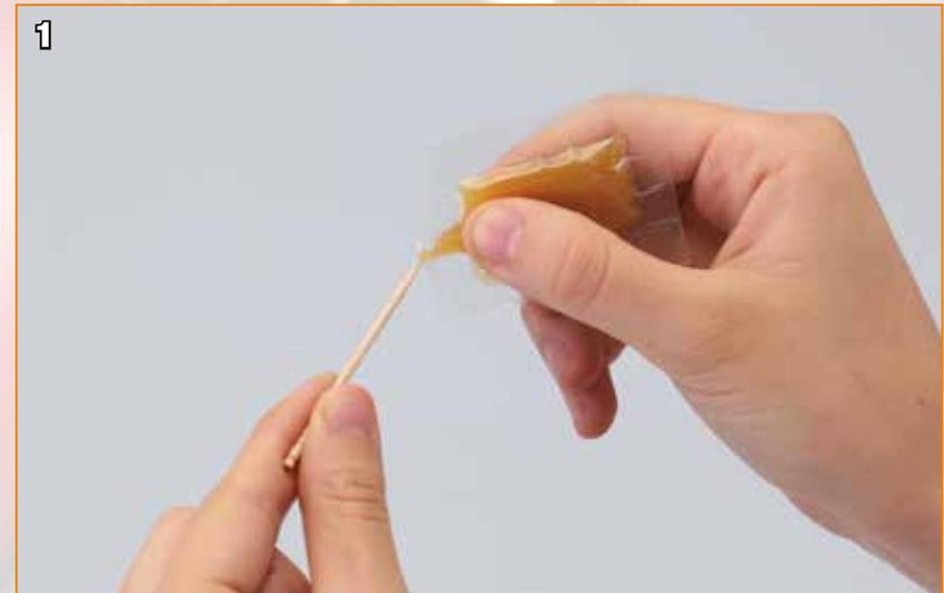
1 Déposez un peu de graisse (étape 6) au bout d'un cure-dent.
