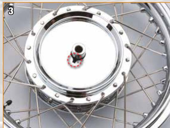
Cherchez le petit orifice à côté du saillant du côté droit de la roue arrière.
