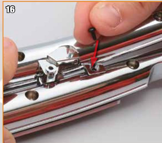
Insérez une vis de type G dans le trou indiqué.
