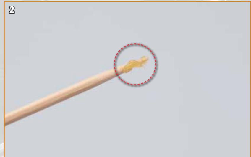
2 Voilà la bonne quantité de graisse, à peu près de la taille d'un grain de riz. Elle doit être suffisamment allongée pour pouvoir passer à travers les ressorts de l'amortisseur.
