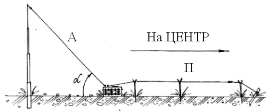
Рис. 3.2. Диаграмма направленности антенны «Наклонный луч»
