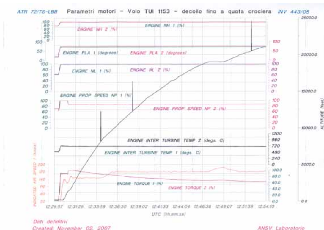
Figura 28: parametri motori di interesse dal decollo fino alla quota di crociera iniziale.
