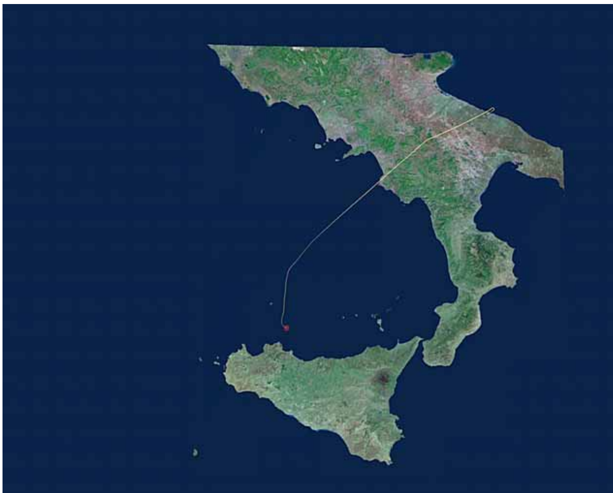
Figura 10: schema raffigurante la traiettoria del TS-LBB desunta dai dati del FDR.
