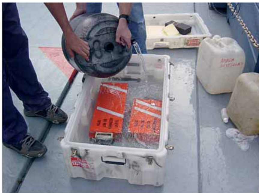
Foto 17: conservazione FDR e CVR in acqua distillata.
