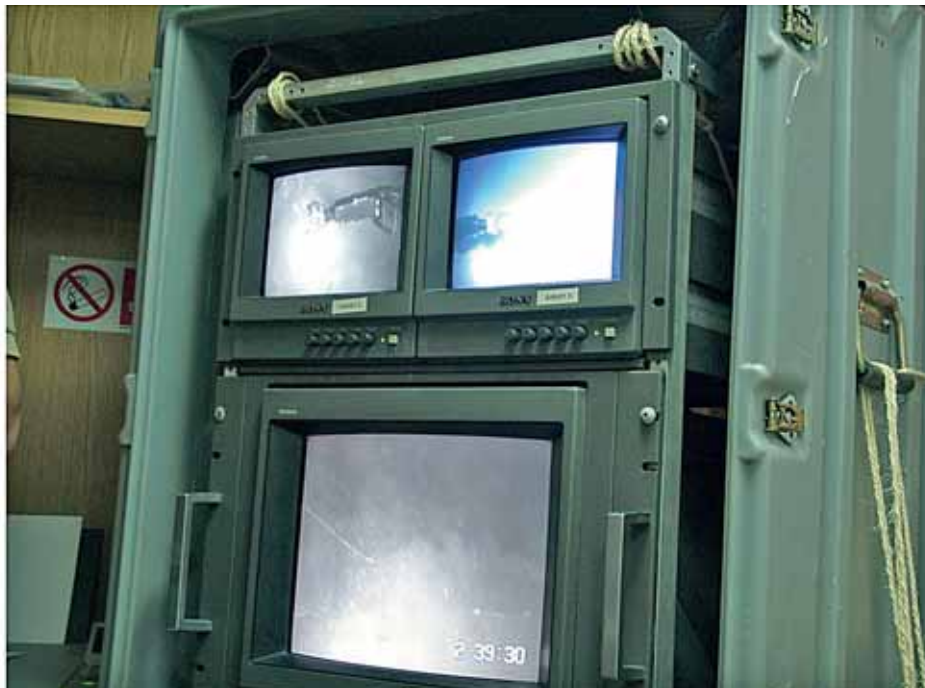
Foto 44: sistema video che replica le immagini delle telecamere montate sul ROV.
