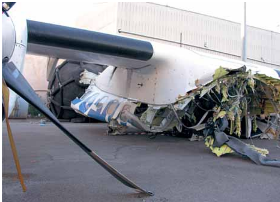
Foto 20: parte fusoliera centrale con semiali.
