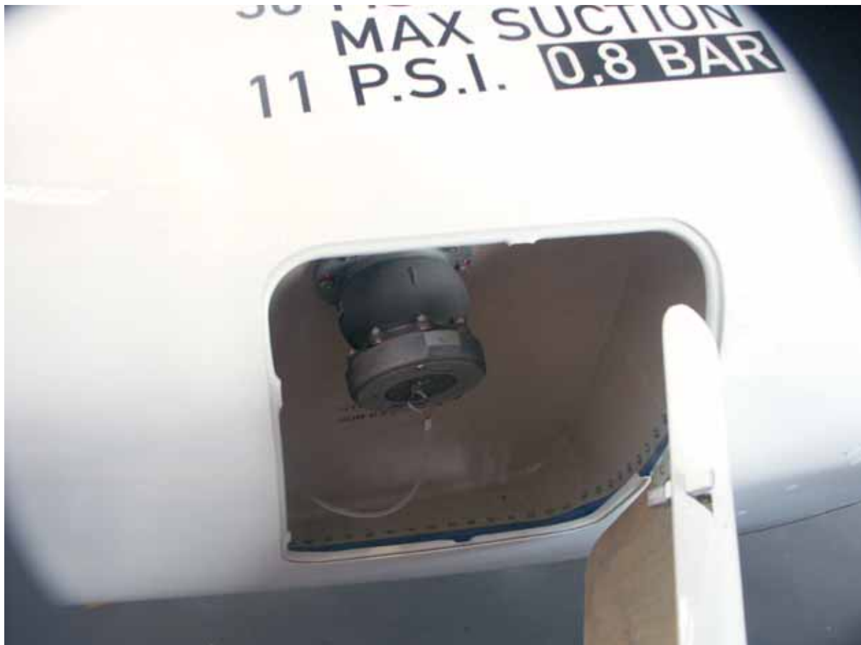
Foto 9: punto di rifornimento centralizzato.
