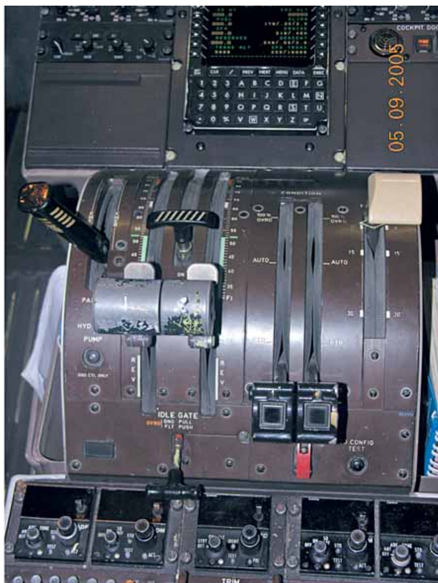
Foto 3: comandi per la regolazione della potenza dei motori (PL a sinistra) e dei giri dell'elica (CL a destra).
