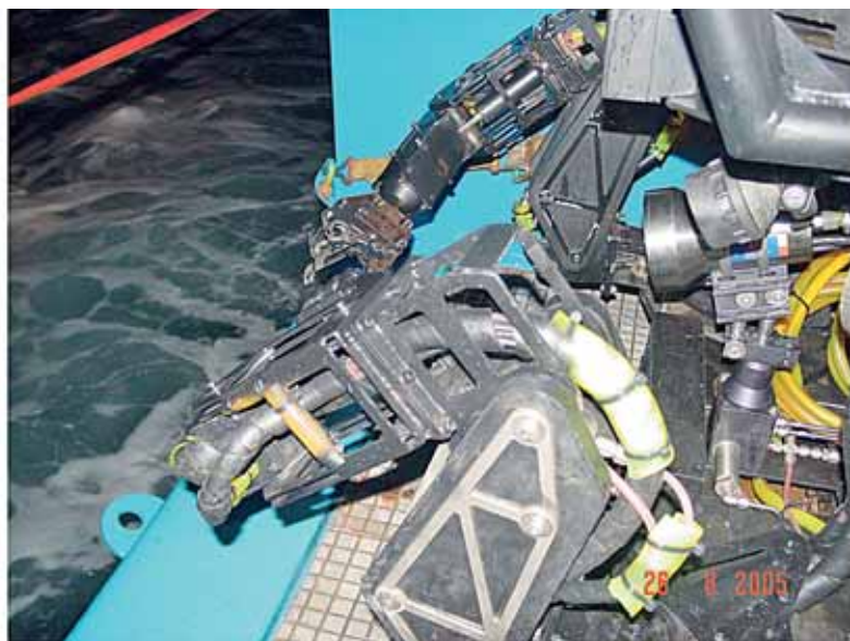
Foto 52: Remora 6000, particolare dei bracci meccanici.
