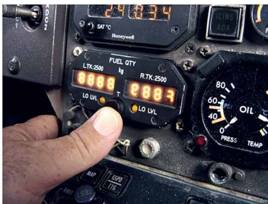
Foto 1: FQI installato sul TS-LBB prima della sostituzione.
