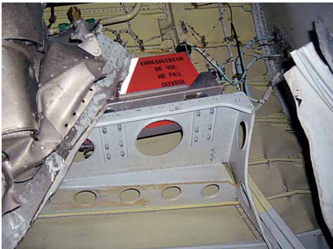
Foto 62: CVR nel suo alloggiamento.
