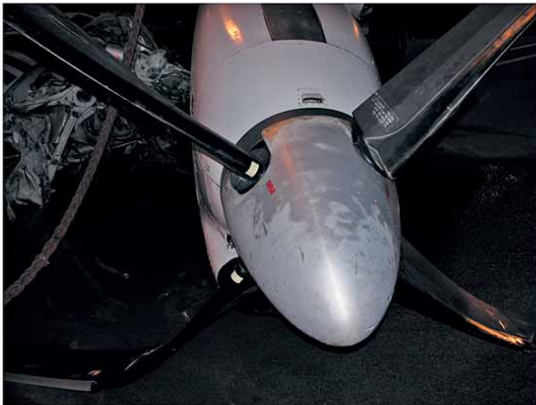
Foto 70: particolare posizione elica motore destro (bandiera).
