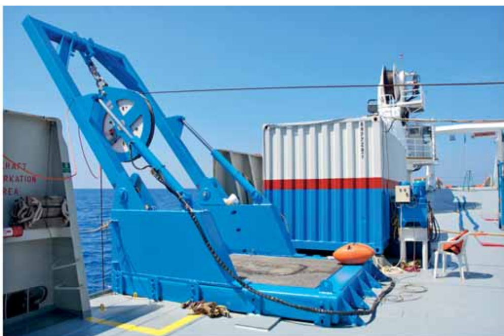
Foto 48: sistema di messa in mare del Remora 6000.
