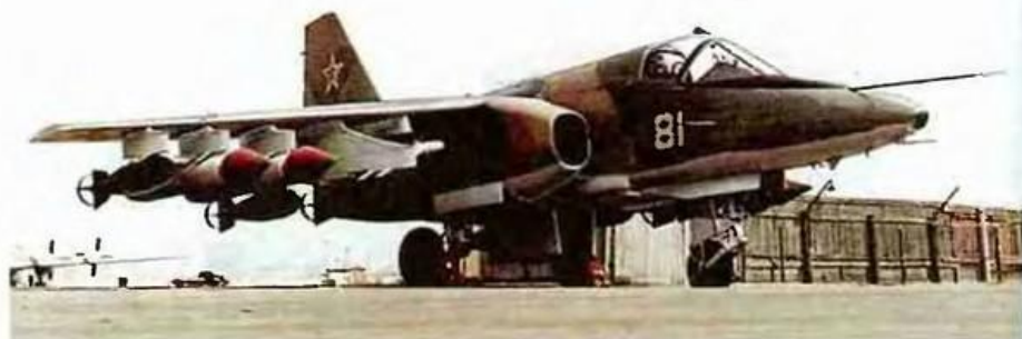
Первый опытный экземпляр штурмовика Су-25. В носовой части установлена подвижная пушечная установка СППУ-22-01
