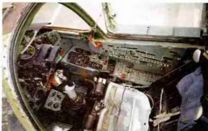
Приборное поле и интерьер кабины серийного Су-25. Подушки катапультируемого кресла К-36ДМ сняты. Фото С.Г. Мороза
