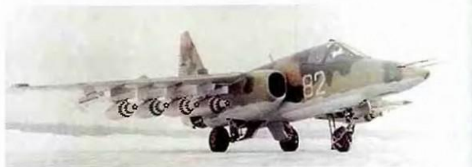
Самолет Т8-2, второй опытный экземпляр штурмовика Су-25 с крылом с «контейнерами». На подвеске 8 блоков НАР УБ-32 и 2 ракеты воздух-воздух Р-3с
