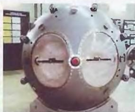
Антенны радиовысотомера в передней части корпуса бомбы РДС-1
