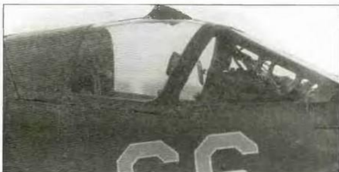
Усиленный фонарь кабины самолета Су-25 с перископом и боковыми зеркалами заднего вида. Архив С.Г. Мороза
