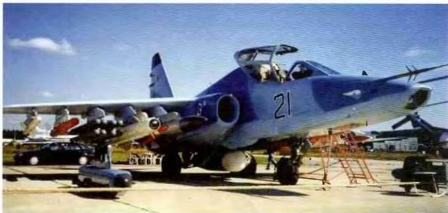
Штурмовик Су-25ТМ (Су-39) на стоянке аэродрома ЛИИ, 2001 г. На подвеске противорадиолокационные ракеты Х-58Э, ракеты воздух-поверхность Х-29Т, блоки по 8 ПТУР «Шквал», ракеты воздух-воздух Р-77 и Р-73. Под фюзеляжем контейнер с РЛС «Кинжал». Рядом с самолетом контейнеры РЭП МСП-140. Фото С.Г. Мороза
