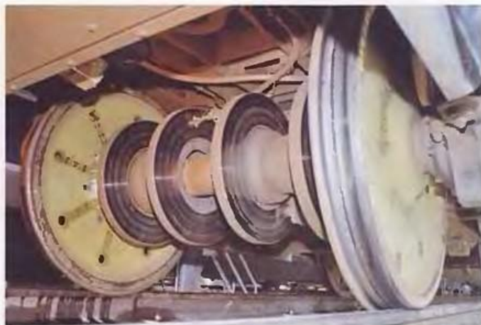
Дисковые тормоза двухосных тележек. На дисках видны датчики, которые фиксируют самые незначительные деформации или повреждения диска на любой скорости
