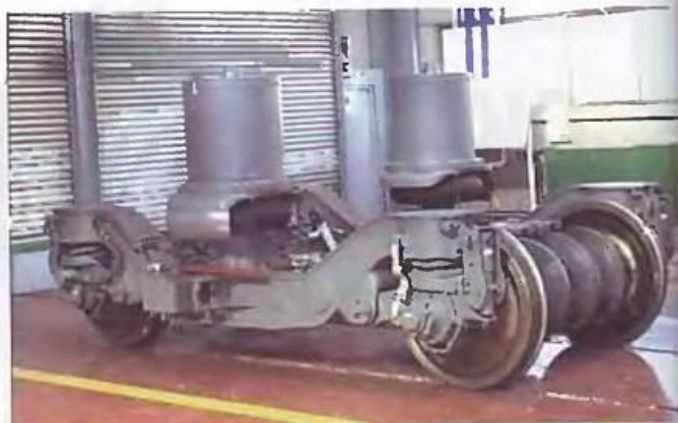
Двухосная тележка с двумя узлами подвески, которая соединит соседние вагоны
