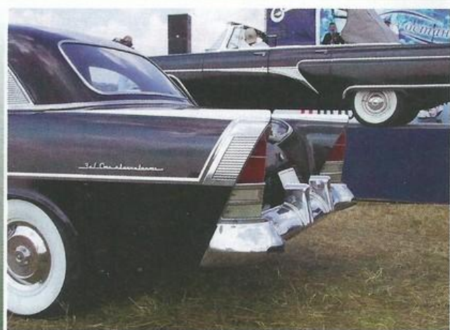
Кили и задние крылья почти полностью скопированы с американского прототипа. Разница в надписи хромированной прописью «ЗиЛ сто одиннадцать» и кантиках на фонарях. Обратите внимание на выхлопные трубы, запрятанные в интегрированный бампер
