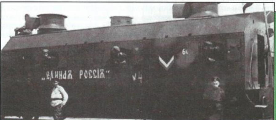
Пулеметная площадка бронепоезда «Единая Россия», построенная на базе американского угольного полувагона-гондолы
