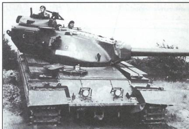
«Конкерор» Mk1 Королевского гусарского полка на учениях. Все люки открыты. Перед люком водителя видны три смотровых прибора — отличительный признак модификации Mk1
