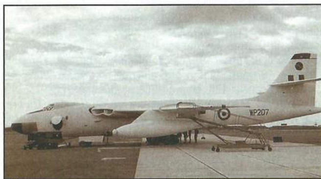
Серийный стратегический бомбардировщик «Вэлиент» в базовой модификации В Mk.1. Под крылом установлены сбрасываемые подвесные баки. Фото: //htka.hu
