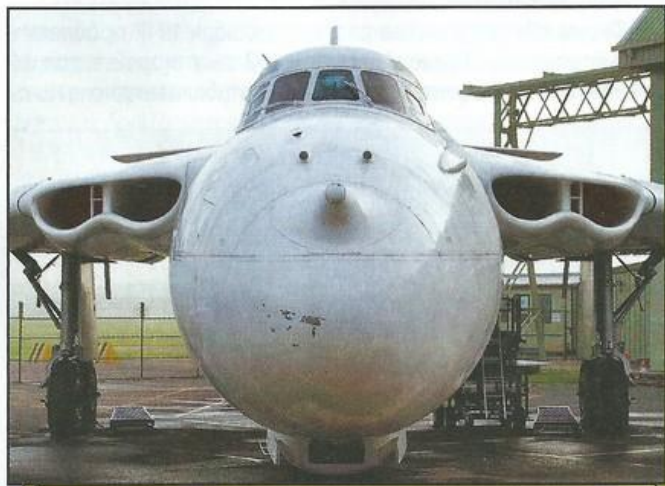
Установка двигателей в крыле стала общей характерной особенностью всех английских стратегических бомбардировщиков серии V. Фото: //airliners.net
