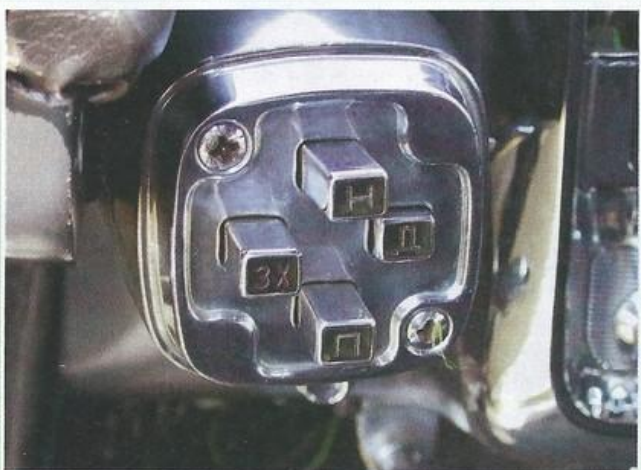
Электрический кнопочный селектор автоматической коробки передач ЗиЛ-111
