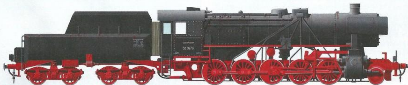
Kriegslokomotive BR-52. Тендер с несущим корпусом
