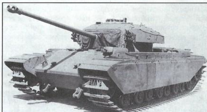
Первый прототип А45, машина вооружалась 17-фунтовой пушкой. Башенка дистанционно управляемого пулемета видна в передней части корпуса, справа
