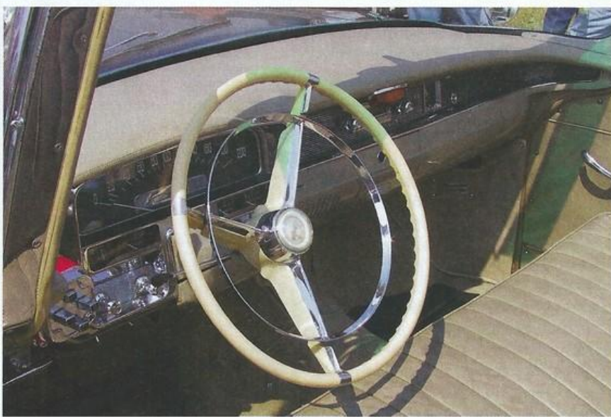
Панель приборов и руль ЗиЛ-111 всех модификаций почти точно копирует торпедо Cadillac середины 50-х. Дизайн кнопочного селектора позаимствован с крайслеровских авто
