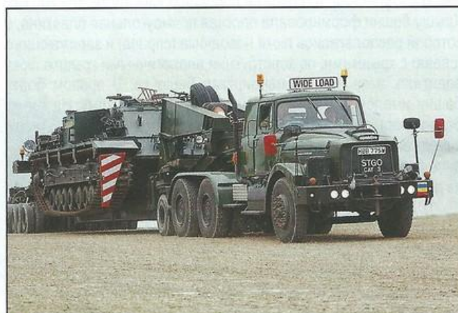
Перевозка БРЭМ FV222 ARV Mk2 автотрейлером. Для уменьшения ширины автопоезда с БРЭМ сняты бортовые экраны
