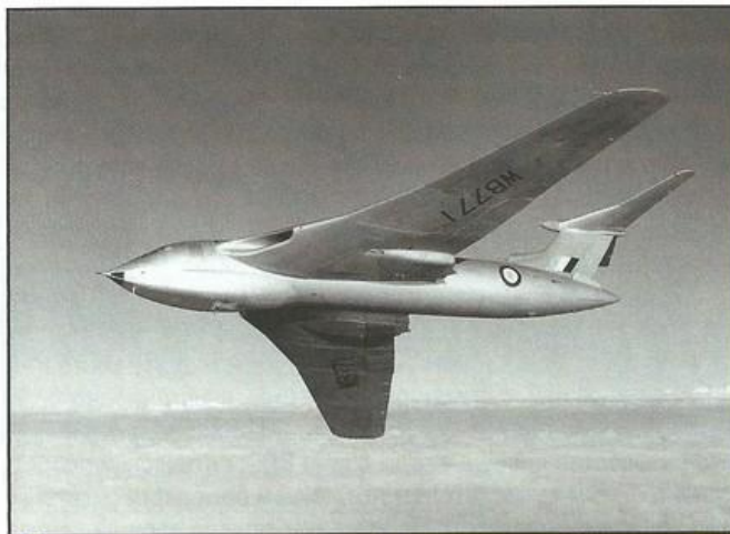
Первый опытный стратегический бомбардировщик «Виктор» во всей красе. Хорошо видна его главная особенность — изоклиническое серповидное крыло. Фото: //raf.mod.uk
