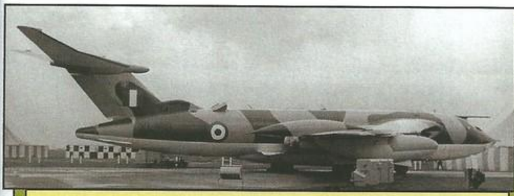
На крыло бомбардировщика «Виктор» В.2 борт XL160, как и на другие такие машины, в ходе доработки были установлены «морковки Кюхемана» для снижения волнового сопротивления. Фото: //millionmonkeytheater.com
