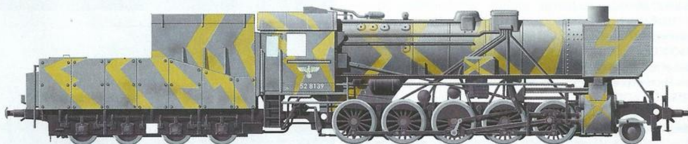
Kriegslokomotive BR-52 с тендером на жесткой раме в «искажающем» камуфляже
