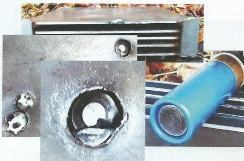
Результаты отстрелов «по-партизански» — в лесу. Отстреливалась многолистовая мишень закаленной пулей с покрытием Al+PTFE. Опытный патрон также содержал пороховой составной заряд, разработанный и запатентованный к.т.н. М.А. Кислиным. Оружие — карабин МР-153
