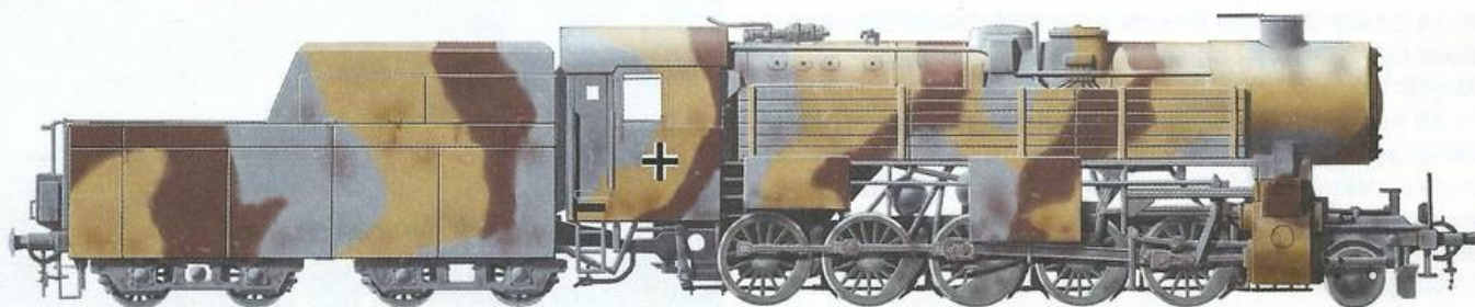
Kriegslokomotive BR-52 камуфлированный и экранированный шпалами и стальными листами
