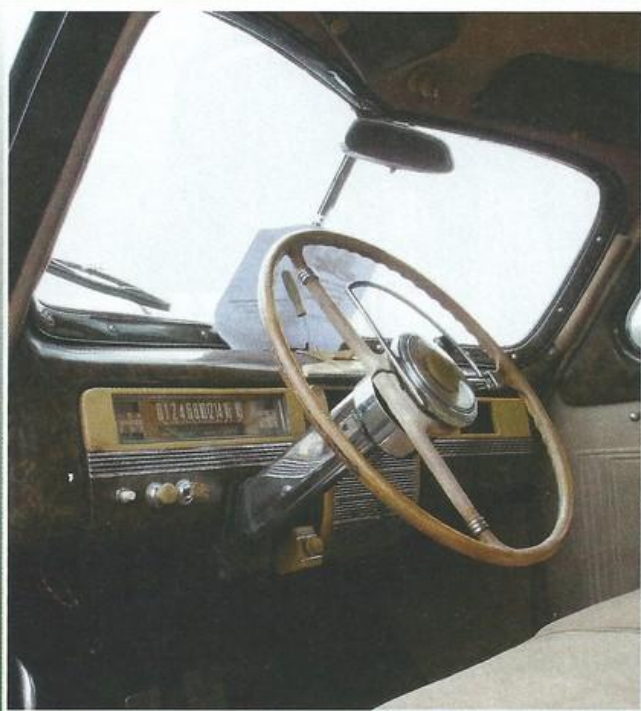
Панель приборов ЗиС-110. Никакого дерева — одна пластмасса! Пластиковый руль уже слегка тронут разложением. Что поделаешь — время
