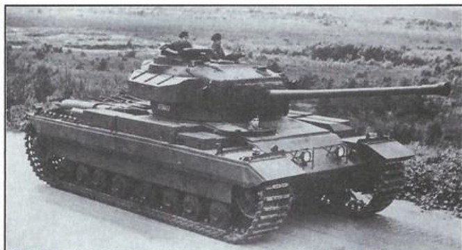
Средний пушечный танк FV221 «Карнарвон», был получен путем установки на шасси FV214 башни от танка «Центурион» Mk3 с 20-фунтовой пушкой
