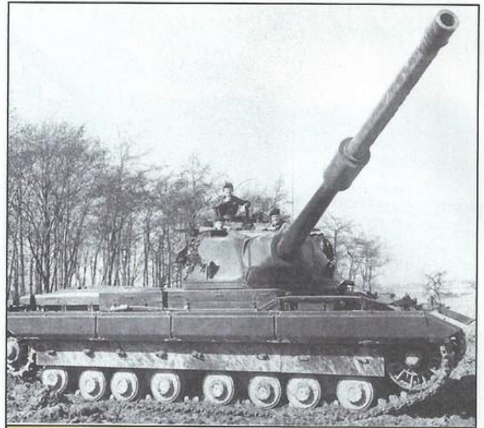
«Конкерор» Mk2, хорошо виден массивный ствол 120-мм пушки. Модификация Mk2 имела одинарный прибор наблюдения перед люком водителя
