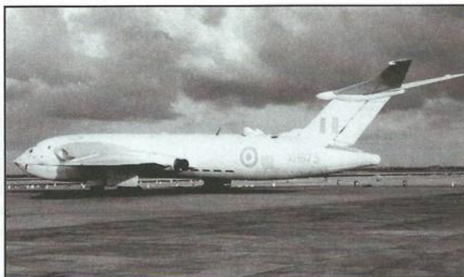
Седьмой стратегический бомбардировщик и заправщик «Виктор» В.2 борт ХН675 с «чистым» крылом без «морковок Кюхемана» — в таком виде все самолеты покинули завод. Фото: //totavia.com
