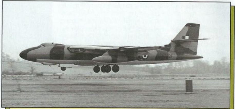
Самолет «Вэлиент» отличался необычными N-образными основными стойками шасси, которые были рассчитаны на маленькие ниши в тонком крыле. Фото: //totavia.com
