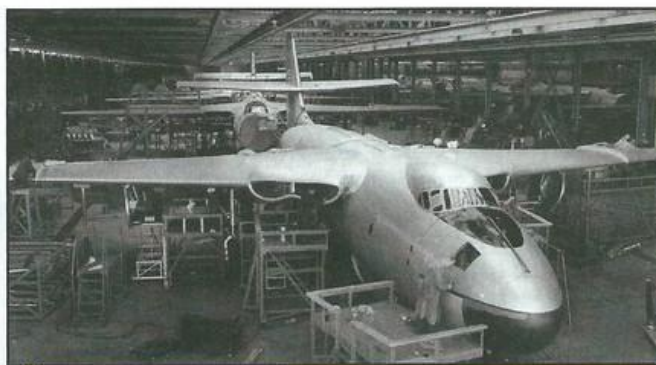
Идет окончательная сборка и отработка систем на серийных бомбардировщиках «Вэлиент» В Mk.1. Фото: //htka.hu
