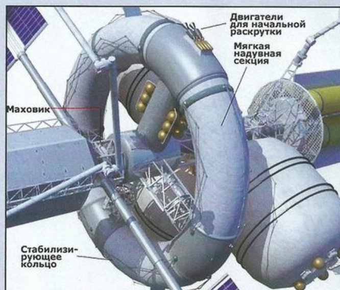
Центрифуга должна насчитывать в диаметре от 9 до 12 метров и вращаться со скоростью от 4 до 10 оборотов в минуту. Это обеспечило бы внутри нее гравитацию от 0,08 до 0,69 g. Причем, части тора также должны быть надувными и раздвижными (иллюстрация TAAT, NASA JSC)
