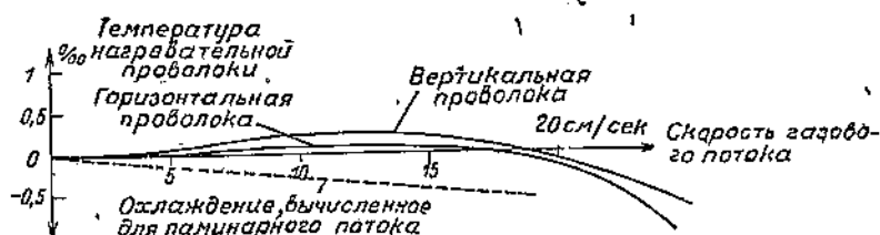
Рис. 15. Влияние слабых токов на температуру измерительной проволоки.
