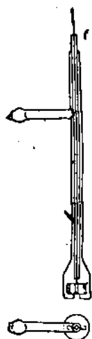
Рис. 13. Водородный электрод Гильдебранда.
