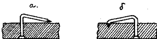
Фиг. 80. Загибание гвоздей: а—неправильно, б—правильно.
