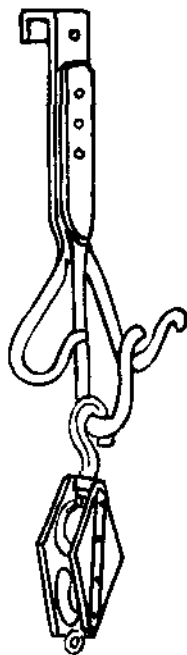
Фиг. 99. Крюк для подвешивания блоков и т. п. к стропилам.
