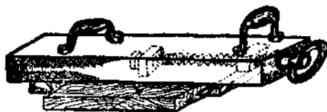
Фиг. 139. Направляющая колодка с винтовым зажимом.
