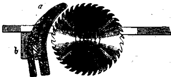
Фиг. 16. Раскливающий нож фирмы А. Goede для пилы уменьшенного диаметра.
