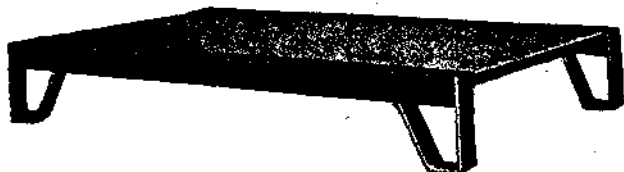
Фиг. 248. Платформа для складывания обрабатываемых предметов для перевозки их ручными и моторными трэками.
