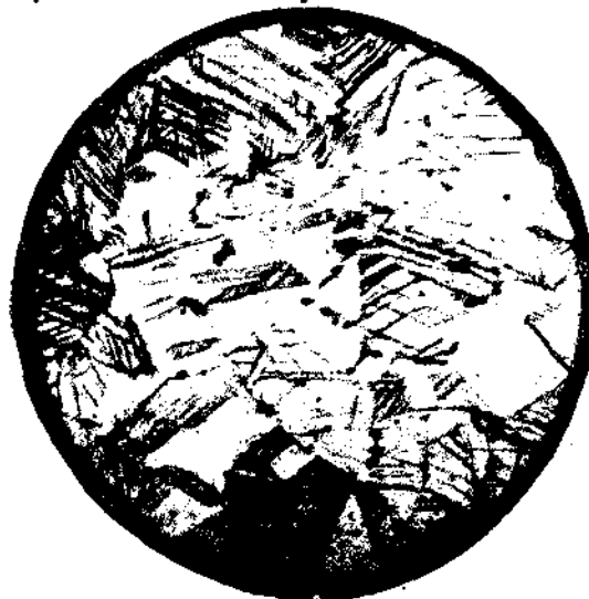
Рис. 123. Аустенит (деформированная 25% Ni — сталь). Азотная кислота (лин. увел. 1000).
