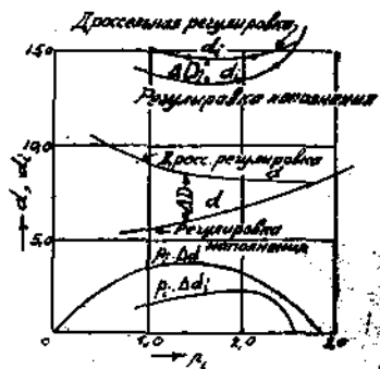
Фиг. 6. Расход пара при регулировке наполнением и при регулировке мятисом (дроссельной).
