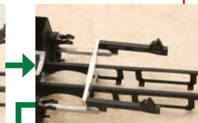
Faites tourner le moteur cadre de façon à ce qu'il soit perpendiculaire au châssis.
