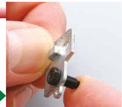
Placez un écrou sur le filetage de la goupille.
