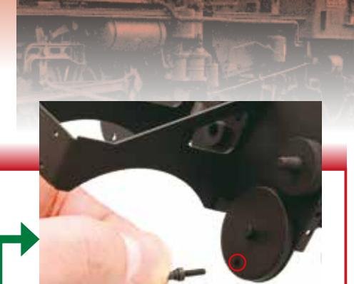
Vissez l'une des soupapes de sécurité dans le trou situé en bas du couvercle du cylindre.
