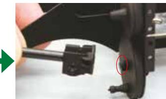
Placez les boîtiers sur les ressauts situés au centre des couvercles de cylindre avant (encerclés).
