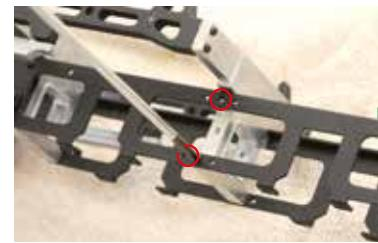
Serrez à demi une vis de 2 x 5 mm dans les deux trous ici indiqués, sur les côtés du châssis.
