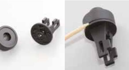
Appliquez de la colle à base de caoutchouc synthétique sur l'avant des guides arrière des soupapes de piston B et combinez-les avec les guides A, comme sur l'image ci-contre. Éliminez tout excès de colle à l'aide d'un cure-dents.
