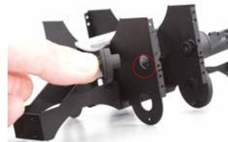
Appliquez une petite quantité de colle à base de caoutchouc synthétique sur les couvercles de boîte à vapeur avant, puis insérez les couvercles dans les deux trous de la plaque avant. Pressez fermement pour les mettre en place.
