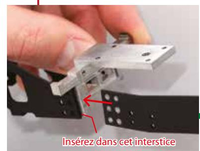
Placez le support entre les extrémités du châssis principal, et insérez le châssis arrière gauche dans l'interstice montré ci-contre.
