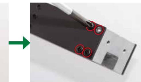
Vissez à demi une vis de 2 x 4 mm dans chacun des trous indiqués d'un côté du châssis.
