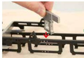
Placez la plaque arrière du cadre moteur entre les châssis, derrière le reste du cadre moteur.
