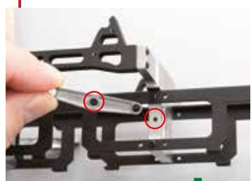
Faites correspondre le trou situé au centre de l'un des balanciers de suspension avec le trou (encerclé) situé sur la plaque arrière du cadre moteur.
