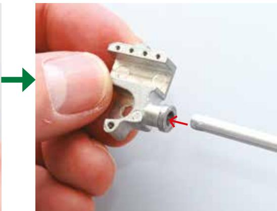
Insérez l'axe de piston dans le trou du ressaut cylindrique de l'une des crosses.
