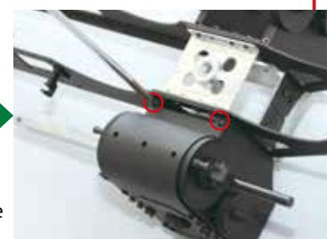
Serrez à moitié deux autres vis de 2 x 2mm dans les deux trous de dessous (encerclés).
