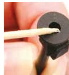
Appliquez un peu de colle à base de caoutchouc synthétique à l'arrière des deux boîtiers des axes de piston.
