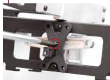
Serrez à demi une vis de 2 x 8 mm dans le trou situé au centre de la ferrure.
