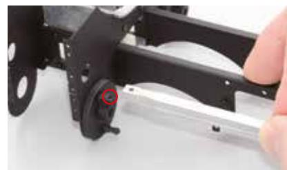
Placez la partie avant de l'une des barres sur le trou situé sur le ressaut carré du couvercle.
