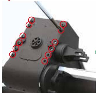
Serrez à moitié une vis de 2 x 2 mm dans chacun des trous ainsi alignés (encerclés).
