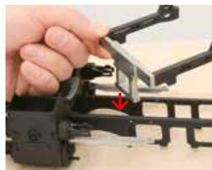
Placez le cadre moteur entre les châssis, derrière les cylindres.
