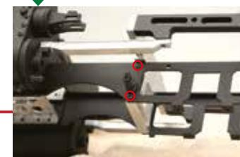
Alignez les trous de la plaque avant du cadre moteur avec ceux du châssis et serrez à demi deux vis de 2 x 5 mm dedans.
