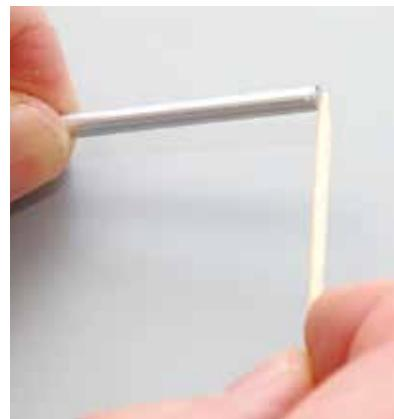
Appliquez un peu de colle époxyde à une extrémité de l'un des axes de piston.
