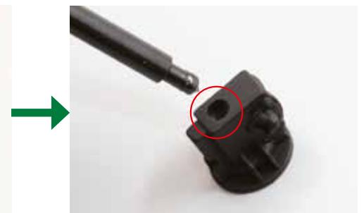
Insérez l'axe de piston dans le trou situé sur le bout rectangulaire d'un boîtier d'axe de piston.
