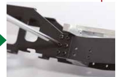
Placez le châssis arrière droit entre le support et le châssis principal. Serrez à demi une vis de 2 x 5 mm dans chacun des trous alignés.
