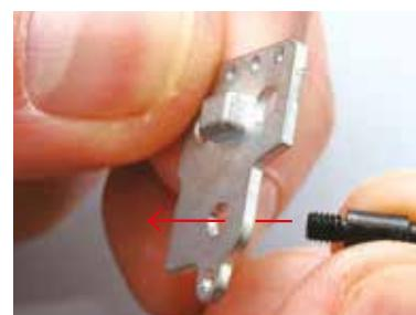
Insérez une goupille de piston dans l'une des crosses extérieures.
