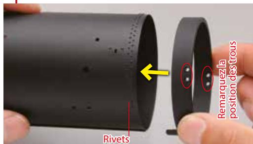
Tenez le joint de la chaudière comme indiqué ci-dessus et placez-le dans l'extrémité rivetée de la boîte à fumée.
