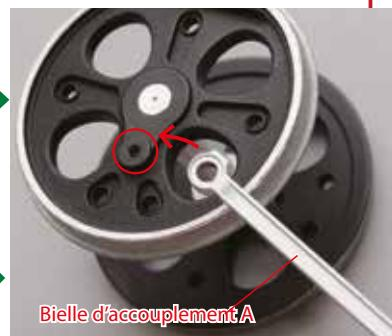
Alignez le trou situé à l'extrémité de la bielle d'accouplement A avec le trou de la roue, encerclé.
