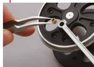
Insérez une bague dans le trou de la bielle d'accouplement.
