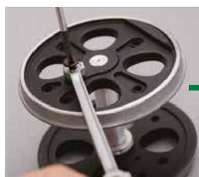
Insérez une goupille dans la bague placée à l'extrémité de la bielle, et vissez-là dans la roue. Vous fixerez ainsi la bielle d'accouplement à la roue.
