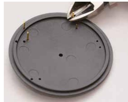
Lorsque la colle a séché, retirez le gabarit de montage et coupez les extrémités de fil de laiton qui dépassent à l'arrière de la porte de la boîte à fumée.
