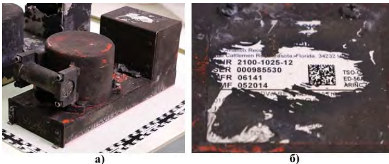
Рис. 31. Бортовой речевой регистратор L3 FA2100: а) общий вид; б) этикетка с маркировкой устройства
