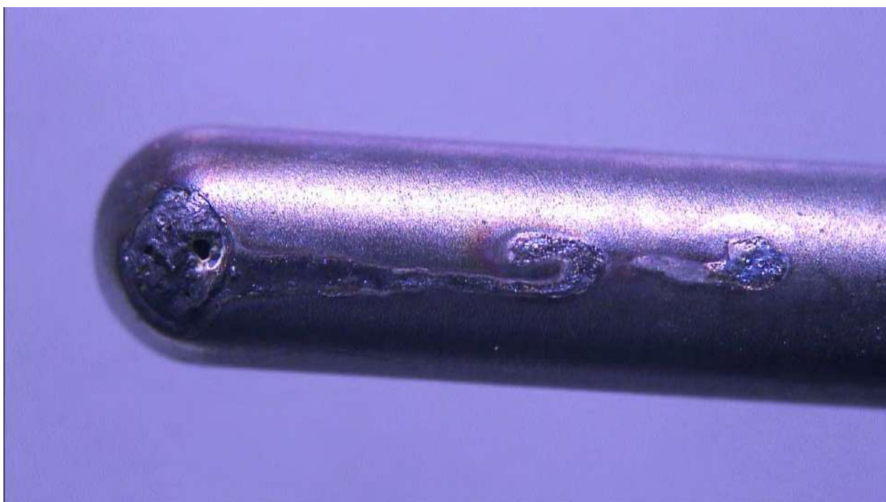
Рис. 25. Следы попадания молнии в правый сигнализатор обледенения
