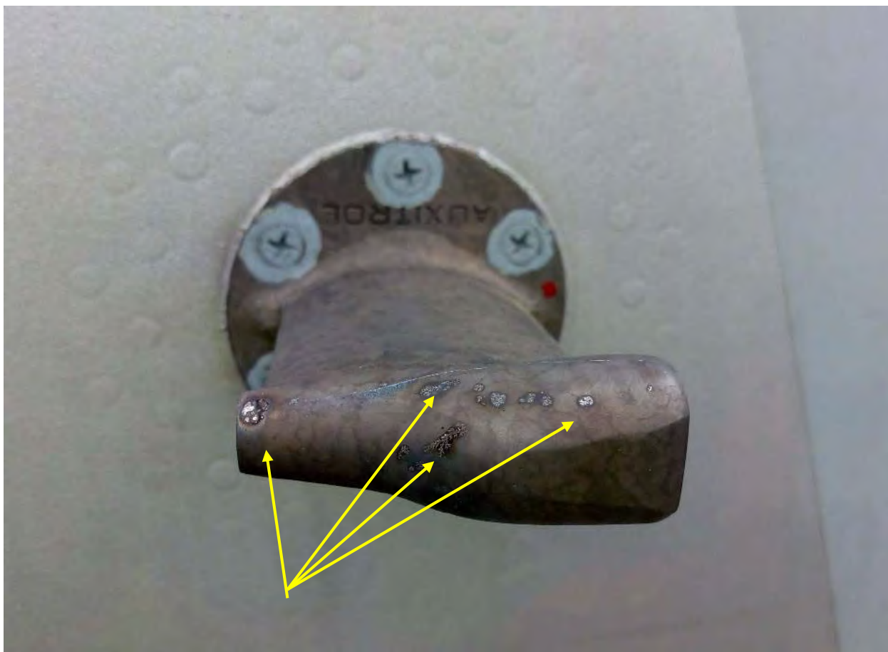
Рис. 24. Следы попадания молнии в правый датчик температуры
