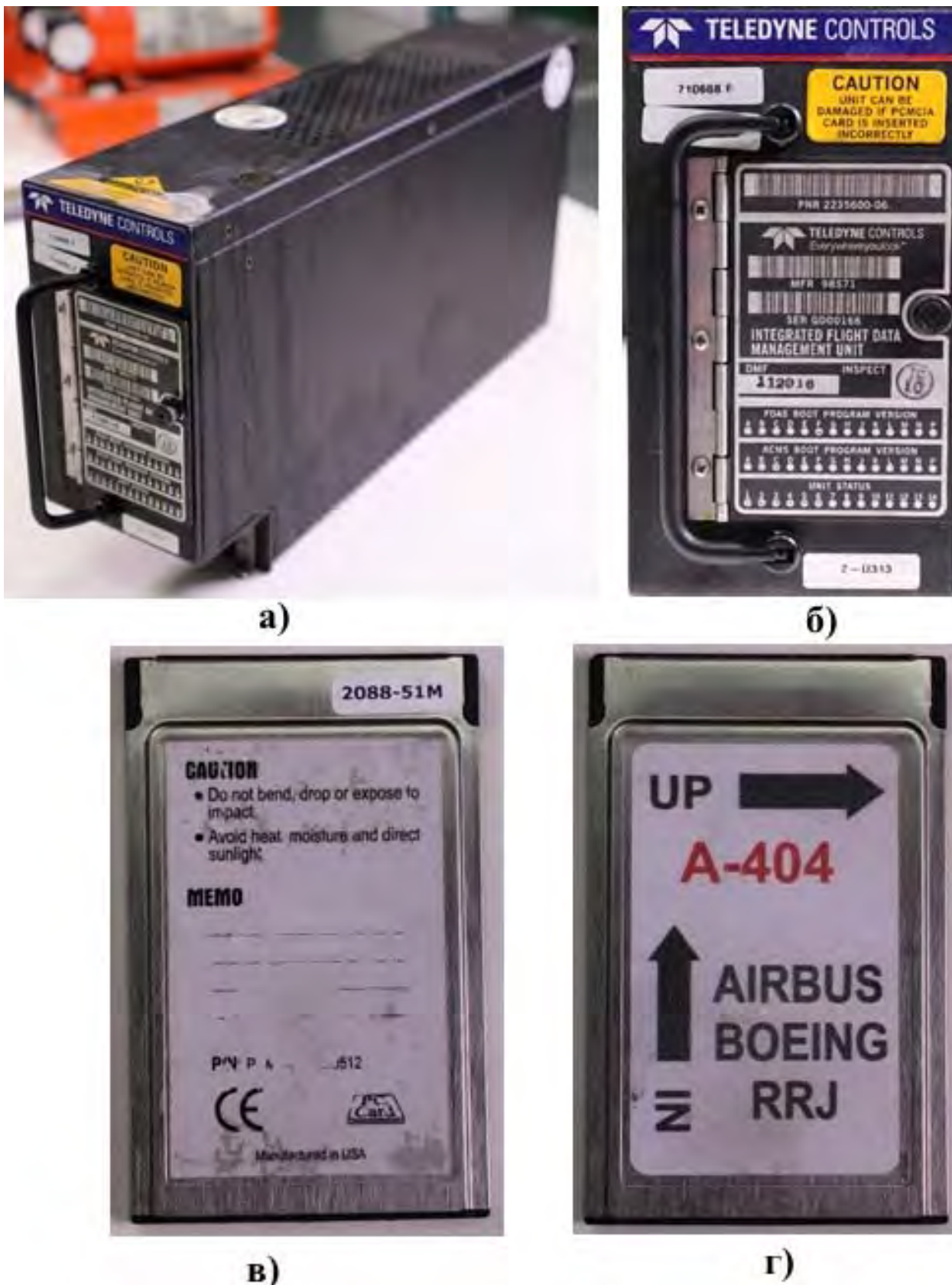
Рис. 32. Интегрированный блок управления данными (iDMU) с эксплуатационным параметрическим накопителем Flash-картой PCMCIA (№ 2088-51M): а) общий вид блока; б) этикетка с маркировкой устройства; в, г) Flash-карта PCMCIA (№ 2088-51M)
