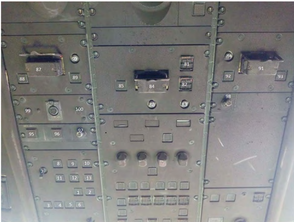
Рис. 21. Состояние переключателей системы пожаротушения двигателей и ВСУ после АП
