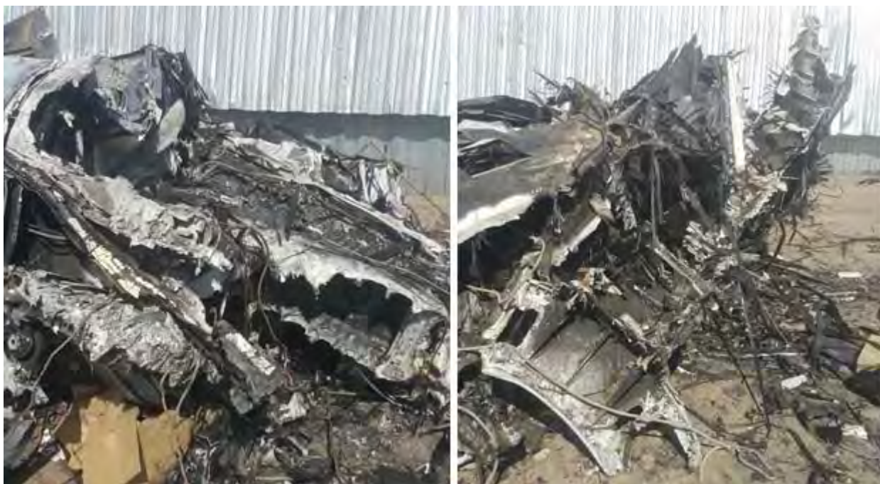
Рис. 14. Внешний вид элементов вертикального и горизонтального оперений после АП
