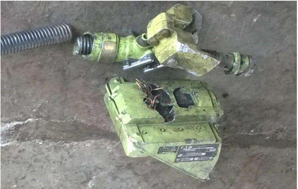
**Fig. 24. The stab trim motor elements**
