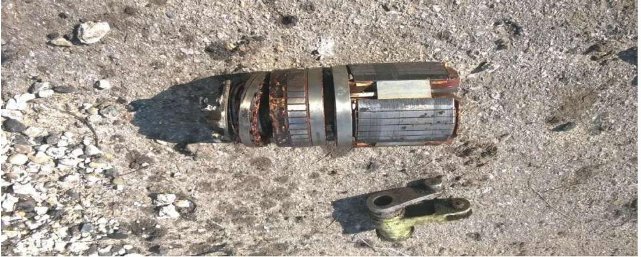
**Fig. 18. The generator rotor**
