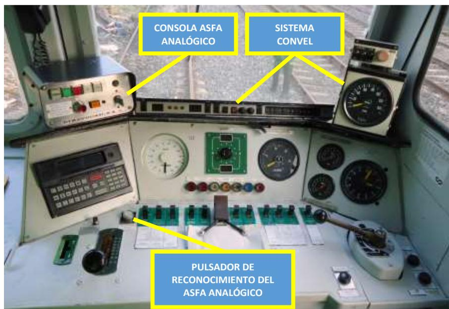
*Figura 13: cabina de conducción unidad 592 con ASFA analógico y Convel*
