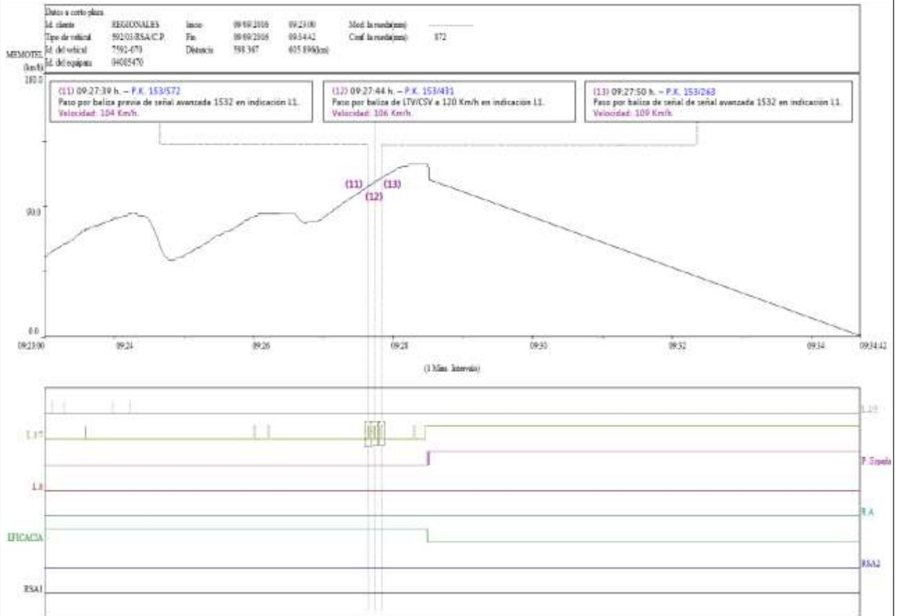
*Figura 10: gráfica de velocidades proporcionadas por sistema Memotel, con detalle de puntos 11, 12 y 13 asociados a señal 1532*
