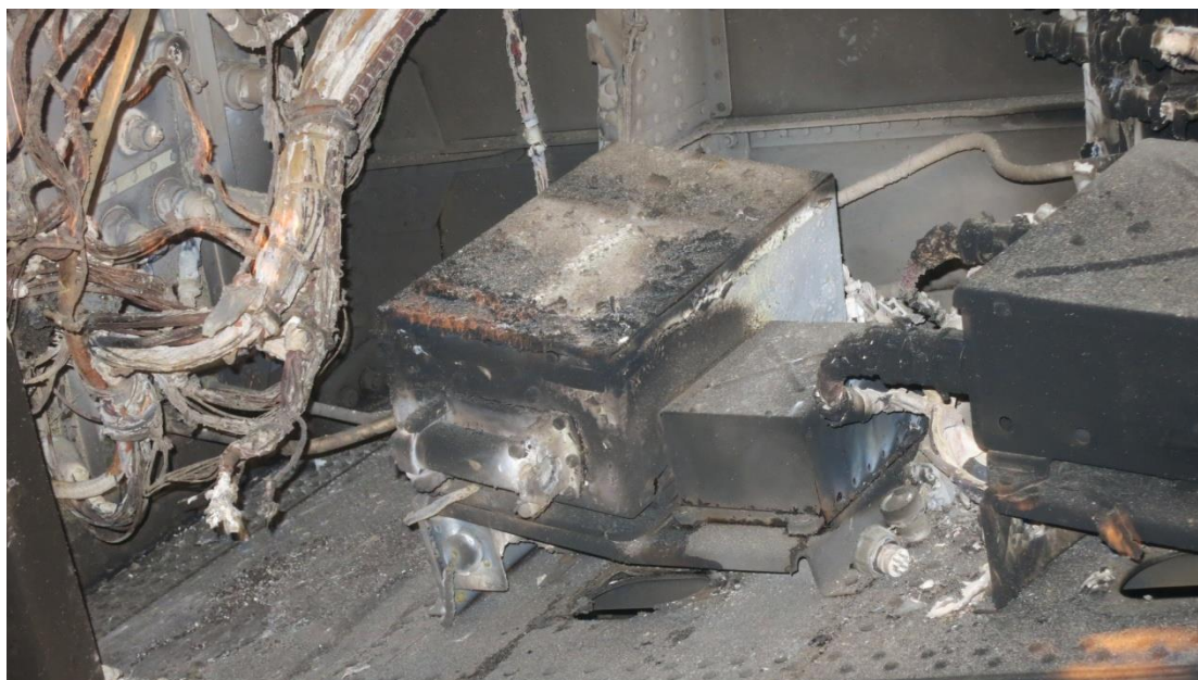
Рис. 3. Защищенный бортовой накопитель ЗБН-1-3 в месте его обнаружения
