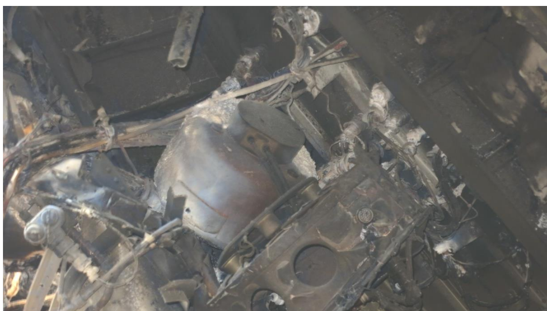
Рис. 4. Бортовой магнитофон МАРС-БМ в месте его обнаружения
