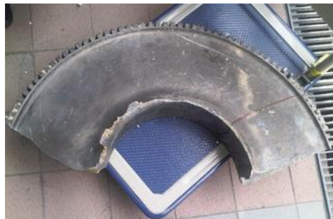
飛散した中圧タービンディスク
