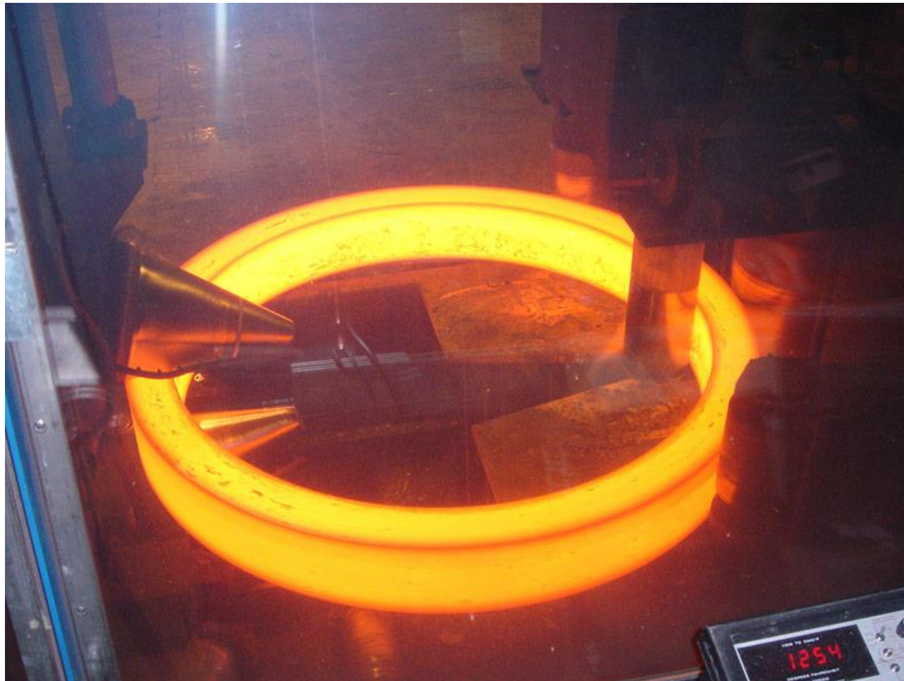
リング鍛造 圧力ケースの素材
