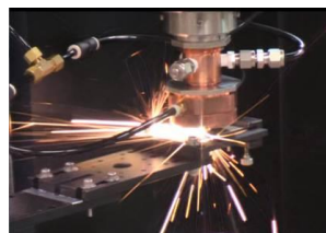
高速レーザ穴加工
