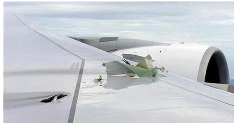
飛散したエンジン部品により損傷した翼
