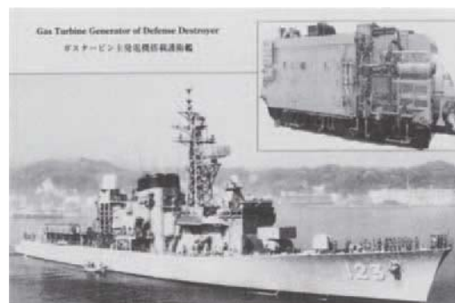
Fig. 2 M1A-02ガスタービン主発電機と搭載護衛艦
