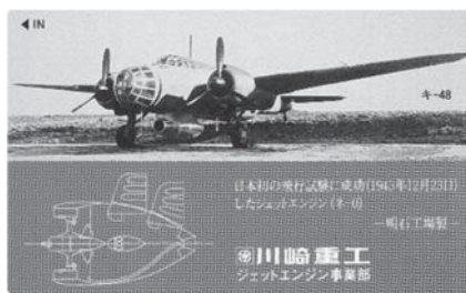
図2 ネ-0装着 キ-48 爆撃機初飛行成功
