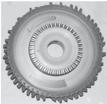
Fig. 4 第1タービン動翼の高温腐食による破損状況
