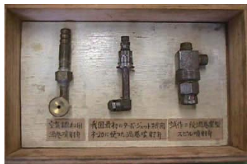
図3 「ネ-20」に使われた燃料噴射弁
