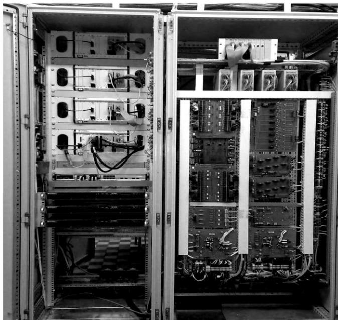
Рис. 4.11. Система аварийной защиты и управления для испытаний третьей степени РН “Ангара”
