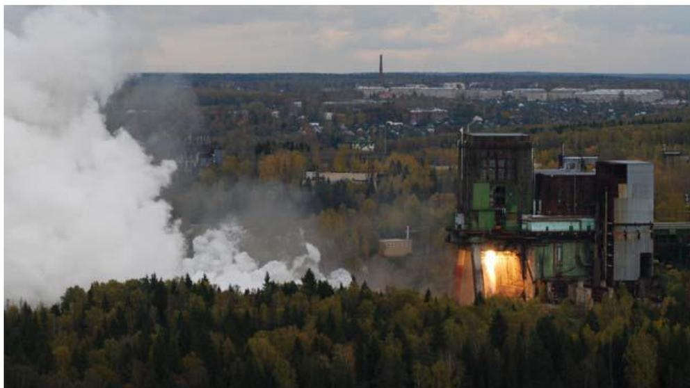
Рис. 3.2. Стенд ФКП «НИЦ РКП» для испытаний ДУ ступеней РН
