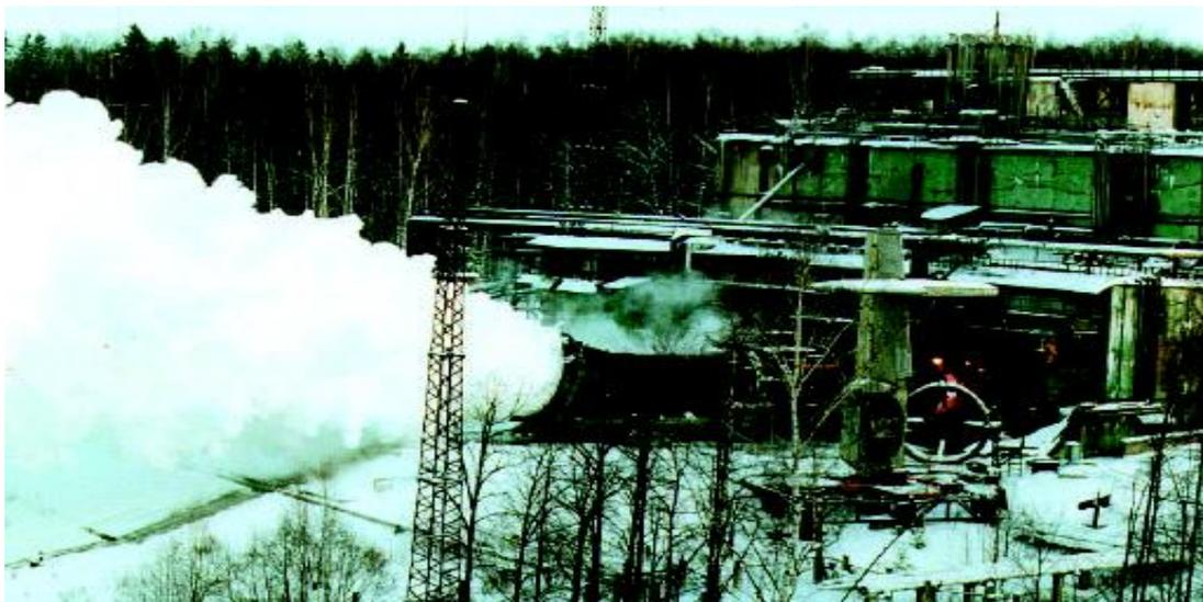
Рис. 3.18. Испытание ЖРД РД0120 на стенде с устройством глушения шума
