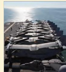
回転翼を折りたたみ主翼を格納できるので、強襲揚陸艦などに多くの機体を積載できます。
