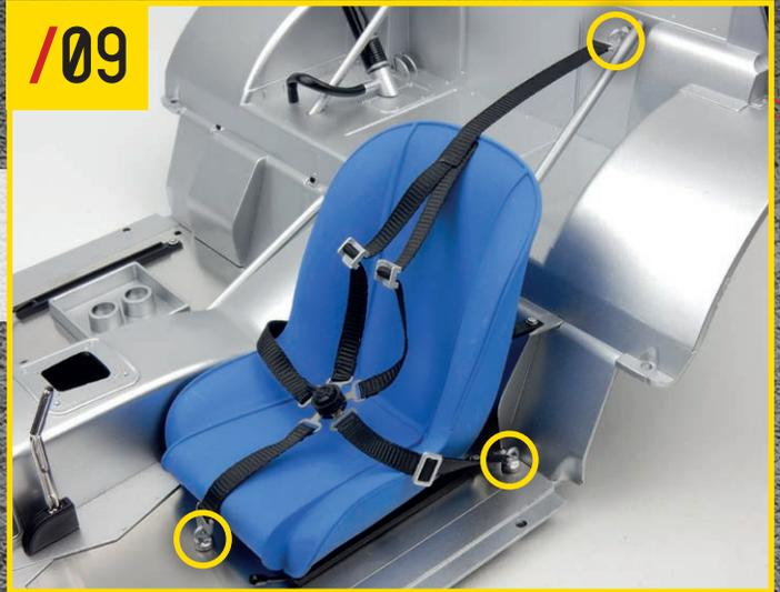
5-13 (運転席シートベルト)の向きを整え、端のフックを写真の黄色い丸で示した位置のシートベルトアンカーに引っ掛ける。
