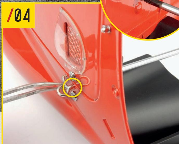
53-3 (ラッチ) を、2つのラッチレシーバーの間にある穴に挿入する。スプリング付きネジIをボディ裏側にある穴に差し込み、1mm程度の間隙が空くように固定する。
