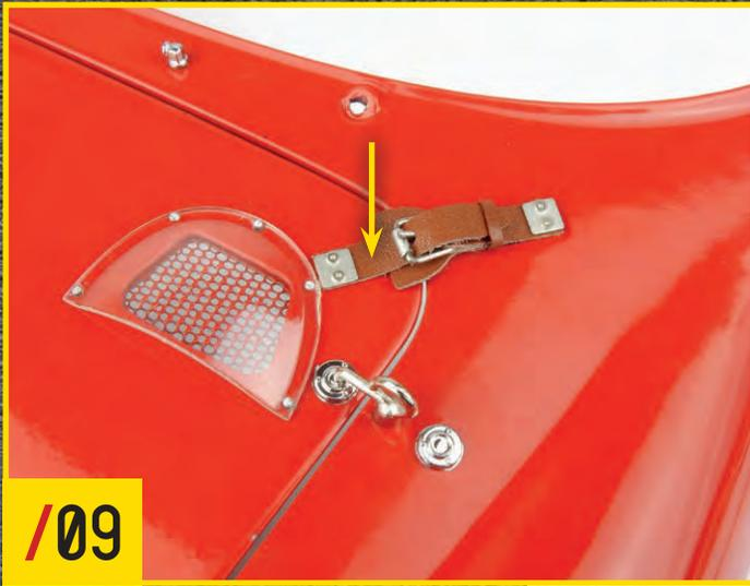
ストラップをボンネットに貼り付ける。左右の取り付けができたなら、ストラップをバックルから外し、ラッチを回してボンネットを開けることができる。
