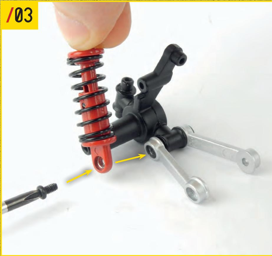
55-3(ショックアブソーバー)を取り付ける。写真のような向きに、ネジCで固定する。
