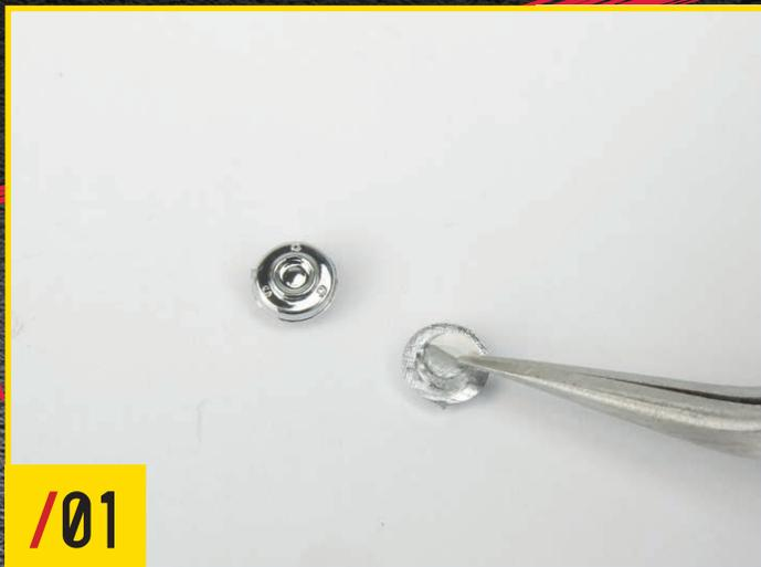
ボディのフロント左側にある穴に、写真のような向きでラッチレシーバー2つを挿入する。
