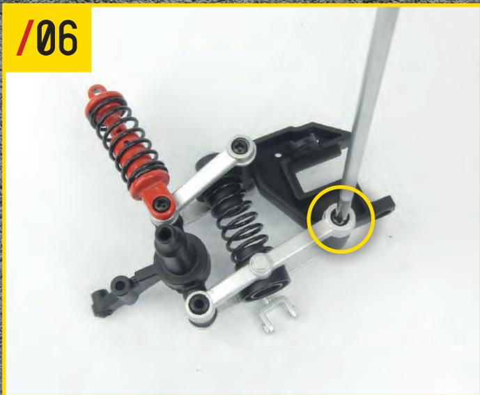
裏返して、56-5(ロアアームB:中央に穴がない)をはめ込む。アームの長い方の端がマウントに、短い端がスタブアクスルに向かうようにする。アーム中央にあるスタッドをキャップ裏側の穴に挿入し、写真のようにネジBでマウントに固定する。
