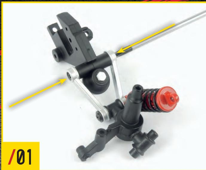
**STAGE 56** で作成したサスペンションと56-1(コネクティングマウント)を用意する。写真のように向きをそろえて、2本のネジBで両側から固定する。
