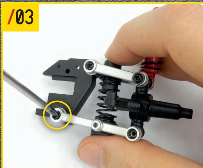
56-4(ロアアームA:中央に穴が開いている)を、写真のような向きに接続する。アームの長い方の端はマウントに、短い方の端はスタブアクスルに取り付ける。まず、ネジBでマウントに固定する。
