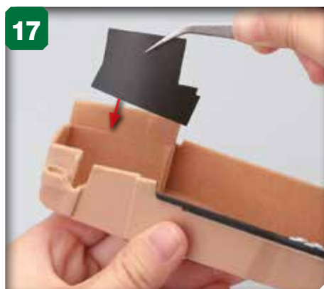
17 Décollez à présent l'autocollant A de la planche et alignez le bord le plus large et le cran du compartiment arrière (flèche).
