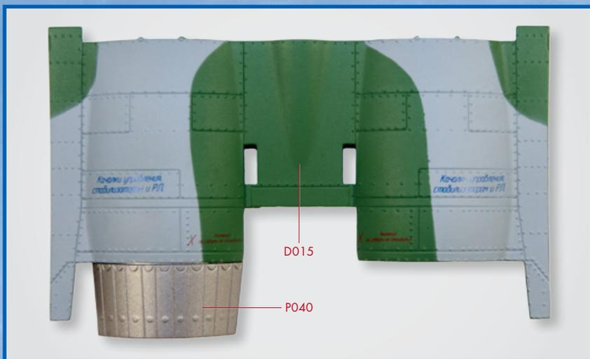
1 Prenez la buse de postcombustion gauche (P040) et placez-la à l'intérieur de la partie supérieure de la queue du fuselage (D015).
