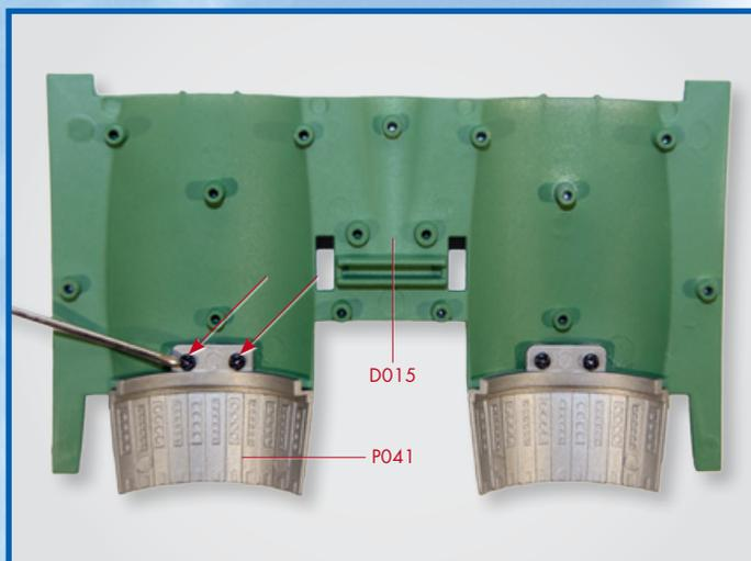
3 Positionnez maintenant la buse de postcombustion droite (P041) sur le côté droit du fuselage et fixez-la de l'intérieur avec deux vis CM.
