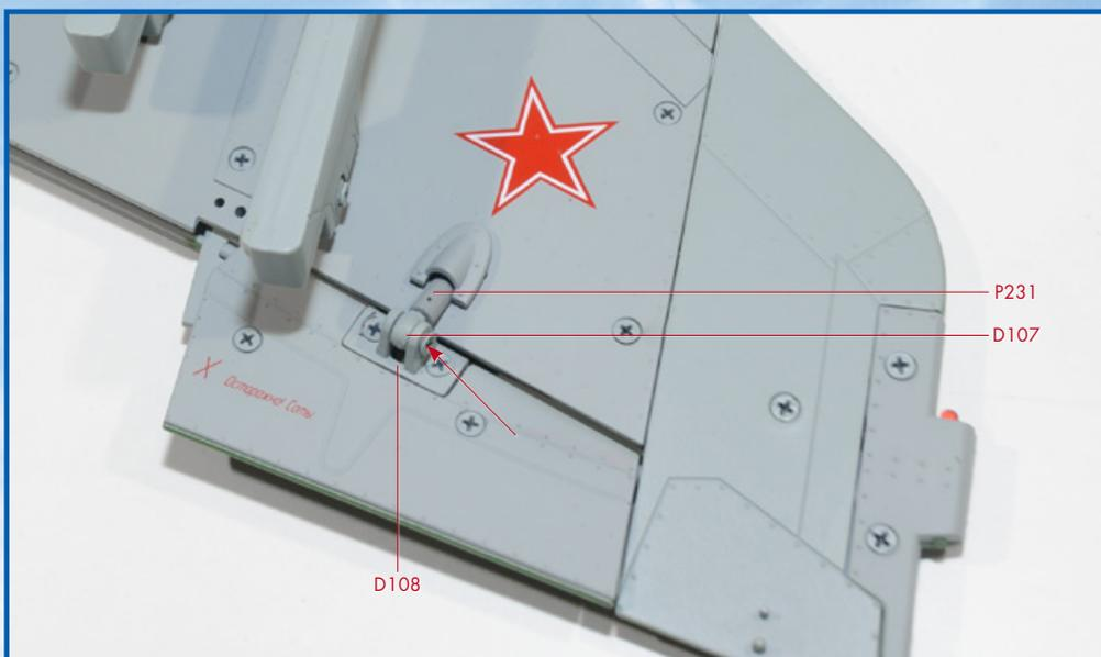
**5** Fixez maintenant l'extrémité de la tige sur la charnière à l'aide d'une vis QM.
