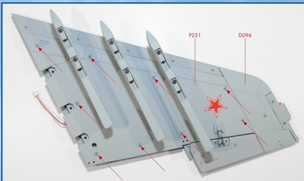
**4** Fixez le panneau sur l'aile à l'aide de neuf vis NM.
