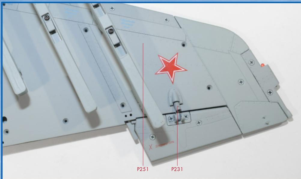
**3** Installez le panneau inférieur de l'aile gauche sur la structure de l'aile. Pour faciliter la procédure, nous suggérons de retirer le carénage afin que la tige glisse à travers l'aileron.
