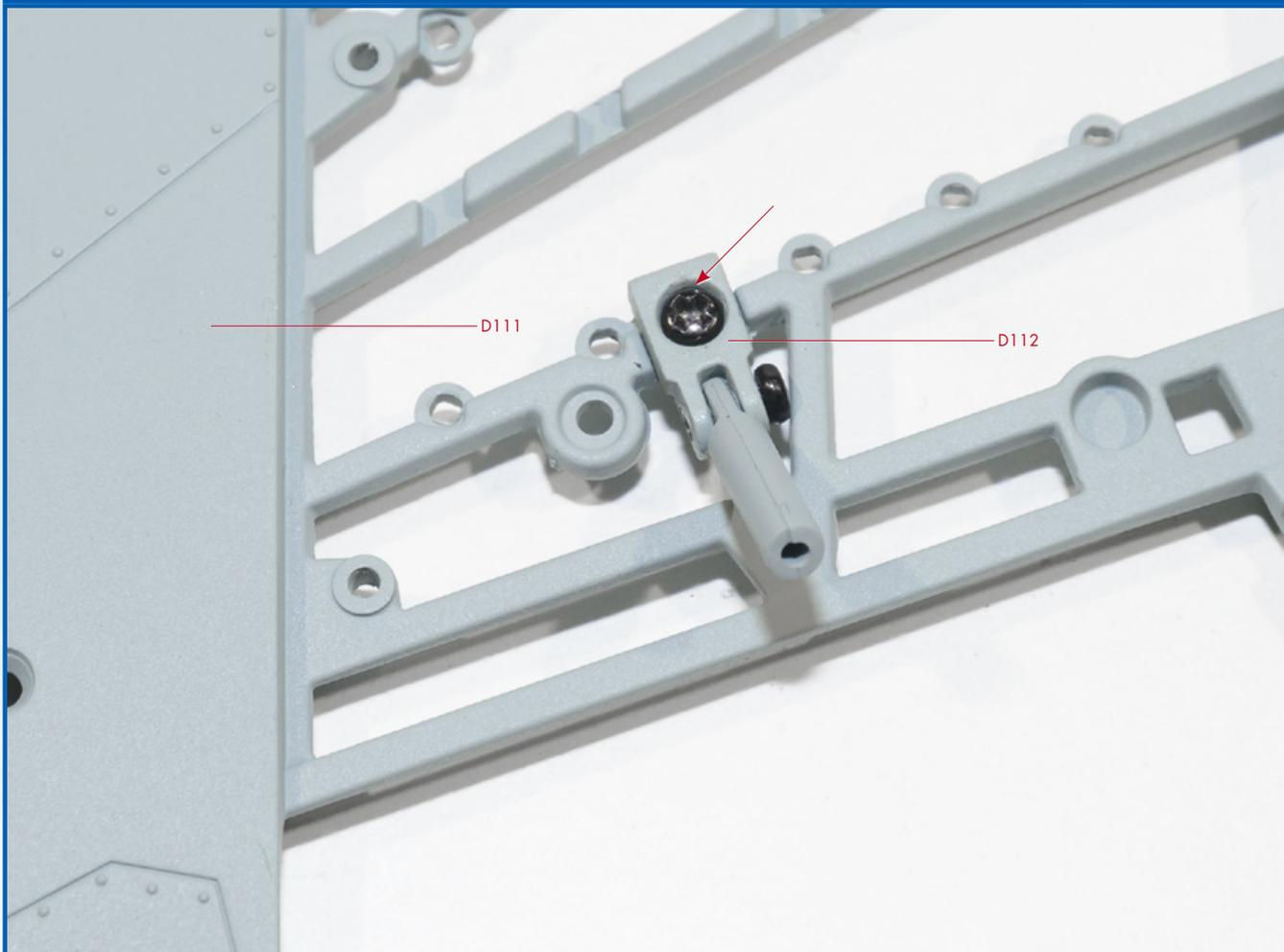
**2** Fixez la charnière sur le châssis de l'aile à l'aide d'une vis FM.
