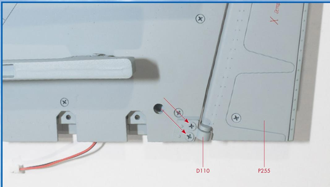
**4** Installez maintenant le logement de l'arbre (D110) sur l'arbre du volet et fixez-le à l'aile avec deux vis LP.
