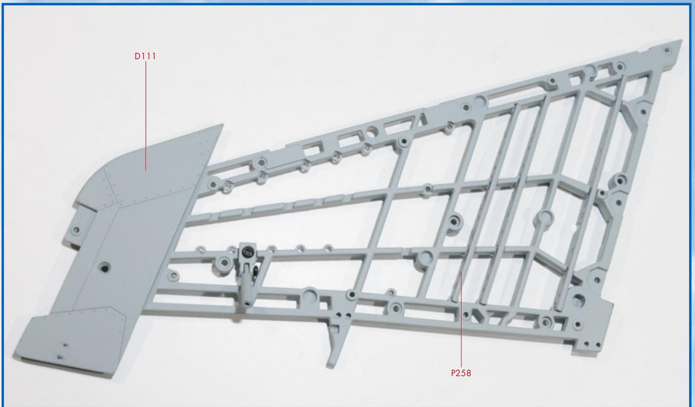
**3** Enfin installez la dernière nervure (P258) sur le châssis de l'aile droite.
