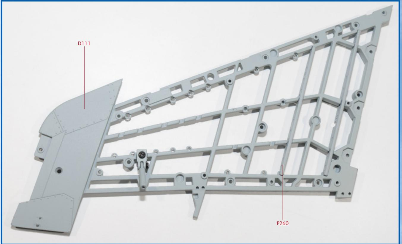
**2** Installez maintenant la deuxième nervure (P260) dans l'espace prévu sur l'aile droite.
