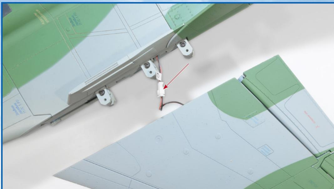
**5** Branchez les connecteurs électriques sur l'aile et le fuselage.
