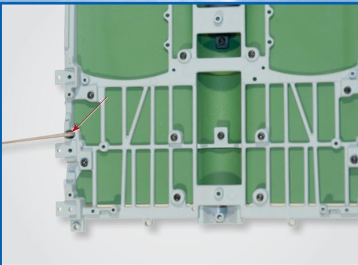
**4** Bloquez le lanceur de contre-mesures depuis l'intérieur de la structure avec deux vis BM.
