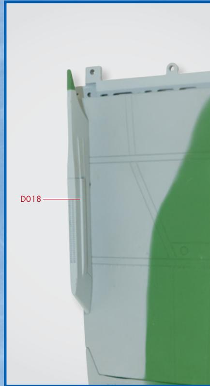
**3** Placez le lanceur de contre-mesures de droite (D018) sur les trous correspondants du côté droit du fuselage.
