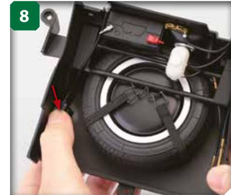
Appuyez sur le réservoir jusqu'à ce qu'il pénètre complètement à cet emplacement.
