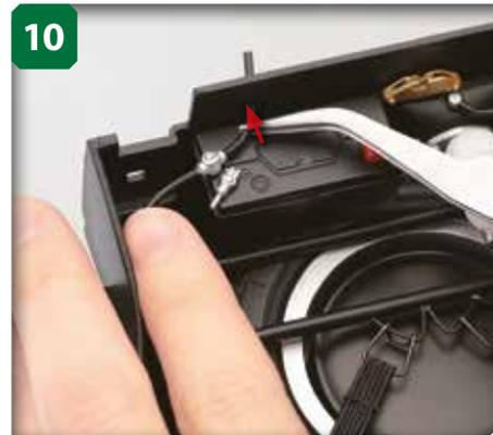
Introduisez la douille jusqu'à ce que l'union se trouve par dessus l'extrémité gauche de la batterie, comme sur l'image.
