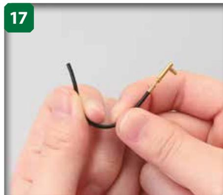
17 Prenez la douille du condensateur de la climatisation et pliez-la comme sur l'image. Pliez seulement la partie noire et veillez surtout à ne pas casser le joint entre la douille noire et la pièce dorée à l'extrémité.
