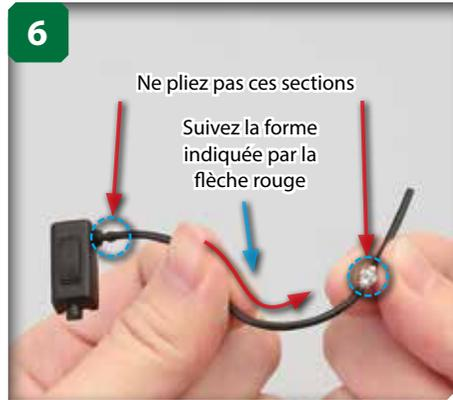
Prenez le réservoir du liquide de nettoyage du pare-brise (étape 26) et pliez la douille noire délicatement en suivant la forme de l'image ci-dessus. Veillez à ne pas couper la douille là où elle est reliée au corps du réservoir, ni au niveau de la fixation argentée près de l'extrémité libre car ce sont des points moins flexibles de la douille.
