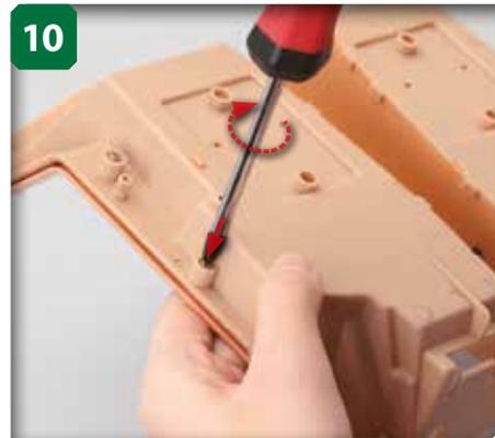
10 Introduisez une autre vis autoforeuse M2,3 x 6 mm dans l'autre trou et commencez à la serrer. Comme lorsque vous avez uni la console centrale de la cabine au sol, serrez les vis à tour de rôle, en ajoutant à chaque fois un demi-tour de vis, jusqu'à ce que l'espace entre le rebord et le sol de la cabine disparaisse.
