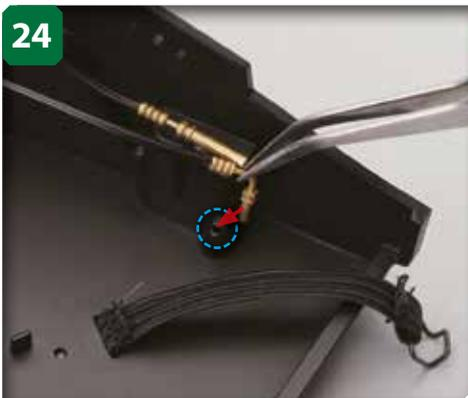
24 Insérez maintenant l'autre extrémité dans le trou cerclé. Cette fois la pince vous aidera à ne pas endommager la pièce. La pointe, là encore, n'entre facilement que si elle est correctement placée. Veillez donc à ne pas forcer.
