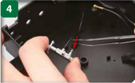
Prenez maintenant le maître-cylindre de frein (étape 25) avec votre pince et enfoncez le bout indiqué de la douille (pré-installée dans le compartiment avant) sur l'embout indiqué.
