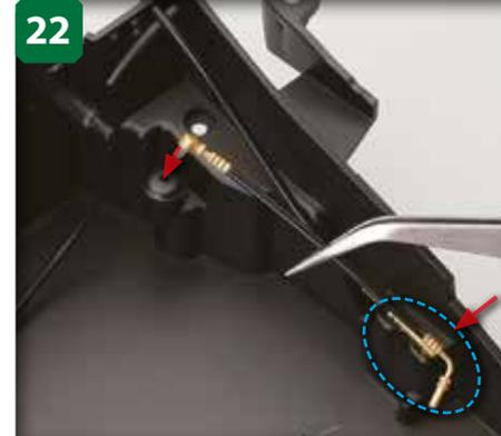
22 Prenez maintenant la douille du déshydrateur de la climatisation avec la pince et alignez les deux extrémités et les deux trous indiqués. Assurez-vous de bien placer la plus longue des extrémités dorées en L comme sur l'image.
