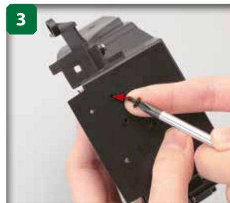
3 Retournez l'assemblage et introduisez une vis avec rondelle M2,3 x 5 mm dans le trou indiqué.
