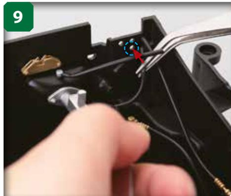
Vérifiez que l'extrémité du cylindre de la douille est totalement uni lorsque vous introduisez l'extrémité libre dans le trou.
