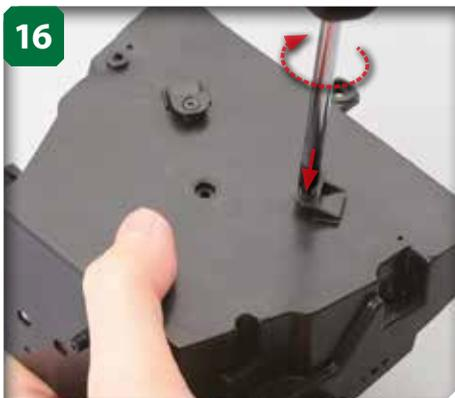
16 Fixez le butoir de la sangle avec une autre vis à tête fraisée M2 x 5 mm.
