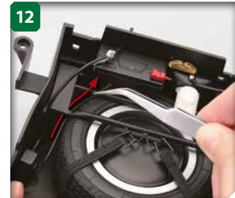
Passez l'extrémité libre du câble sous le cadre de châssis supérieur, en direction de la paroi finale du réservoir (flèche).
