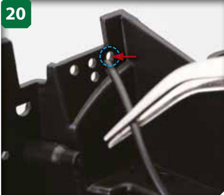
20 Introduisez maintenant l'extrémité noire de la douille dans le trou indiqué de la surface intérieure du compartiment avant. Assurez-vous de bien choisir le bon trou, celui montré sur l'image.
