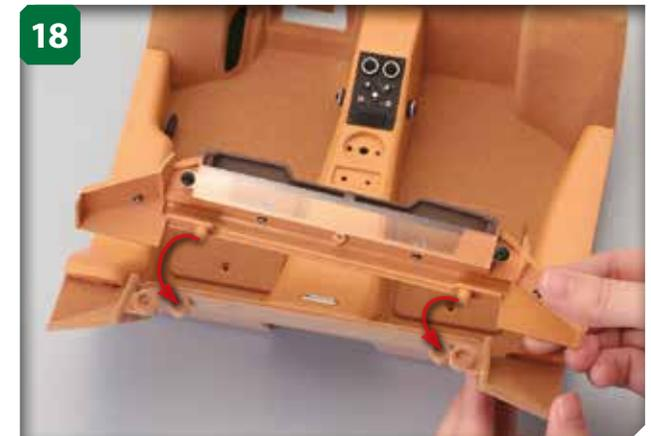
18 Prenez l'assemblage de la fenêtre arrière (étape 19) et alignez les saillants de chaque côté de la pièce et les trous sur l'arrière du sol de la cabine (flèches).
