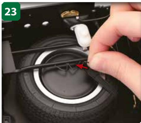
Tirez vers le haut l'une des sangles de la roue de secours, passez-la par dessus la roue et fixez-la dans la fermeture au centre du cadre de châssis supérieur.
