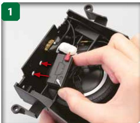
1 Placez la batterie sur le rebord intérieur du compartiment avant. Les deux saillants de fixation doivent entrer dans les trous indiqués.
