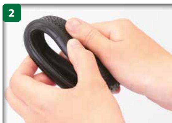
Une fois la garniture sortie appuyez sur le pneu plusieurs fois avec vos doigts pour le rendre plus malléable.
