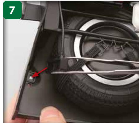
Introduisez le saillant de fixation du réservoir du liquide de nettoyage du pare-brise dans le trou indiqué sur le côté de la roue de secours. Ce sera plus facile avec une pince.
