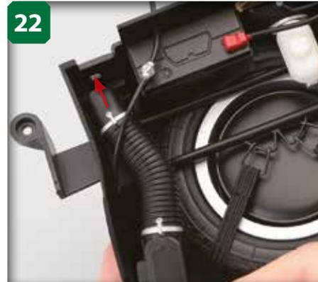
Enfoncez l'extrémité libre de la douille de l'appareil de chauffage dans le trou juste à côté de la batterie.
