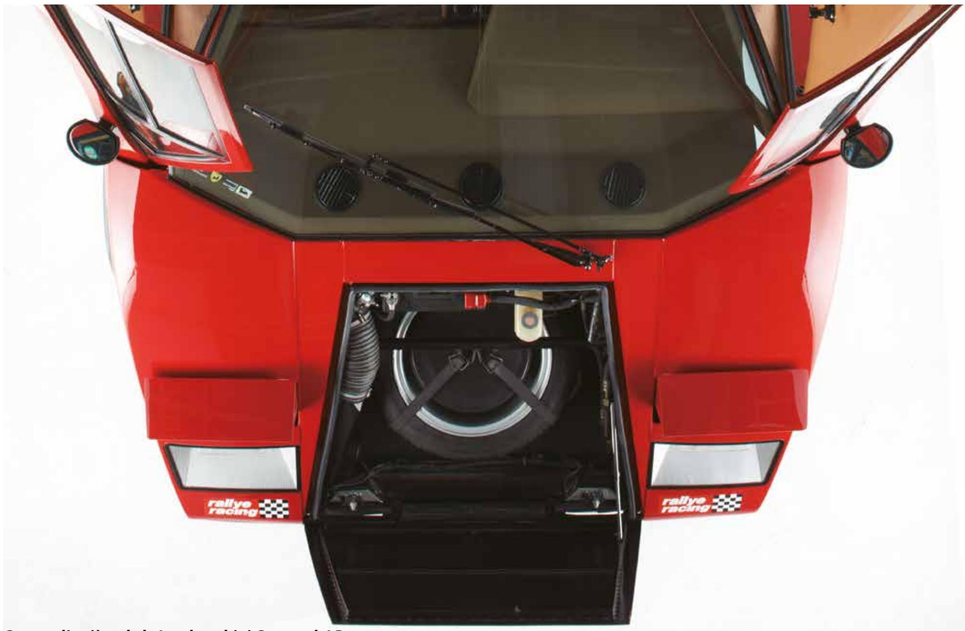
Comme l'arrière de la Lamborghini Countach LP 500S était entièrement réservée à l'imposant moteur V12, la roue de secours fut entreposée dans le compartiment avant.
