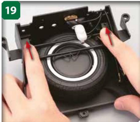
Tenez le cadre de châssis supérieur avec vos deux mains et enfoncez-le uniformément afin de l'introduire dans l'arrière du compartiment avant. Vous entendrez un clic lorsque la pièce s'assemble.
