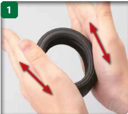
Faites tourner le pneu de secours entre vos mains pour le rendre plus malléable.
