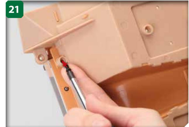
21 Introduisez une des vis autoforeuses M2,6 x 6 mm (étape 20) dans le trou indiqué.
