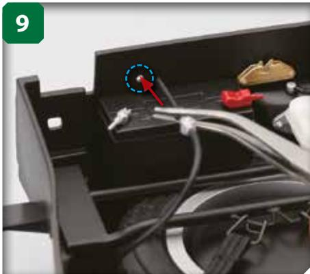
Introduisez avec une pince l'extrémité de la douille dans le trou indiqué, par dessus la roue de secours.
