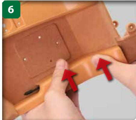
6 Poussez la partie centrale du rebord contre le sol de la cabine afin d'y fixer les languettes centrales.
