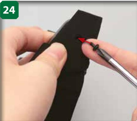
Tenez le ventilateur de l'appareil de chauffage en place. Retournez l'assemblage et introduisez une vis avec rondelle M2,3 x 5 mm dans le trou indiqué.
