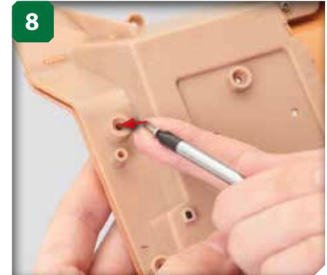
8 Retournez l'assemblage et introduisez une vis autoforeuses M2,3 x 6 mm (étape 20) dans le trou indiqué.
