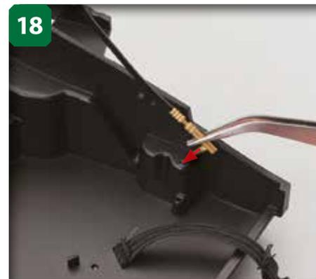
18 Introduisez avec une pince l'extrémité dorée de la douille dans le trou indiqué sur le côté de l'assemblage avant.
