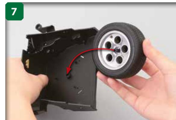
Prenez le compartiment avant (étape 23) et placez la jante de secours au centre. Le saillant du milieu de la jante doit s'assembler au point de fixation indiqué.
