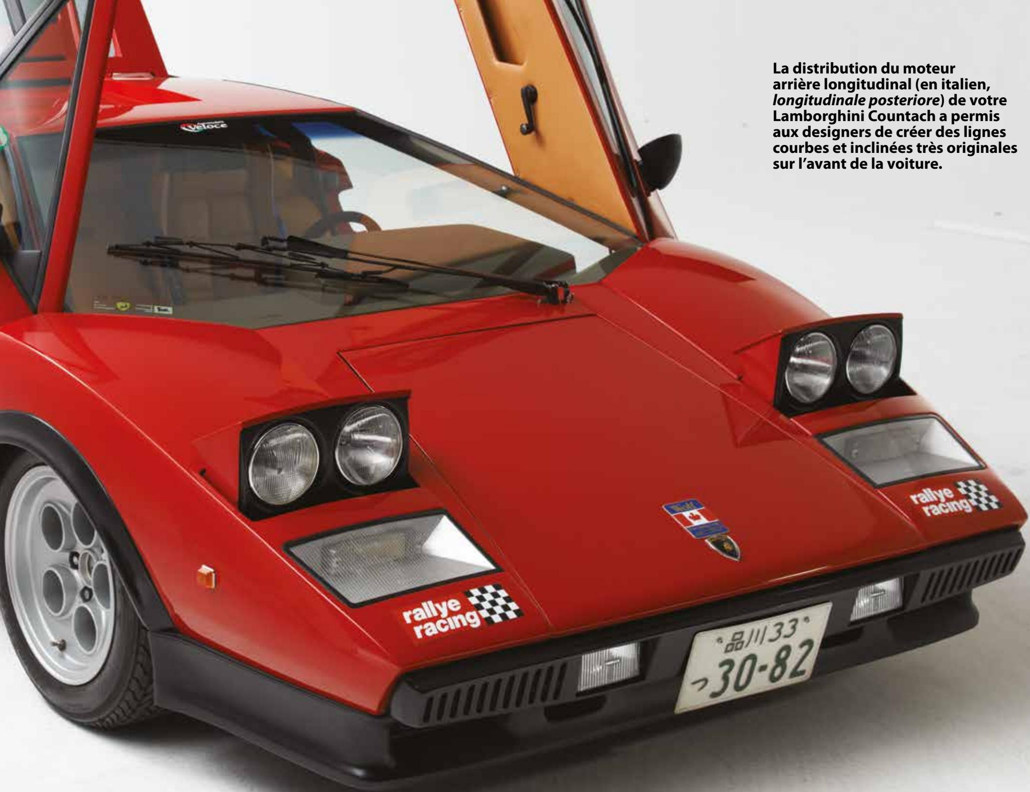
La distribution du moteur arrière longitudinal (en italien, *longitudinale posteriore*) de votre Lamborghini Countach a permis aux designers de créer des lignes courbes et inclinées très originales sur l'avant de la voiture.
