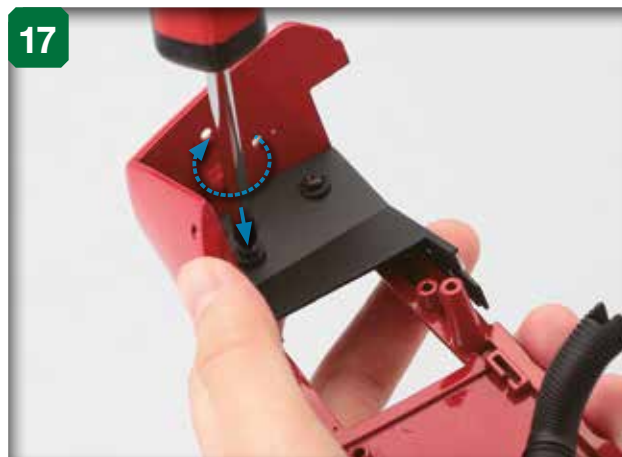
17 Serrez une deuxième vis de 2,6 x 6 mm dans l'autre orifice du déflecteur d'air chaud.
