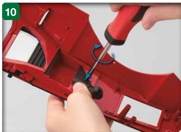
10 Serrez une vis 2,6 x 6 mm dans l'orifice de la douille du conduit d'air indiqué par la flèche.
