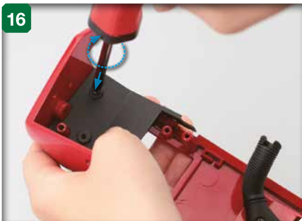
16 Serrez une vis 2,6 x 6 mm dans l'orifice indiqué.
