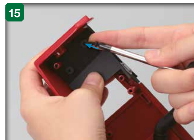
15 Serrez une vis 2,6 x 6 mm dans l'orifice du déflecteur d'air chaud, indiqué ci-dessus.
