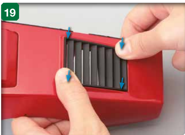
19 Enfoncez les lamelles de la sortie gauche une fois en place sur le boîtier de la jante arrière.
