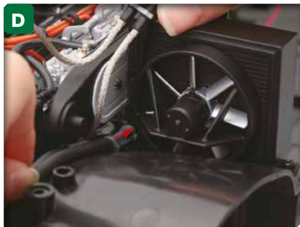
Enfoncez l'extrémité de la douille B dans cet orifice.
