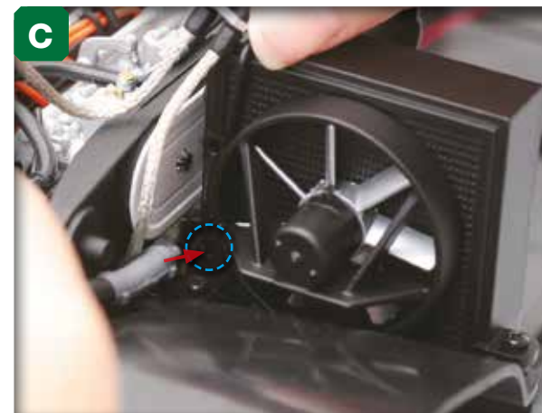
Soulevez légèrement le radiateur et alignez l'extrémité de la douille B et l'orifice inférieur.
