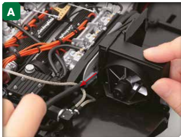
Tirez sur l'extrémité de la douille B afin de l'extraire de l'orifice supérieur du radiateur droit.
