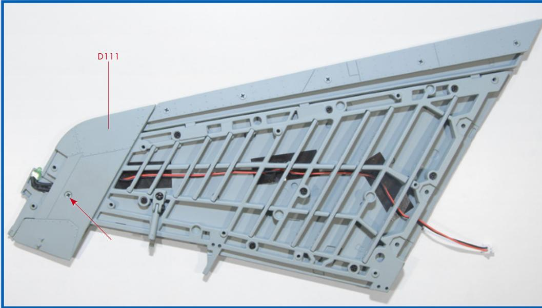
**6** Fixez maintenant l'extrémité du panneau avec une vis LP.
