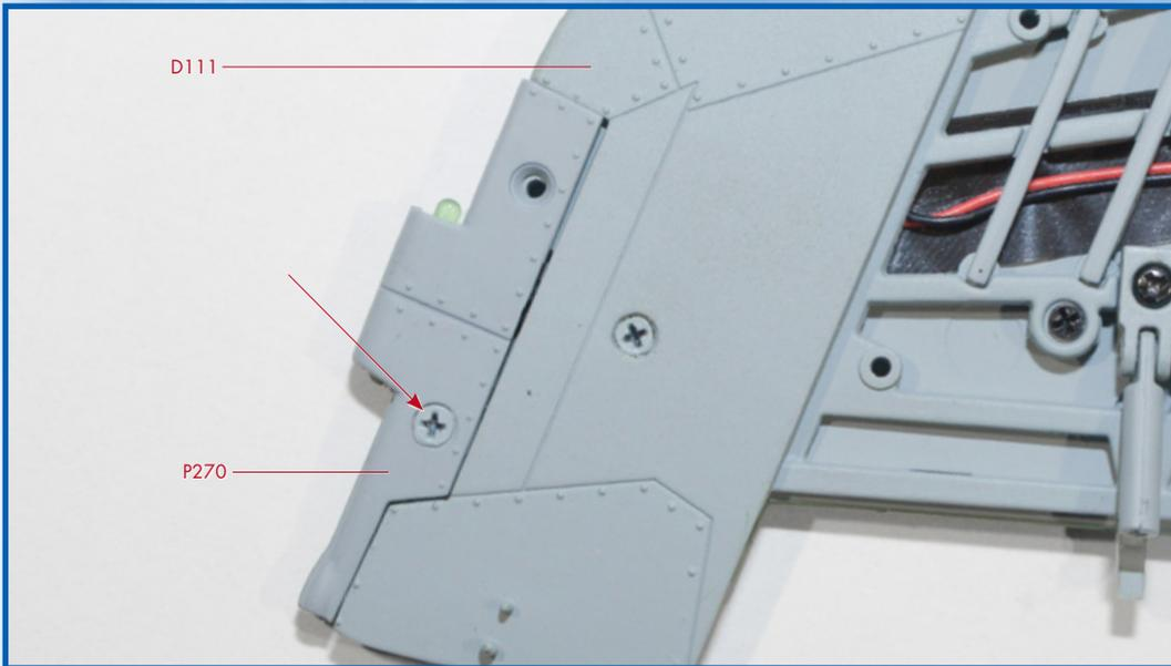
**7** Installez l'extrémité de l'aile inférieure (P270) sur le bord externe de l'aile et fixez-la avec une vis LP.
