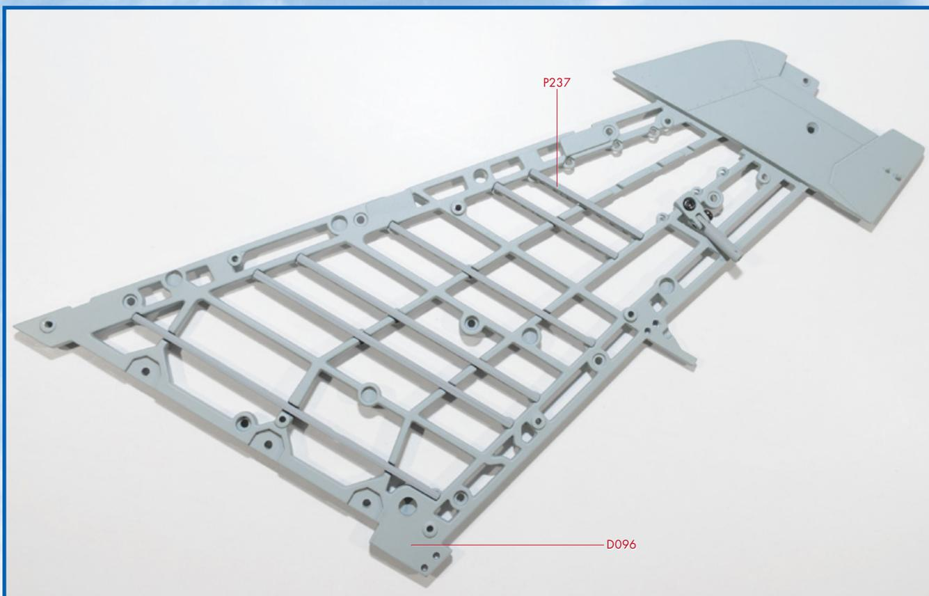
**3** Installez maintenant la nervure (P237) sur le longeron suivant du châssis de l'aile gauche.
