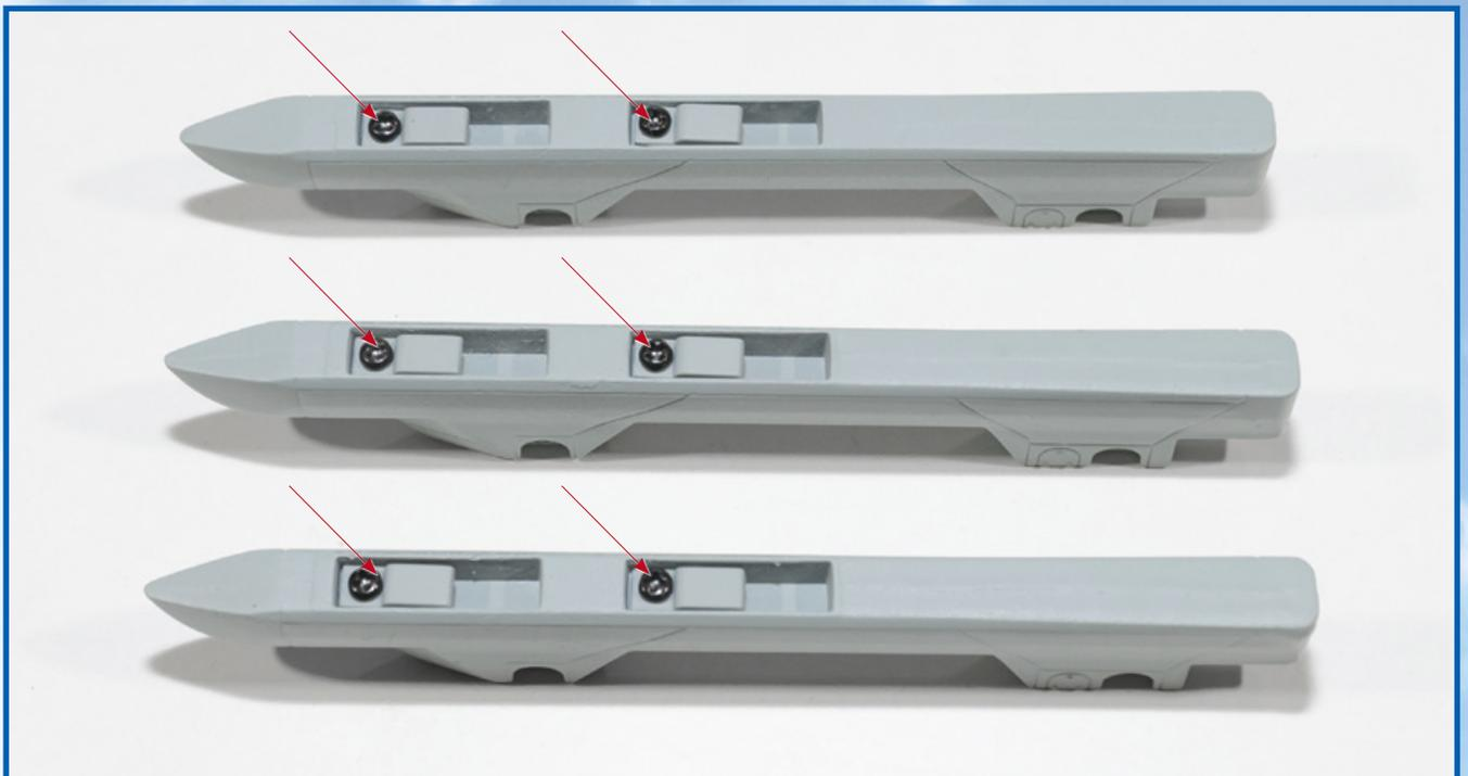
**2** Fixez les languettes aux pylônes d'aile à l'aide des vis MM.
