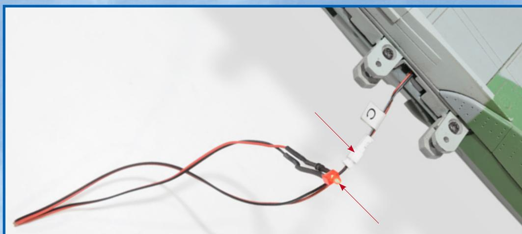
**4** Enclenchez le feu de navigation de l'aile gauche dans la borne marquée de la lettre C. Allumez le système électrique et vérifiez que la LED s'allume.
