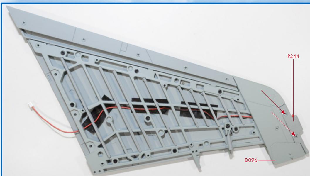
**8** Installez l'extrémité de l'aile inférieure gauche (P244) sur le bord latéral de l'aile et fixez-la avec deux vis SM.
