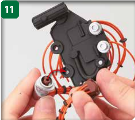
11 Comme dans le pas 7, alignez le deuxième jeu de câbles et le distributeur.
