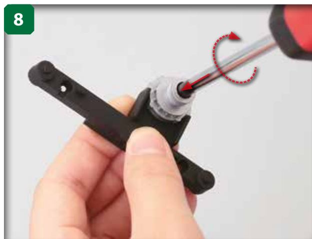
Serrez la vis en veillant à pouvoir toujours tourner le ventilateur avec le bout de vos doigts, mais tout en étant bien tenu.
