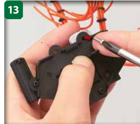
13 Retournez l'assemblage et introduisez-y la deuxième vis autoforeuse M2,3 x 6 mm de l'étape 8.
