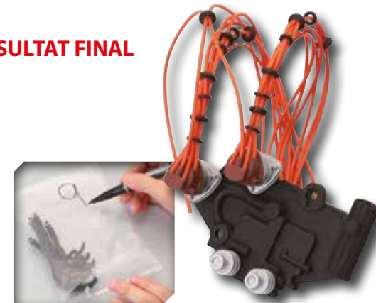
L'étape est terminée et les deux distributeurs, ainsi que leurs câbles à haute tension, sont montés sur le carter d'huile. Conservez toutes les pièces en lieu sûr pour plus tard et assurez-vous de placer toutes les pièces non utilisées dans un sac plastique refermable sur lequel vous marquez le numéro de l'étape afin de le retrouver facilement plus tard.
