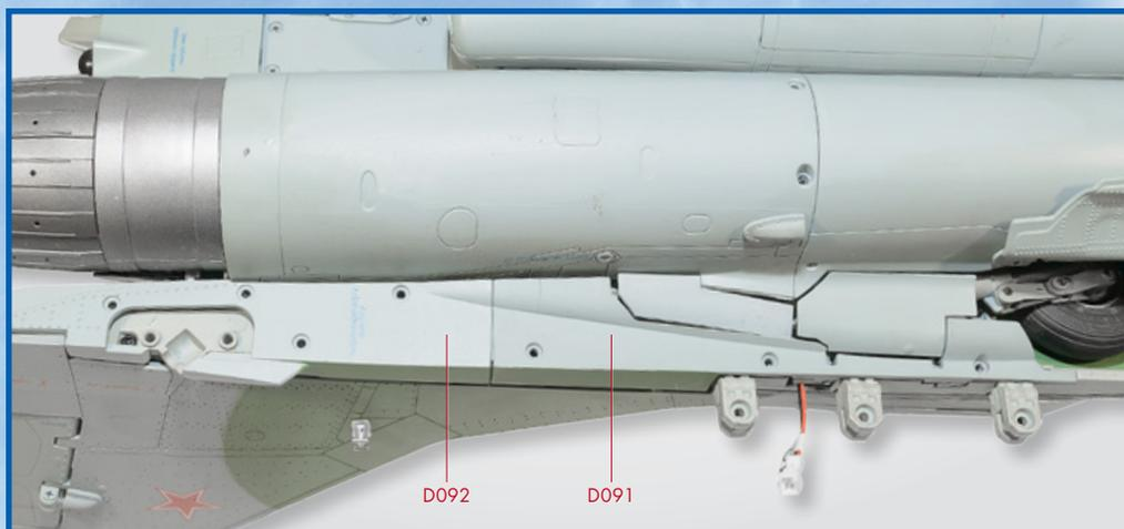
**6** Fixez les panneaux avec cinq vis DM et deux vis HM.
