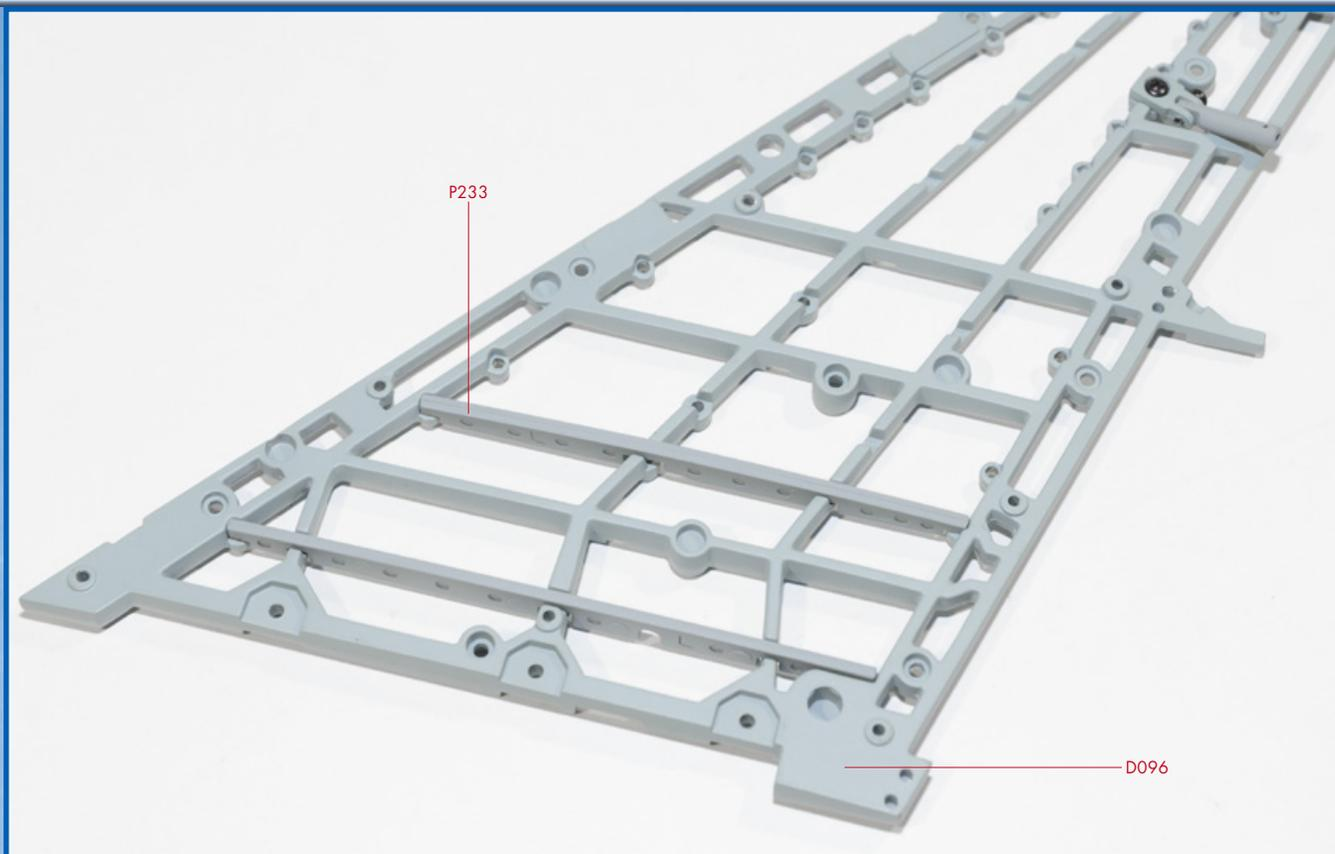
**2** Installez maintenant la nervure (P233) sur les longerons adjacents du châssis de l'aile.
