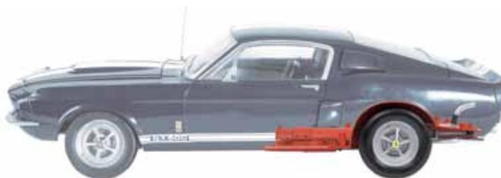
Cette composition virtuelle des éléments du châssis assemblés jusqu'à maintenant montre la position du garde-boue, pièce qui sera ultérieurement recouverte par la carrosserie.
