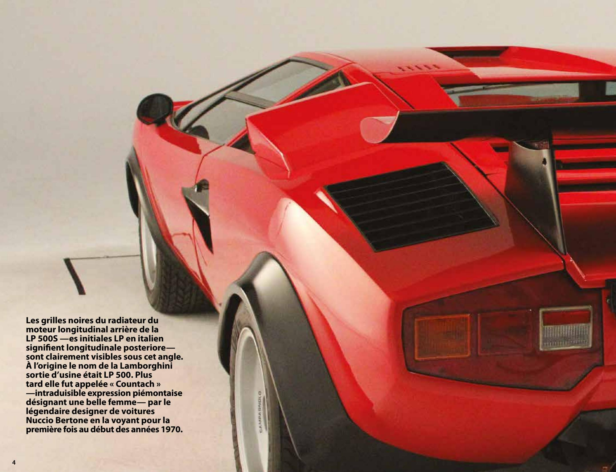
Les grilles noires du radiateur du moteur longitudinal arrière de la LP 500S —es initiales LP en italien signifient longitudinale posteriore— sont clairement visibles sous cet angle. À l'origine le nom de la Lamborghini sortie d'usine était LP 500. Plus tard elle fut appelée « Countach » —intraduisible expression piémontaise désignant une belle femme— par le légendaire designer de voitures Nuccio Bertone en la voyant pour la première fois au début des années 1970.
