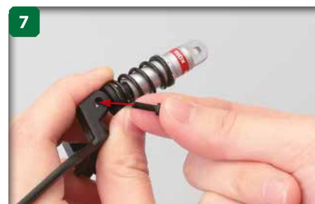
7 Introduisez l'une des vis M2,3 x 8,5 mm non utilisée dans l'étape 30 dans l'orifice indiqué.
