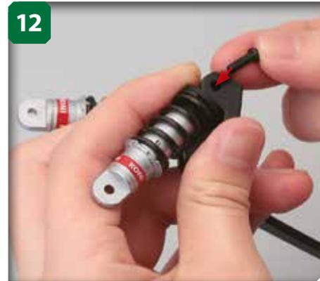
12 Introduisez une vis M2,3 x 8,5 mm dans l'orifice indiqué.
