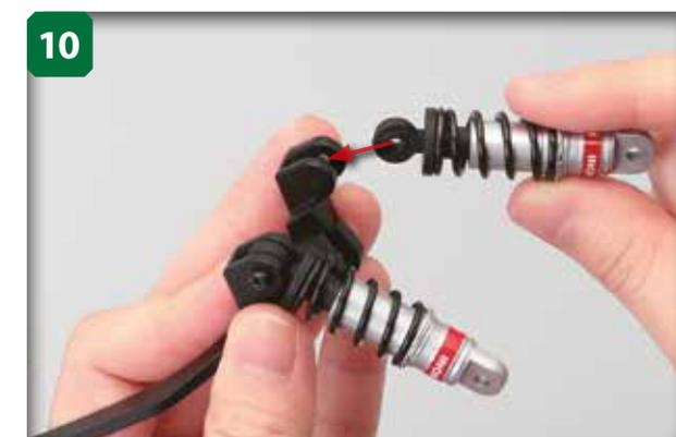
10 Introduisez alors le deuxième amortisseur arrière dans l'encoche laissée libre du même côté du support, en suivant la flèche rouge.
