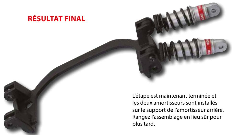
L'étape est maintenant terminée et les deux amortisseurs sont installés sur le support de l'amortisseur arrière. Rangez l'assemblage en lieu sûr pour plus tard.
