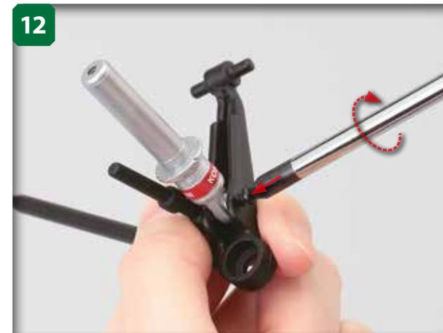
Tenez les deux pièces ensemble et serrez la vis avec votre tournevis, à peu près sur un tour complet. Vérifiez en même temps qu'elle entre correctement dans le trou de la petite bielle de la barre de stabilisation.
