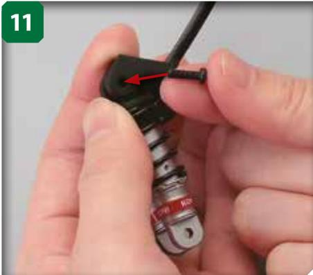
11 Répétez les pas 6 à 8 afin d'introduire une autre vis M2,3 x 8,5 mm dans l'orifice indiqué.
