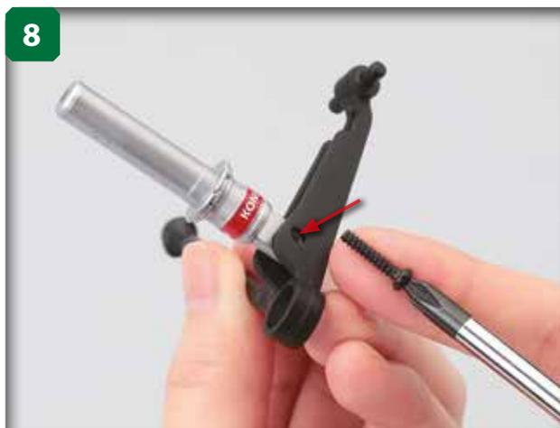
Introduisez une des vis autoforeuses M2,6 x 12 mm dans l'orifice indiqué sur le côté indiqué ci-dessus.
