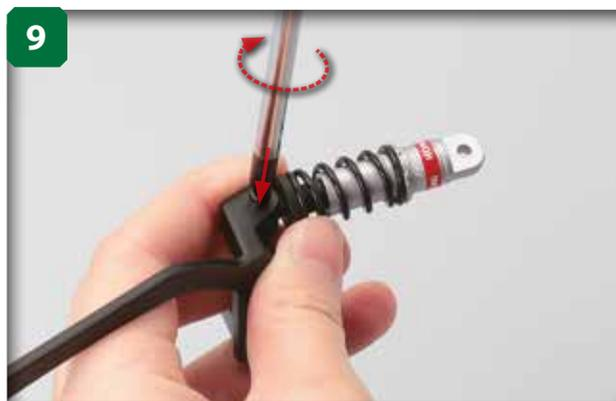
9 Tenez le tournevis sur l'orifice se trouvant sur le côté le plus éloigné. Serrez la vis jusqu'à ce que vous ressentiez une certaine résistance. Ne serrez pas trop la vis.
