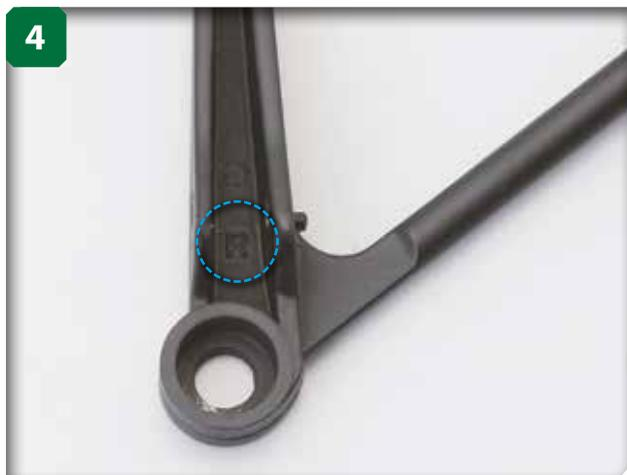
Le bras de suspension avant inférieur droit est identifié par la lettre R dessous (cercle). Cela vous permet de le distinguer du bras de suspension avant gauche, sur lequel il y a un L.
