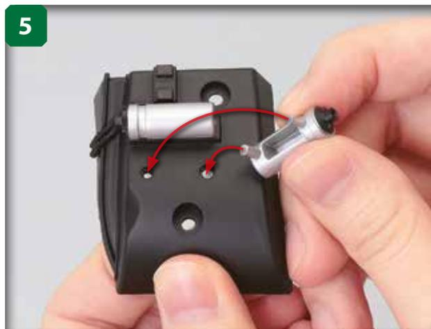
Alignez la deuxième bobine et les orifices indiqués de la partie supérieure du support.
