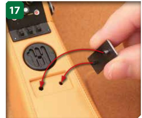
Assemblez maintenant le cendrier (fourni également dans l'étape 27) dans l'intérieur de l'encoche rectangulaire sous la base du levier de la boîte de vitesses.
