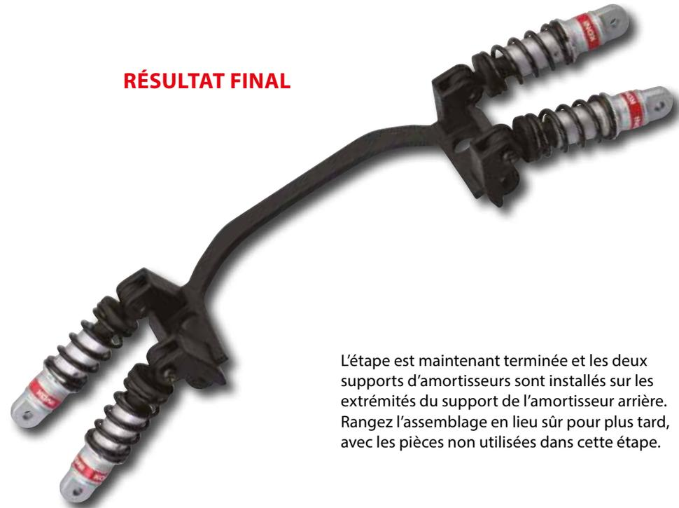
L'étape est maintenant terminée et les deux supports d'amortisseurs sont installés sur les extrémités du support de l'amortisseur arrière. Rangez l'assemblage en lieu sûr pour plus tard, avec les pièces non utilisées dans cette étape.
