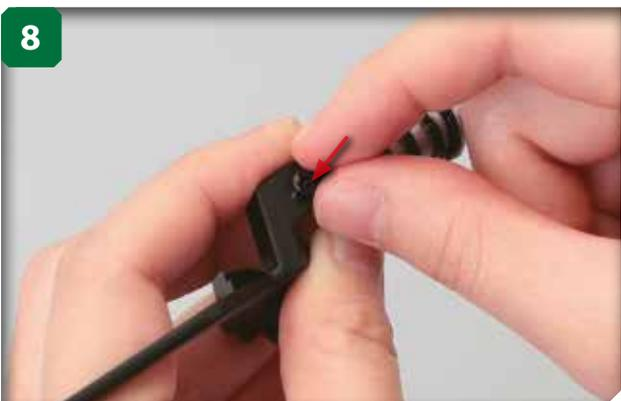
8 Enfoncez la vis à travers l'orifice en le passant à travers l'extrémité de l'amortisseur et dans l'orifice postérieur possédant déjà un pas de vis.
