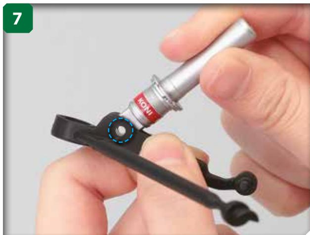
Alignez les orifices des deux pièces destinés à la vis.
