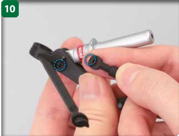
Alignez à présent la petite bielle de la barre de stabilisation et l'extrémité visible de la vis. Le saillant et l'encoche cerclé en bleu vous aideront à fixer la pièce au bon endroit.
