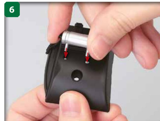
Placez la bobine à l'intérieur des orifices.
