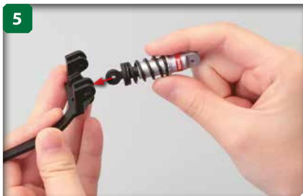
5 Prenez l'assemblage du support des amortisseurs arrière et encochez le premier amortisseur dans la rainure indiquée.
