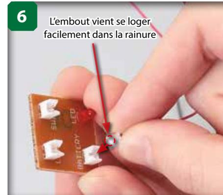
Situez le connecteur du boîtier des piles près de la prise indiquée par le mot BATTERY. La forme du connecteur est adaptée à celle de la prise afin que les deux pièces s'assemblent aisément. Ne forcez pas.
