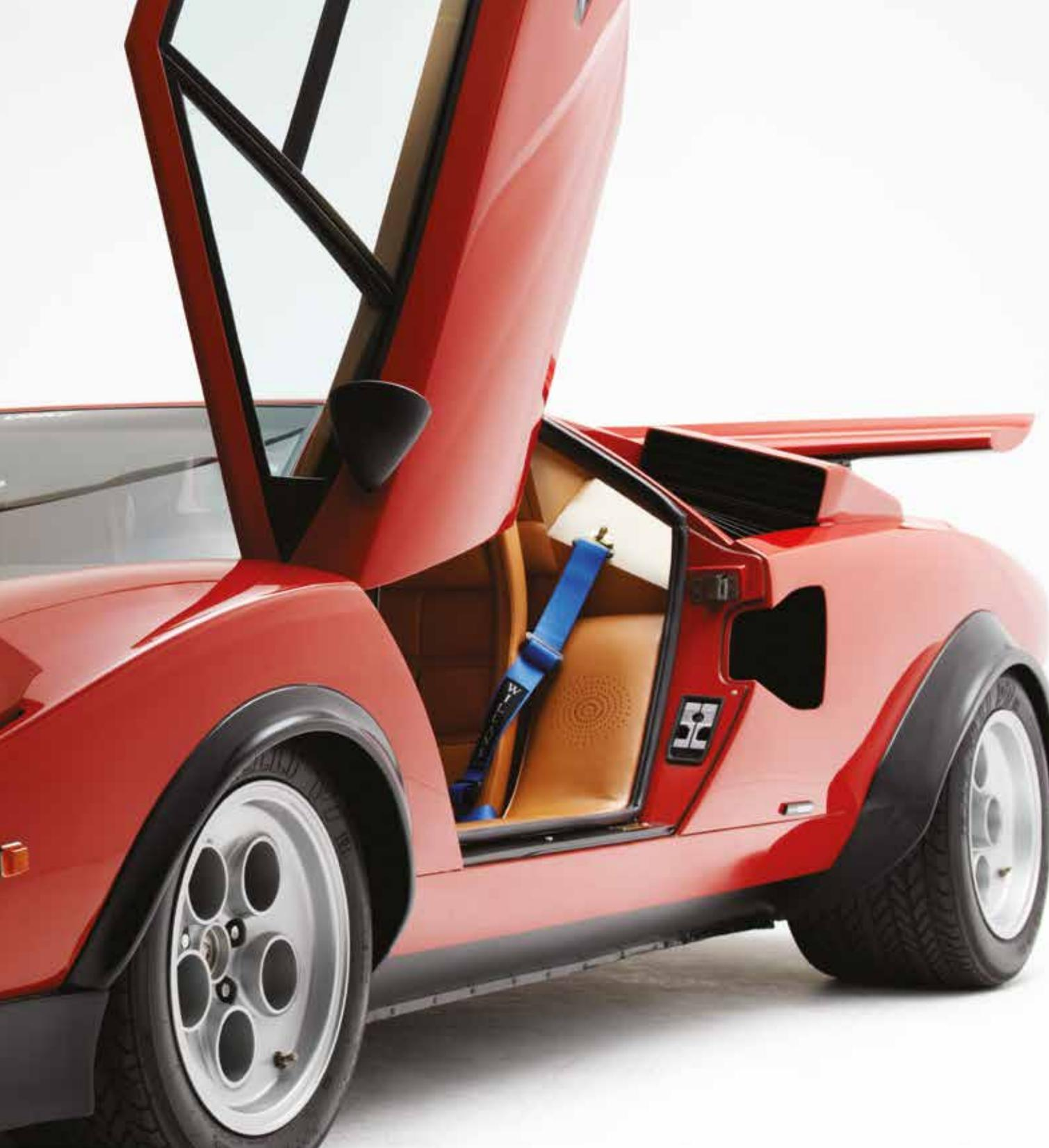
**Quoique spectaculaire, le design iconique des portes papillon de la Lamborghini Countach est en réalité fort simple. La charnière est placée en dessous et légèrement devant le rétroviseur latéral, tandis que le support hydraulique servant à relever la porte et la tenir ouverte (à peine visible sur cette image) est placé un peu plus bas, à l'intérieur de la porte même.**
