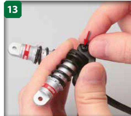
13 Enfoncez-la avec vos doigts pour qu'elle passe à travers le support et arrive jusqu'à l'orifice ayant un pas de vis, à l'arrière.
