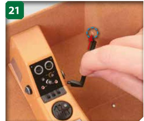
Introduisez maintenant la pointe indiquée à l'intérieur du repose-pied du passager, dans l'orifice cerclé en bleu.
