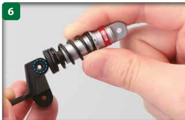
6 Ajustez l'amortisseur afin d'aligner les orifices cerclés, les laissant découverts.
