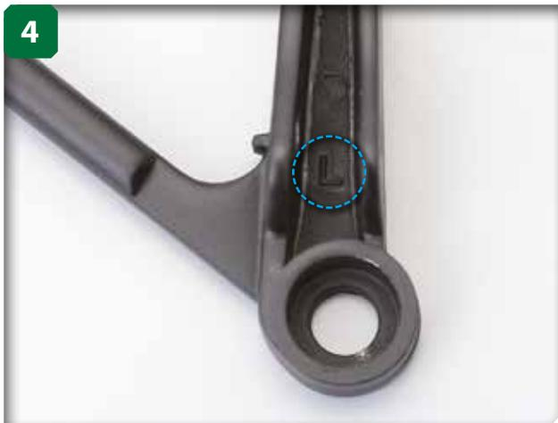
Le bras de suspension avant inférieur gauche est identifié par la lettre L, en dessous (cercle). Cela vous permet de le distinguer du bras de suspension avant droit, sur lequel il y a un R.
