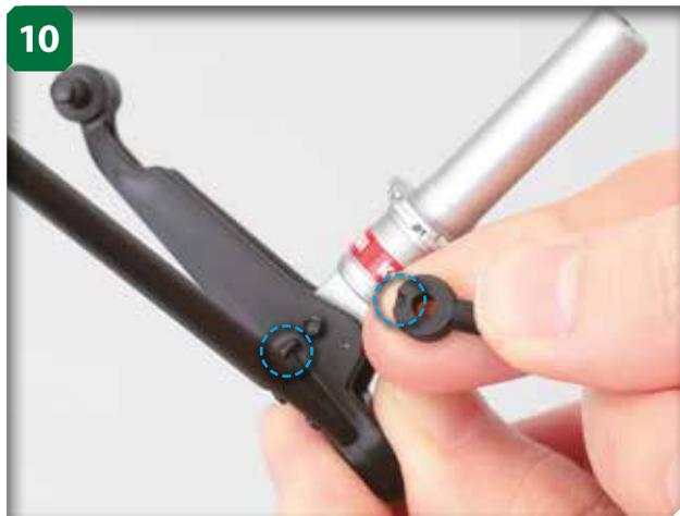
Alignez à présent la petite bielle de la barre de stabilisation et l'extrémité visible de la vis. Le saillant et l'encoche cerclées en bleu vous aideront à fixer la pièce au bon endroit.
