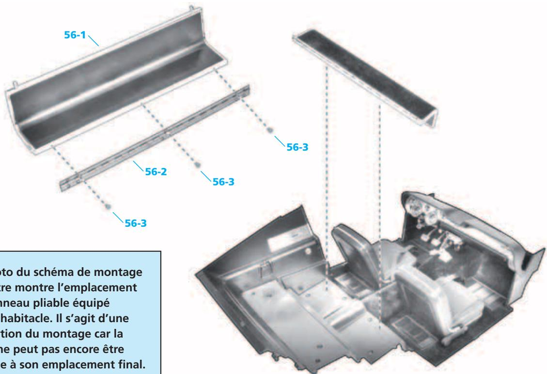
La photo du schéma de montage ci-contre montre l'emplacement du panneau pliable équipé dans l'habitacle. Il s'agit d'une simulation du montage car la pièce ne peut pas encore être montée à son emplacement final.
