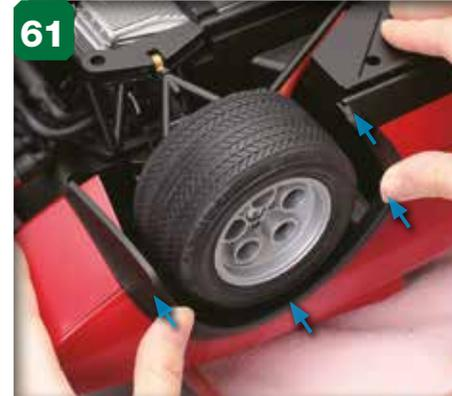
61 Enfoncez le garde-boue arrière gauche une fois en place. Recommencez pour assembler le garde-boue arrière droit dans la protection de la jante arrière droite.
