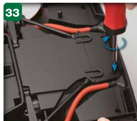
33 Serrez à moitié la vis 2,6 x 6 mm restante dans l'orifice indiqué à l'avant du bas de la voiture. Une fois toutes les vis des pas 30 à 33 installées, serrez-les complètement.
