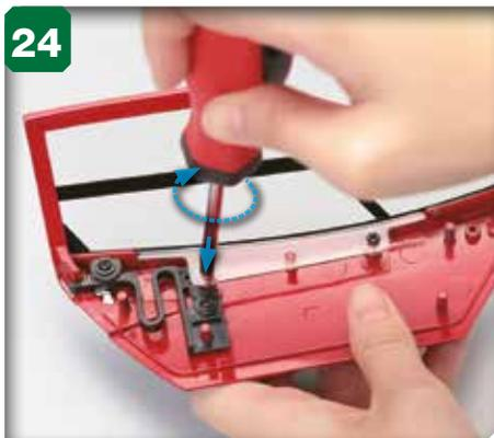
24 Serrez à moitié la deuxième vis 2,6 x 6 mm dans l'orifice à l'arrière de la fenêtre. Lorsque les deux sont installées et que la fenêtre est correctement placée, serrez-les complètement.
