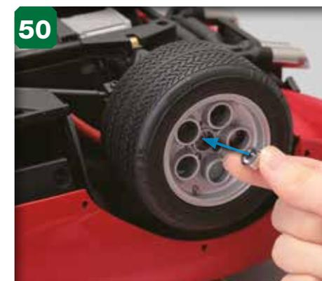
50 Prenez l'un des boutons des jantes (étapes 1, 5, 12 et 17) et placez-le sur l'essieu arrière et l'orifice central de la jante.
