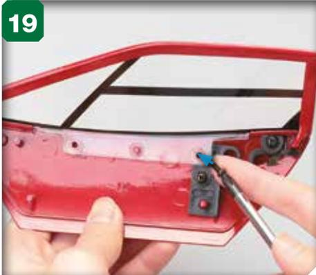
19 Introduisez une vis 2,6 x 6 mm dans l'orifice à l'avant de la fenêtre (flèche).
