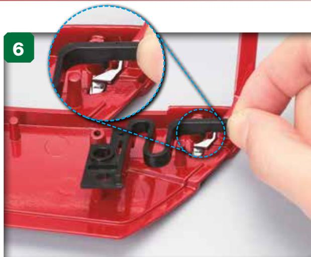
6 Avant d'installer la pièce A de la serrure introduisez le saillant à l'intérieur (agrandissement) dans l'orifice de la serrure.
