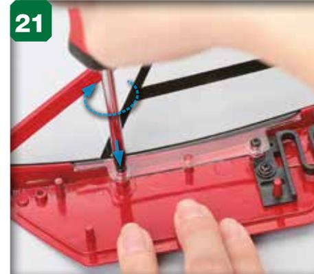
21 Serrez à moitié la deuxième vis 2,6 x 6 mm dans l'orifice à l'arrière de la fenêtre. Lorsque les deux sont installées et que la fenêtre est correctement installée, serrez-les complètement.
