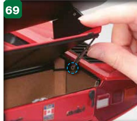
Dépliez le support du capot et alignez l'orifice de l'extrémité et celui de la protection de la jante droite.
