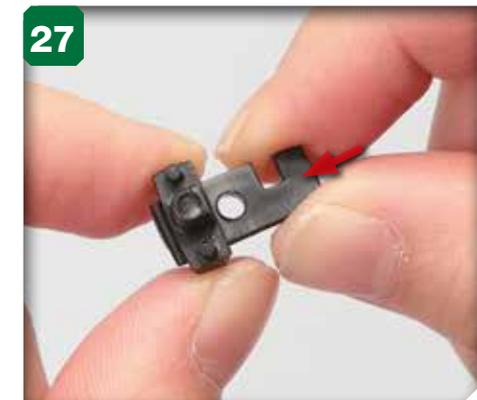
27 Passez l'extrémité du support dans la rainure de la charnière. Poussez jusqu'à atteindre la position montrée ci-dessus.
