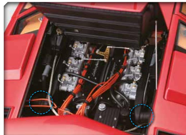
Insérez les douilles des conduits d'air (cerclés) dans les filtres à air gauche et droit.
