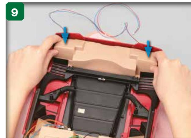
9 Faites descendre le compartiment arrière sur l'arrière de l'assemblage principal. Dégagez les LED à l'arrière pour qu'elles ne gênent pas.
