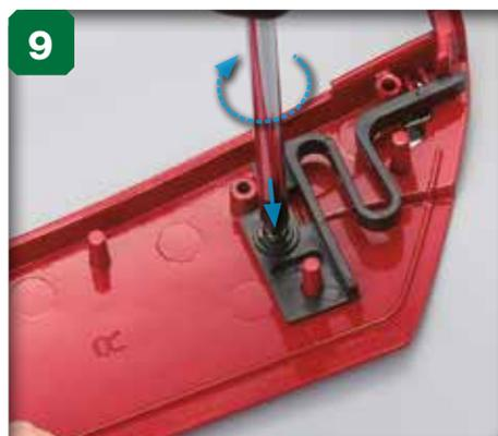
9 Serrez la vis dans l'orifice.
