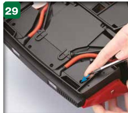
29 Introduisez une vis 2,6 x 6 mm dans l'orifice indiqué à l'avant du bas de la voiture.
