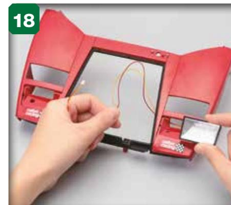
18 Retournez le garde-boue avant. Passez le connecteur du clignotant avant gauche (étape 70) dans l'orifice avant gauche sous le garde-boue avant.
