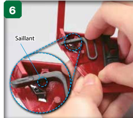
6 Avant d'installer la pièce A de la serrure, introduisez le saillant à l'intérieur (cerclé) dans l'orifice de la serrure.
