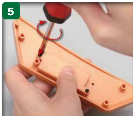
5 Serrez une deuxième vis autoforeuse 2,3 x 6 mm dans l'orifice de l'autre côté du panneau intérieur. Serrez ensuite complètement la première vis.
