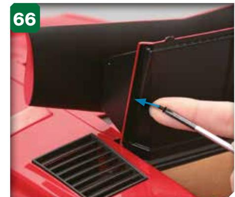
66 Tout en tenant l'aile arrière en place, soulevez le capot du compartiment arrière et introduisez une vis autoforeuse 2 x 5 mm dans l'orifice indiqué.
