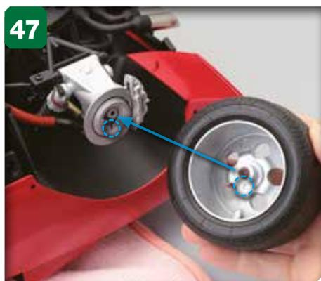
47 Tenez une des roues arrière en alignant le saillant et l'encoche sur le disque de frein, puis assemblez la roue sur le disque.
