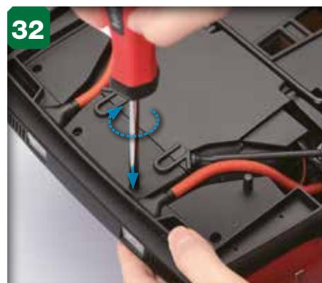
32 Serrez à moitié une vis 2,6 x 6 mm dans l'orifice indiqué ci-dessus.
