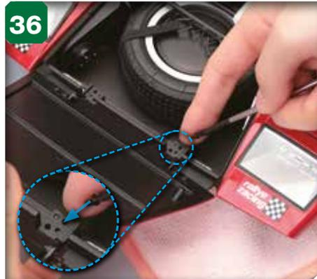
**36** Introduisez une vis 1,7 x 3 mm dans l'orifice indiqué sur l'agrandissement.
