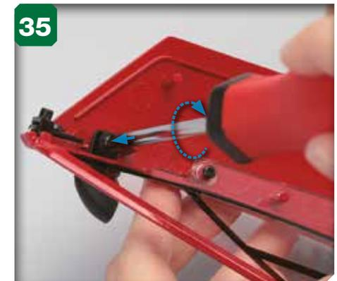
35 Serrez la vis dans l'orifice.
