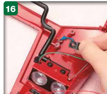
16 Alignez l'orifice de la charnière de la serrure droite et le saillant indiqué du garde-boue.
