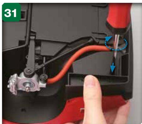
31 Serrez à moitié une vis 2,6 x 6 mm dans l'orifice du côté opposé du bas de la voiture.
