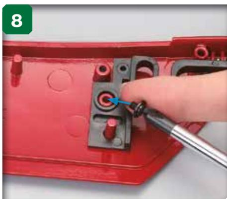
8 Introduisez une vis à rondelle 2,6 x 3 mm (étape 74) dans l'orifice indiqué ci-dessus.
