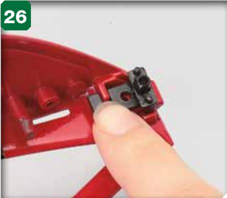
Enfoncez le support de la charnière sous le saillant et ajustez-en la position afin d'aligner l'orifice du support et celui de la portière.
