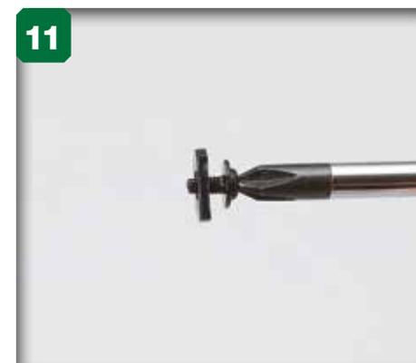
11 Faites tourner la vis à rondelle jusqu'à ce qu'elle dépasse d'1 mm environ de l'autre côté.
