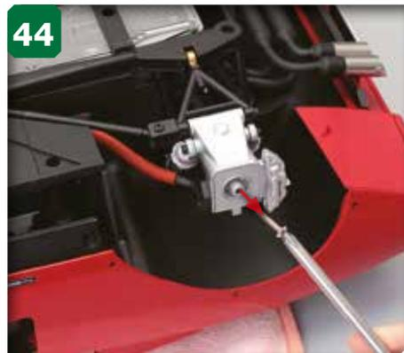
44 Retirez l'essieu du moyeu de la roue arrière droite.
