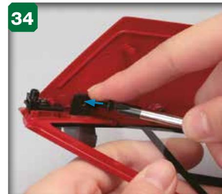
34 Retournez la portière et introduisez une vis à rondelle 2,6 x 5 mm (étape 74) dans l'orifice de la languette du rétroviseur.
