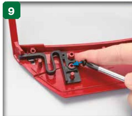
9 Introduisez une vis à rondelle 2,6 x 3 mm (étape 74) dans l'orifice indiqué ci-dessus.
