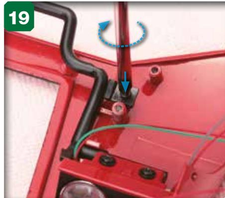
**19** Serrez la vis dans l'orifice.
