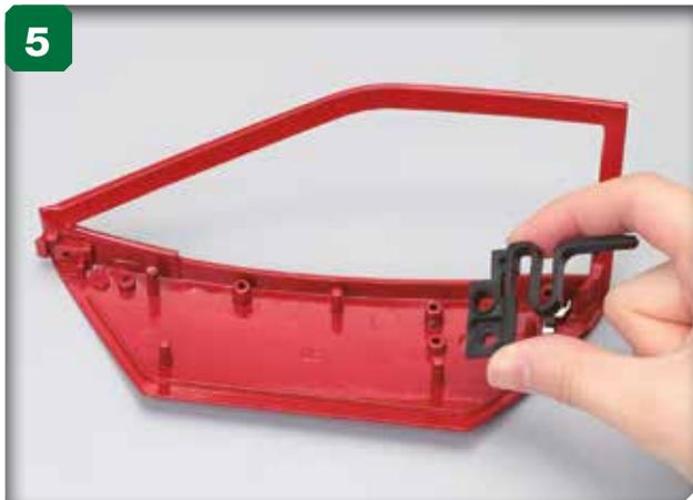
5 Aligned les ouvertures de la pièce A de la serrure de la portière (étape 77) et les saillants indiqués à l'intérieur de la portière droite.
