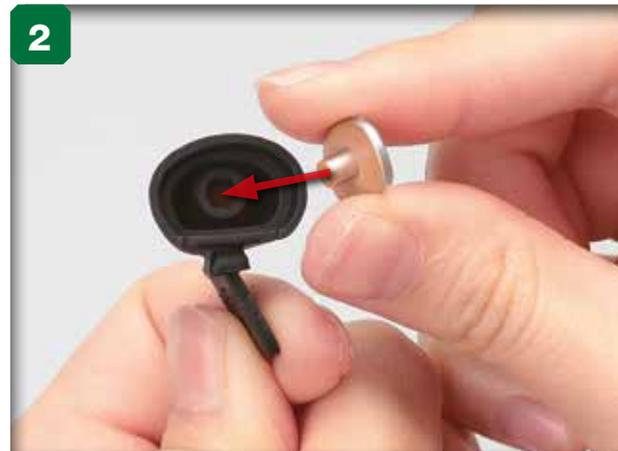
2 Alignez le saillant au revers du support du miroir droit et l'orifice au centre de la protection du rétroviseur droit.
