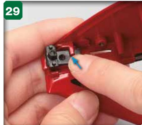
29 Enfoncez le support de la charnière sous le saillant et ajustez-en la position afin d'aligner l'orifice du support et celui de la portière.
