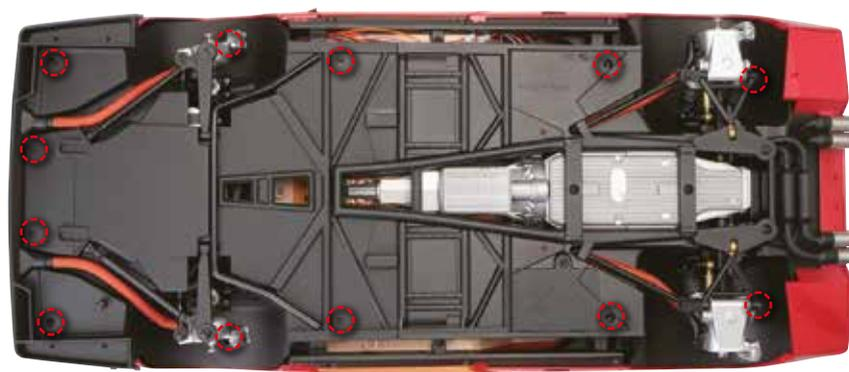
Vérifiez que les orifices cerclés du bas de la voiture et les orifices des saillants de la carrosserie principale sont alignés. S'il y en a qui ne le sont pas, séparez la carrosserie principale du bas de la voiture et réglez les deux pièces jusqu'à ce que tous les orifices soient alignés.
