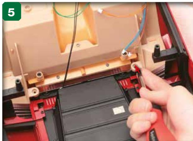
5 Introduisez une vis 2,6 x 6 mm (étape 64) dans l'orifice indiqué du sol de la cabine.
