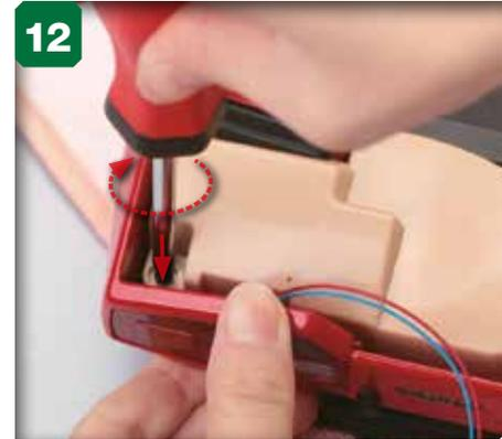
12 Serrez à moitié une vis 2,6 x 6 mm dans chacun des trois orifices restants, cerclés dans le pas 10. Une fois toutes les vis en place, serrez-les complètement.
