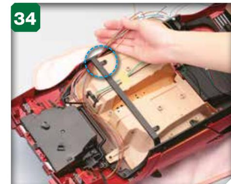
34 Rassemblez tous les câbles de l'extrémité avant de l'assemblage et passez-les sous le châssis (cerclé).
