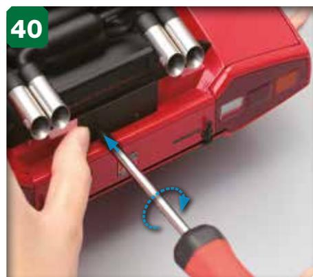
40 Serrez une deuxième vis autoforeuse 2 x 5 mm dans l'autre orifice de la base et serrez ensuite complètement la première vis.
