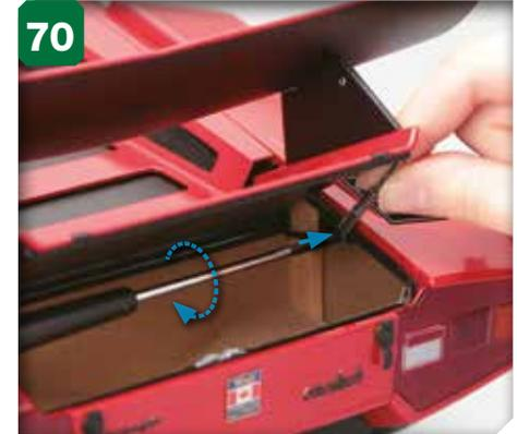
Serrez une vis autoforeuse 1,7 x 4 mm dans l'orifice. Le support doit pouvoir tourner légèrement, faites donc en sorte de laisser un demi tour à la vis.
