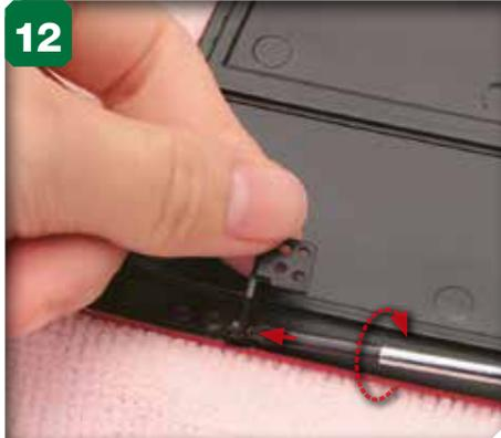
12 Serrez la vis 1,4 x 3 mm dans l'orifice afin de fixer la charnière G sur le capot.
