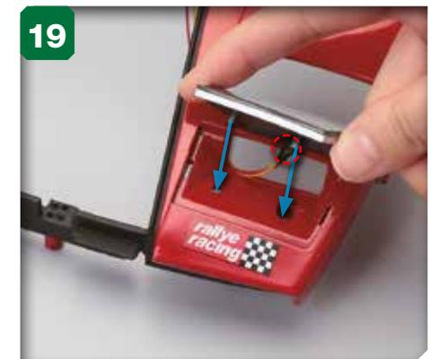
19 Alignez les saillants de l'arrière du phare et les orifices du garde-boue avant. Veillez à bien passer le câble afin qu'il ne gêne pas lors de l'assemblage du phare lors du pas 20.
