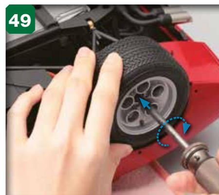
49 Serrez l'essieu arrière une fois en place, jusqu'à ce que la roue tienne fermement tout en pouvant tourner.
