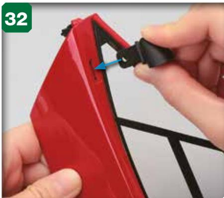
32 Alignez la languette se trouvant sous le rétroviseur gauche (étape 74) et la rainure à l'extérieur de la portière.
