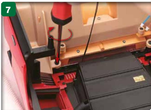
7 Serrez à moitié une deuxième vis 2,6 x 6 mm (étape 64) dans l'autre orifice du sol de la cabine. Serrez ensuite complètement les deux vis.
