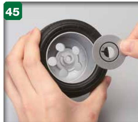
45 Retirez le disque de frein de l'une des roues arrière (étapes 38 et 40).
