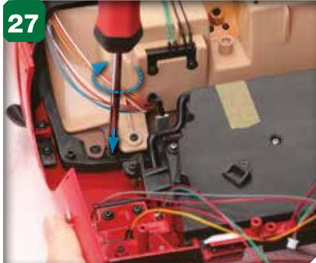
27 Serrez une autre vis 2,6 x 6 mm dans l'orifice indiqué sur le côté droit du châssis.
