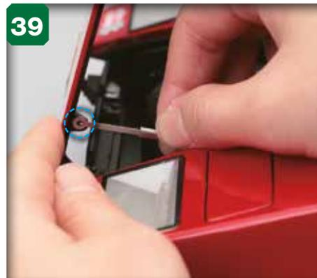
**39** Tendez le support du capot et alignez l'orifice à l'extrémité et celui qui est cerclé sur le capot.
