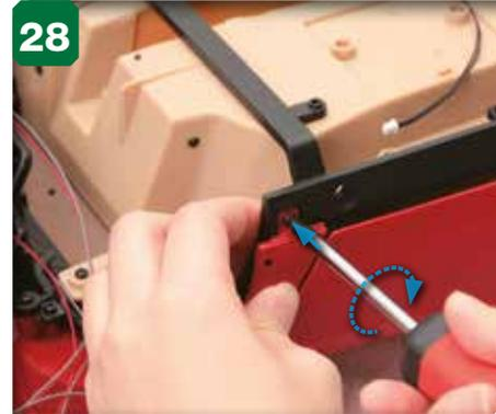
28 Serrez une vis 2,6 x 6 mm (étape 78) dans l'orifice de la languette sous le garde-boue.
