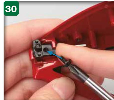
30 Introduisez une vis à rondelle 2,6 x 5 mm (étape 74) dans l'orifice du support.
