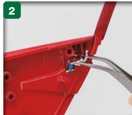
2 Alignez la partie inférieure de la serrure et la partie inférieure du creux de la portière (flèche).
