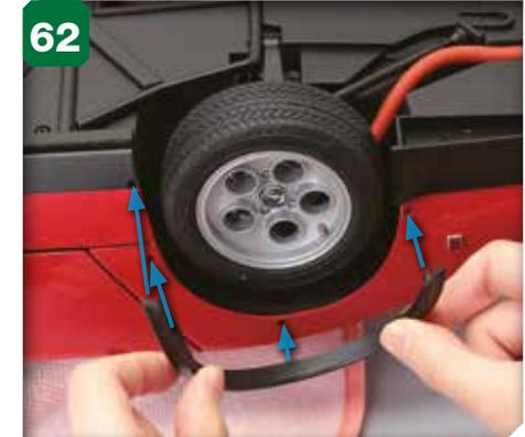
62 Alignez les quatre saillants à l'intérieur du garde-boue avant gauche et les quatre orifices de la protection de la jante avant gauche.
