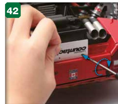
42 Placez la plaque d'immatriculation sur le support, comme sur l'image, en alignant les orifices des deux pièces. Serrez une vis autoforeuse 1,4 x 3 mm dans l'un des orifices.
