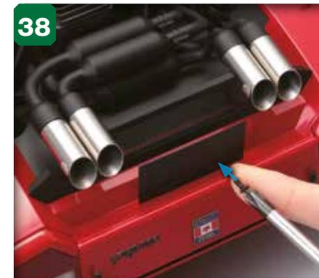
38 Introduisez une vis autoforeuse 2 x 5 mm dans l'un des orifices du support.
