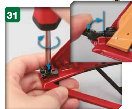
31 Serrez la vis une fois en place. Vérifiez ensuite que la charnière peut tourner à 90° (agrandissement). Si ce n'est pas le cas, desserrez légèrement la vis autant que nécessaire pour obtenir cet angle.
