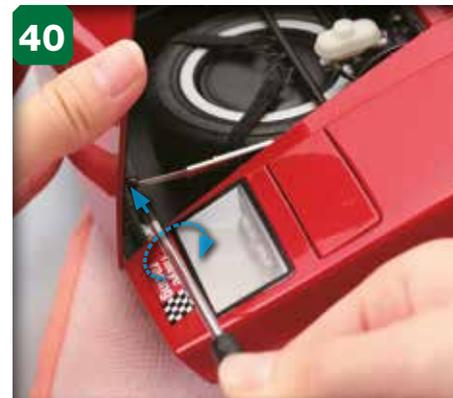
**40** Serrez une vis à tête fraisée 1,7 x 4 mm (étape 63) dans l'alignement des orifices du capot et de l'extrémité du support. Ne serrez pas trop la vis car le capot pourrait ne pas fermer complètement.
