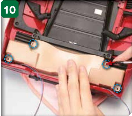
10 Préparez quatre vis 2,6 x 6 mm (trois de l'étape 64, une de l'étape 72) et introduisez une vis dans l'orifice indiqué par la flèche rouge.
