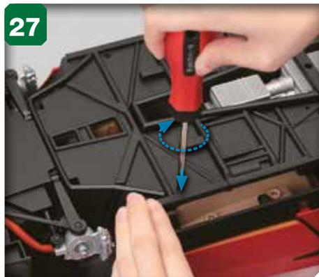
27 Serrez à moitié une vis 2,6 x 6 mm dans l'orifice indiqué du bas de la voiture.
