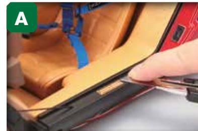
**A** Repérez la plaque sur le côté gauche du châssis et passez l'extrémité affûtée d'un cutter sous l'une des deux extrémités. Passez la lame sous le plaque afin de l'extraire du châssis. Veillez à ne pas écorcher la peinture du châssis durant l'opération.
