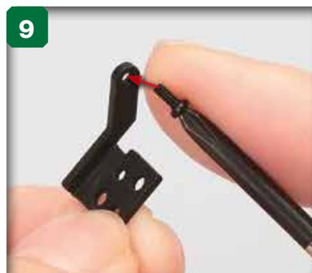
9 Introduisez l'extrémité d'une vis 1,4 x 3 mm (étape 72) dans l'orifice indiqué de la charnière et du capot.
