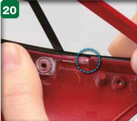
20 Vérifiez que le bord de la partie inférieure de la fenêtre est en contact avec la partie saillante à l'intérieur de la portière, comme sur l'image ci-dessus.
