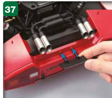
37 Assemblez les orifices du support de la plaque d'immatriculation sur les saillants indiqués.
