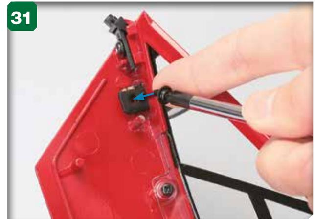
Retournez la portière et introduisez une vis à rondelle 2,6 x 5 mm (étape 74) dans l'orifice de la languette du rétroviseur.
