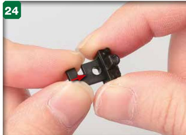
24 Passez l'extrémité du support dans la rainure de la charnière. Poussez jusqu'à atteindre la position montrée ci-dessus.
