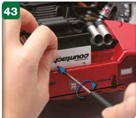
43 Serrez une deuxième vis autoforeuse 1,4 x 3 mm dans l'autre orifice.
