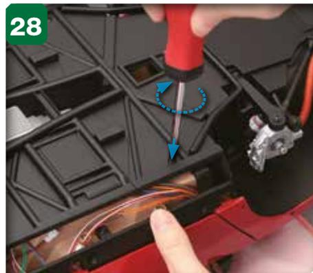
28 Serrez à moitié une vis 2,6 x 6 mm dans l'orifice du côté opposé du bas de la voiture. Serrez complètement les quatre vis des pas 25 à 27.
