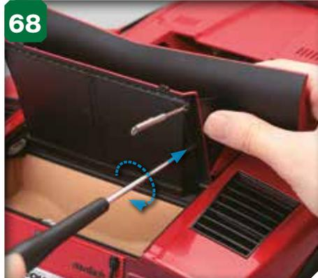
Serrez une deuxième vis autoforeuse 2 x 5 mm dans l'orifice du côté opposé du capot afin de fixer l'aileton arrière dans son emplacement définitif.
