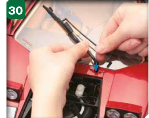
30 Introduisez le saillant le plus gros à la base de l'essuie-glace (étape 78) dans l'orifice le plus grand (flèche) du garde-boue avant.
