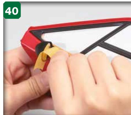
40 Déposez une bande de ruban cache sur la pellicule de protection du rétroviseur et retirez-la.
