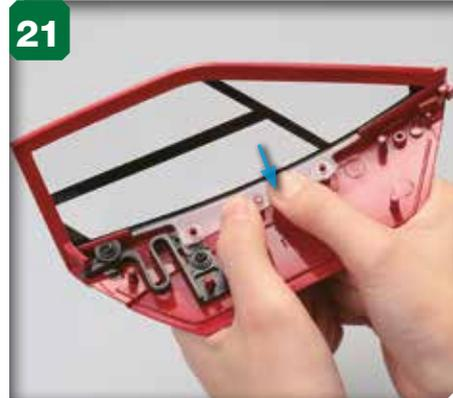
21 Appuyez légèrement vers le bas, le long de la partie inférieure de la fenêtre, afin de vous assurer que le saillant soit logé dans l'orifice central.
