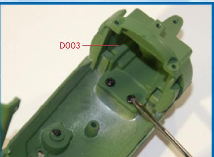
**10** Installez le mécanisme de rotation de l'antenne (D003) sur la structure extérieure de l'habitacle (D001) et fixez-le de l'intérieur avec deux vis MM.
