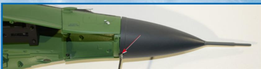
**6** Placez le radôme (D007) sur le scanner et le fuselage comme indiqué. Fixez-le par le bas à l'aide d'une vis DM.
