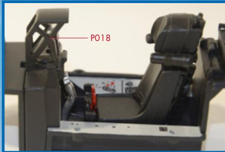
**4** Placez le tableau de bord dans l'encoche située devant la barre de commande, puis fixez-le par le bas avec deux vis AR.
