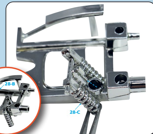
Step 28-5 ペダルロッド (28-C) をアクセルペダル (28-B) の写真の位置に取り付ける。FP05ネジで裏側から固定する。
