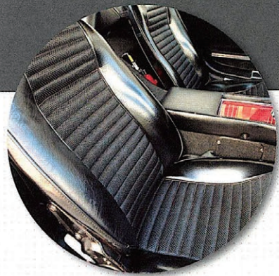
④助手席シート(2)を用意し、その左側面の穴へ⑤シートレバー(左)を写真の向きでセットする。
