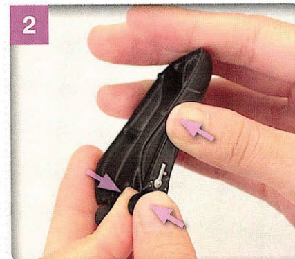
バックレストレバーと助手席バックレストの縁を挟むようにして持ち、そのまま真っすぐに押し込む。
