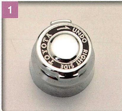
① 右フロント用ハブナットを拡大してみた。内側に記されたローテーションマークや文字までも正確に再現されていることが分かる。
