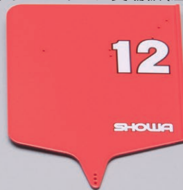
③ リアウイング翼端板(左) ABS製
