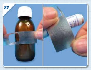
Utilisez des objets cylindriques de plusieurs diamètres pour recourber progressivement le revêtement et lui faire adopter la forme adéquate avant de l'installer sur l'avion.
