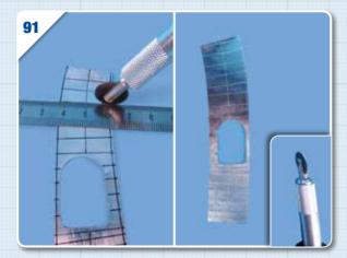
Passez sur les lignes de l'étape précédente avec une roulette dentée pour marquer les rivets du fuselage. Les marques de ces lignes sur la partie externe de la pièce sont visibles sur la photo de droite.
